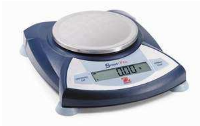
Slika 7.6. Vaga (Scout Pro) za mjerenje mase prekursora
