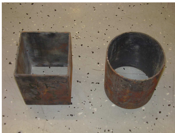
Slika 7.1. Čelične cijevi koje služe kao kalupi za izradu uzoraka
