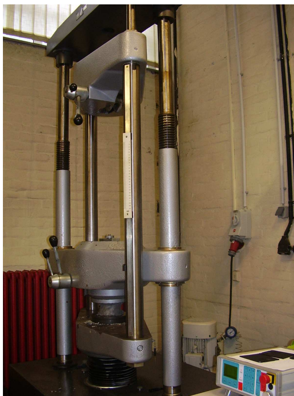
Slika 7.15. Kidalica (WPM, EU 40 mod) na kojoj je izvršeno ispitivanje
