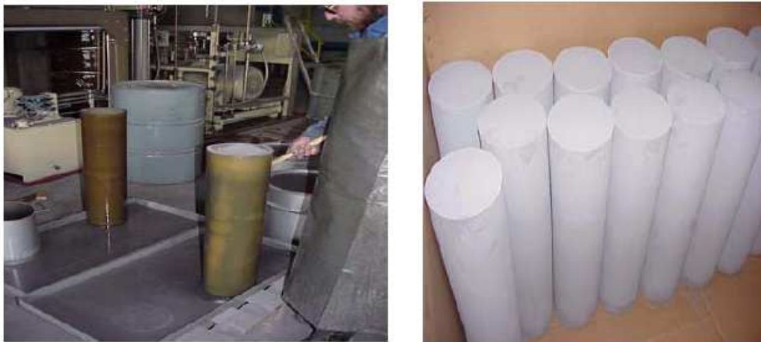
Slika 2.6. Stvaranje trupaca izostatičkim prešanjem (100 MPa) mješavine prahova /7/
