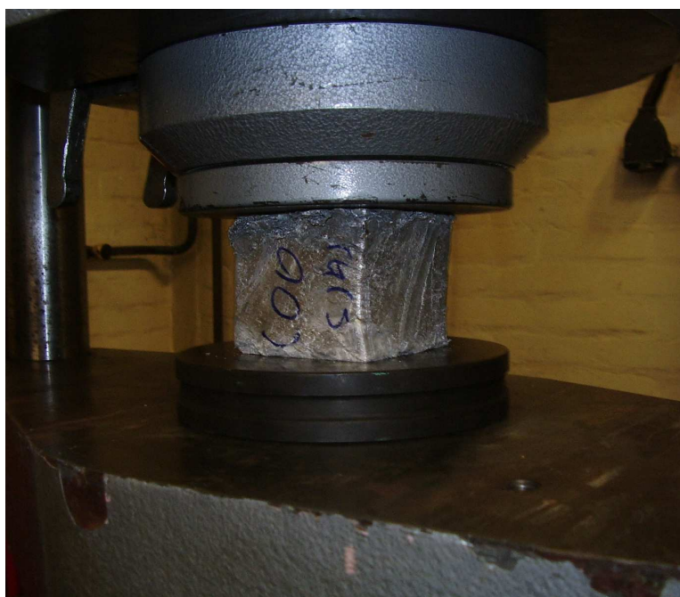
Slika 7.17. Kvadratni uzorak za vrijeme ispitivanja
