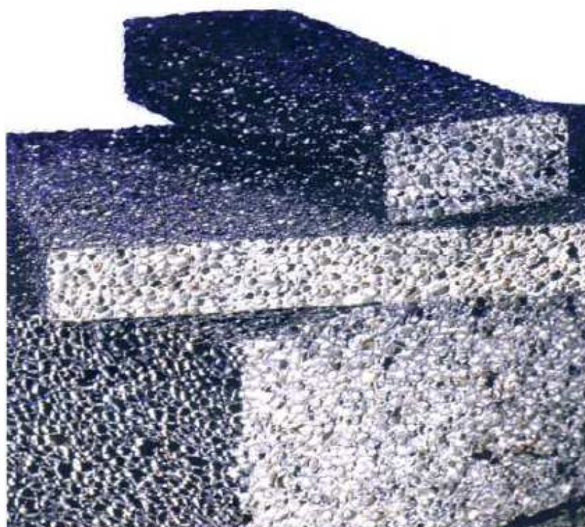
Slika 2.3. Ploče izrezane iz većeg bloka metalne pjene nastalog postupkom plinom oslobođenih čestica rastvorenih u taljevini /7/
