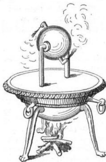
Slika 1-3. Heronova parna turbina [3]
