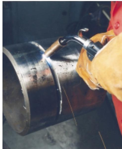
Slika 4.1 Primjer otvorenog korijena cijevi zavarenog STT postupkom, lijevo i sam postupak zavarivanja cijevi STT postupkom, desno [8]
