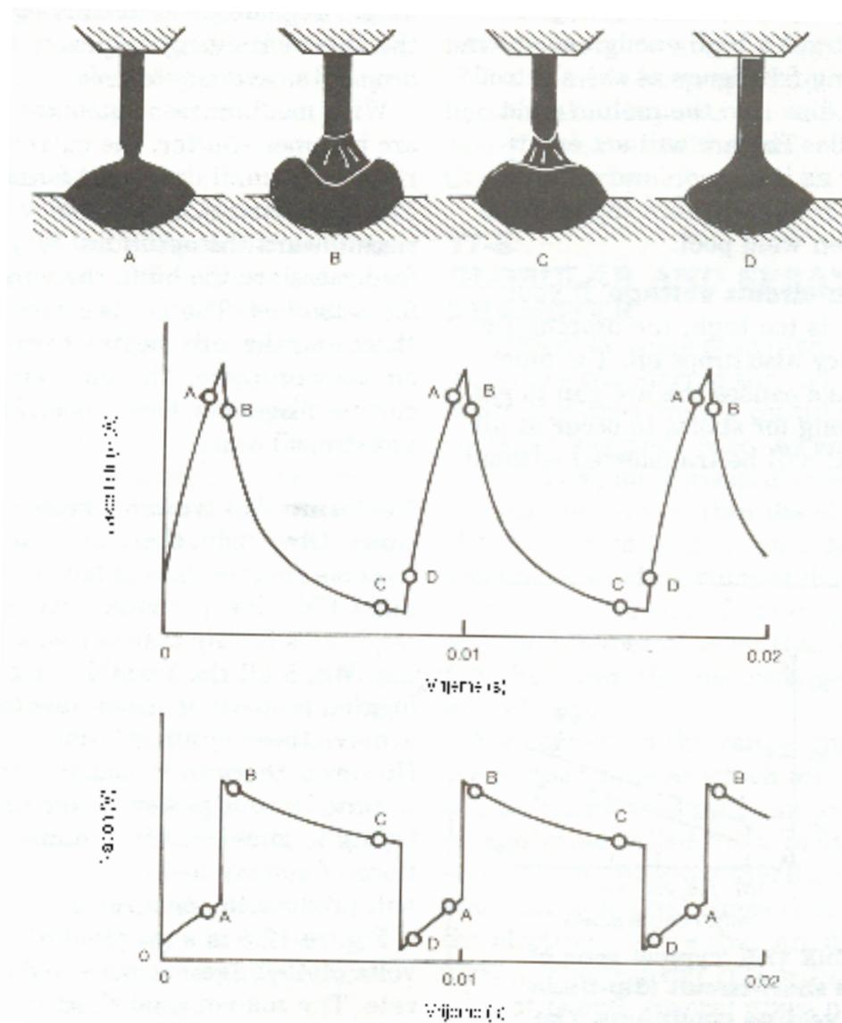
Slika 1.2 Prijenos metala kratkim spojevima kod MAG zavarivanja [1]
