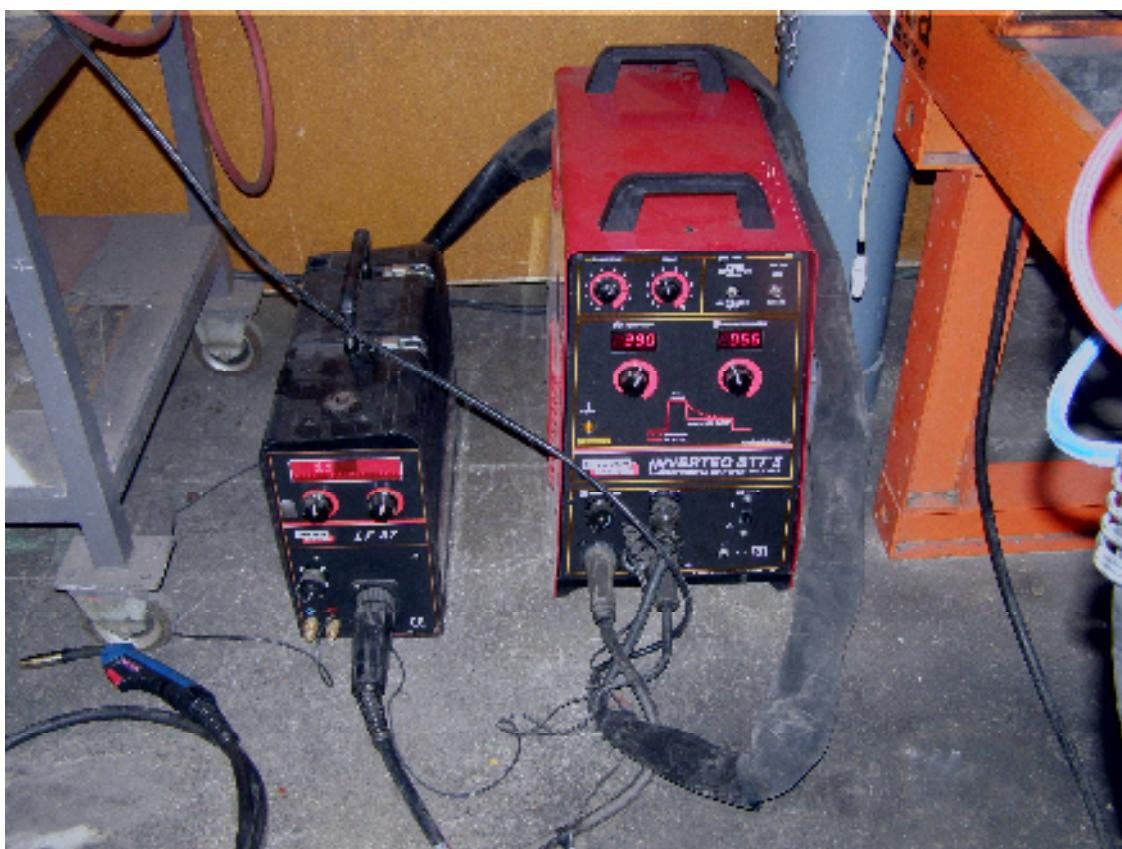
Slika 5.1 Uredaj za MAG-STT zavarivanje LINCOLN ELECTRIC STT II desno i dodavač žice LF 37 lijevo
