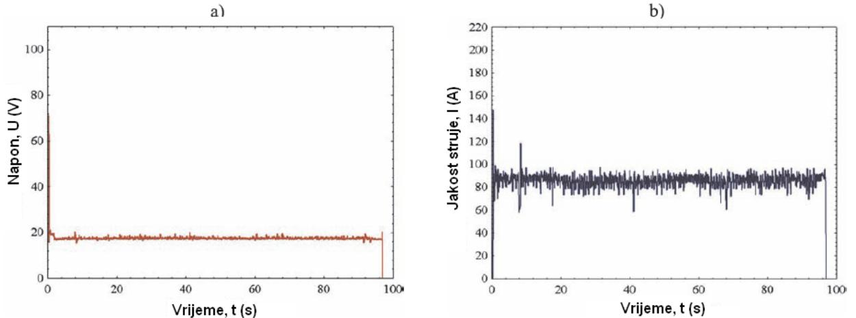
Slika 3.4. Primjena on-line monitoring sustava za praćenje glavnih parametara kod MAG-STT zavarivanja; napona (a) i struje (b) [9]
