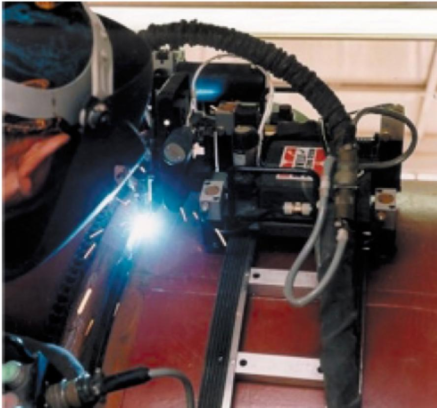
Slika 4.2 STT postupak zavarivanja u automatskom sustavu [8]
