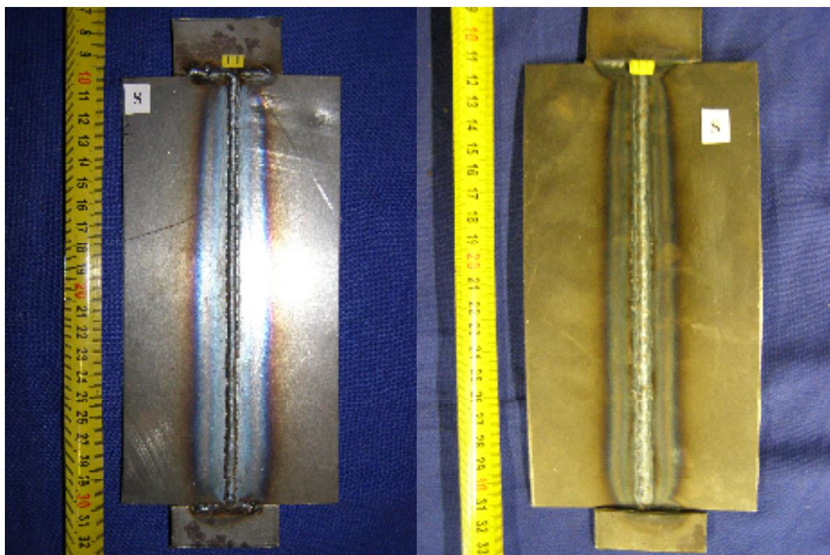
Slika 5.5 Limovi zavareni MAG-STT postupkom
