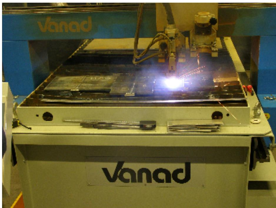
Slika 5.4 Rezanje makroizbrusaka plazma rezačicom
