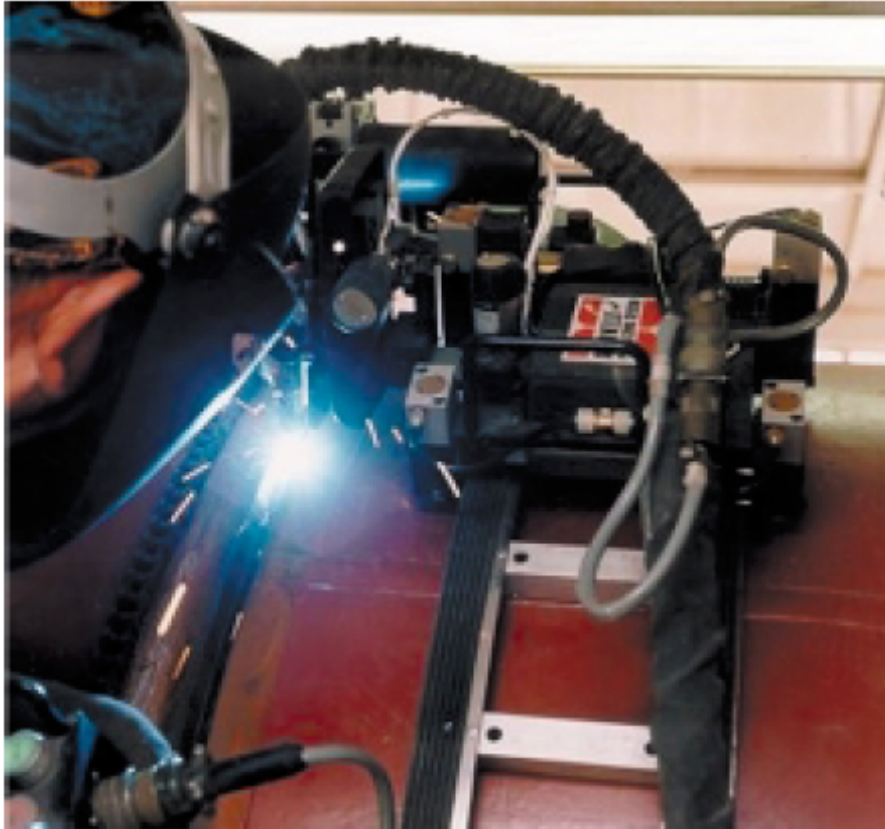
Slika 4.2 STT postupak zavarivanja u automatskom sustavu [8]
