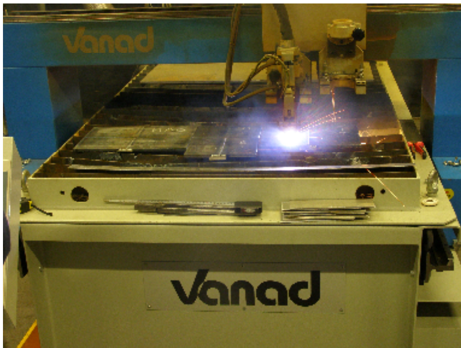
Slika 5.4 Rezanje makroizbrusaka plazma rezačicom
