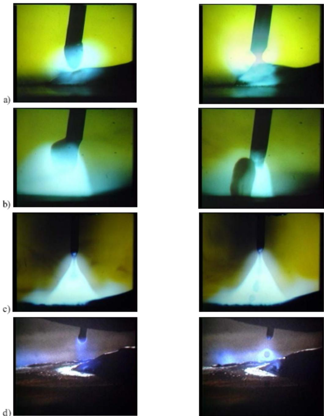
Slika 1.3 Temeljni načini prijenosa metala kod MAG postupka zavarivanja [2]
