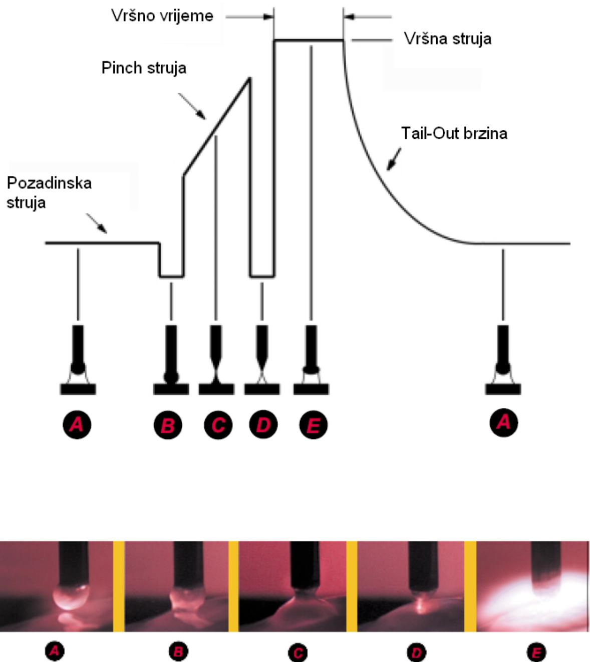
Slika 3.6 Grafički prikaz STT postupka zavarivanja [10]
