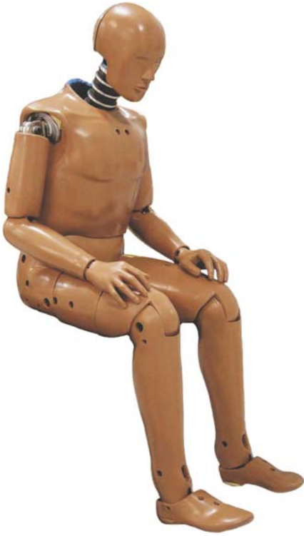
Slika 8. Model lutke za ispitivanje [20].
