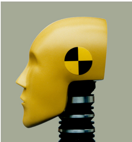
Slika 9. Mehanički modeli vrata i glave - Hybrid HI [20].
