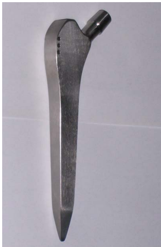
Slika 25. Endoproteza Müller izrađena rezanjem iz ploče iz slitine Ti_6 Al_4V
