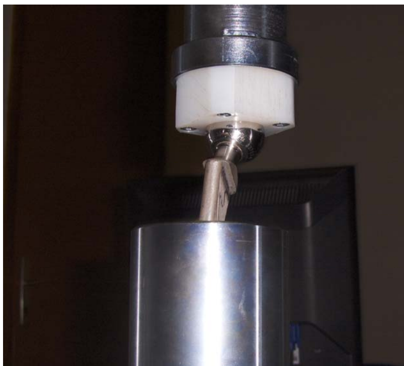
Slika 36.(B) Nalijeganje konektora na glavu endoproteze
