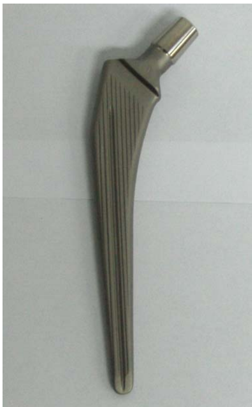
Slika 22. Endoproteza Müller izrađena iz slitine CoCrMo
