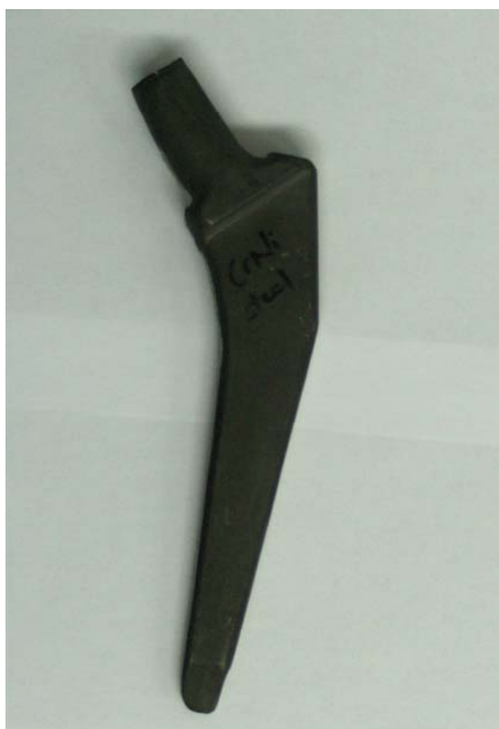
Slika 23. Endoproteza Müller izrađena iz nehrđajućeg (CrNi) čelika
