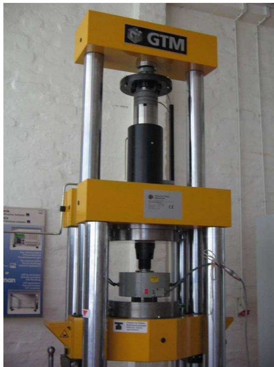
Slika 14: Umjeravanje referentnog etalona LIMS – a s posredničkim etalom Z4 500 kN
