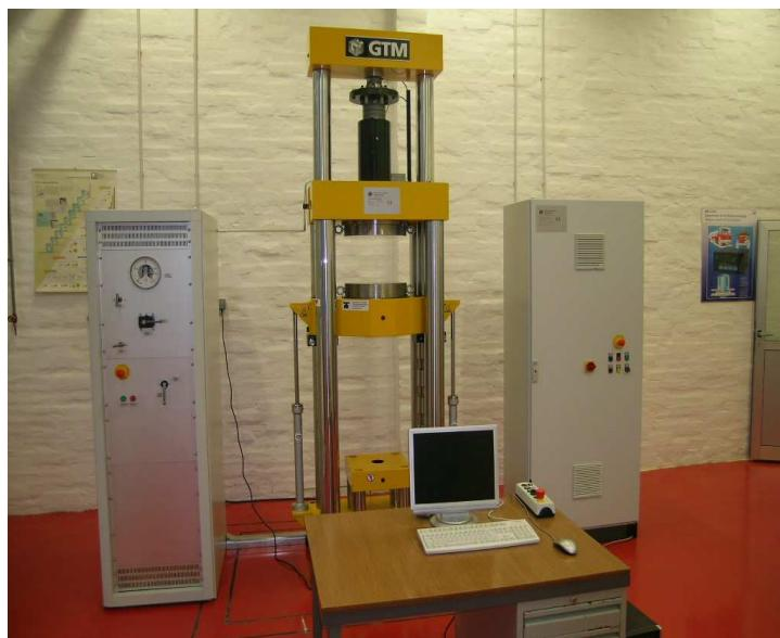
Slika 12: Referentni etalon sile u LIMS – a [5]
