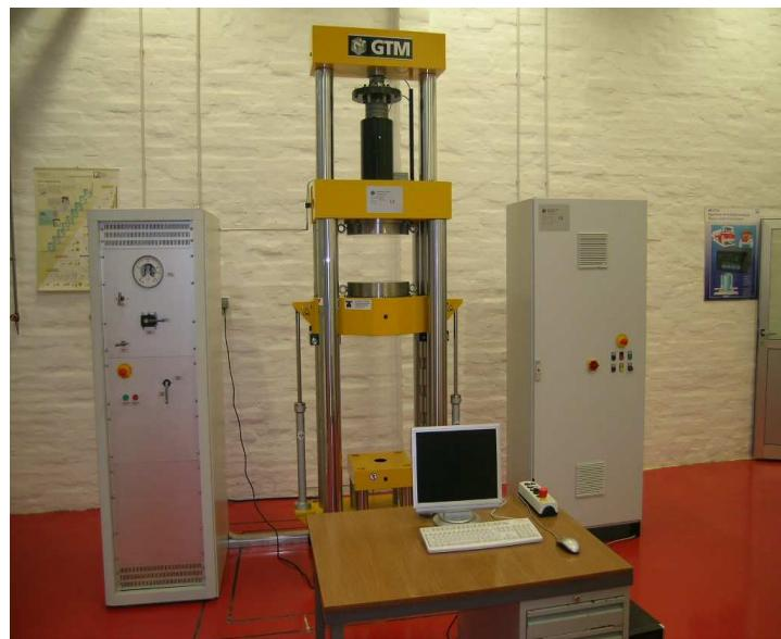
*Slika 8: Referentni etalon sile komparatoričnog tipa nazivne sile 500 kN proizvođača GTM smješten u LIMS – u [5]*
