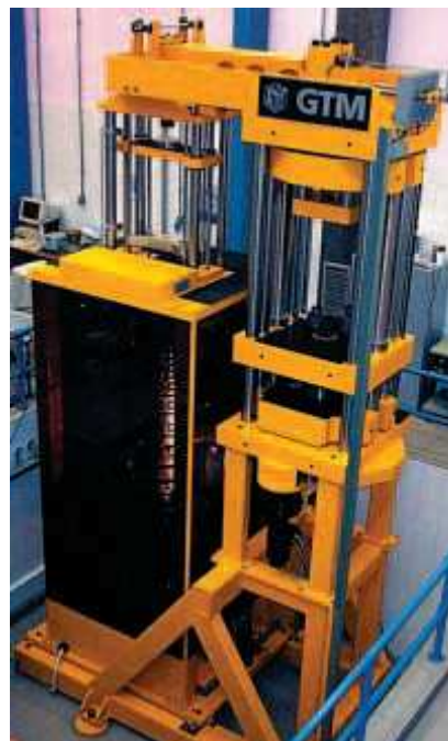
Slika 6: Referentni etalon sile s polužnim mehanizmom opterećenja proizvođača GTM smješten u EIM – u (Grčka) [8]
