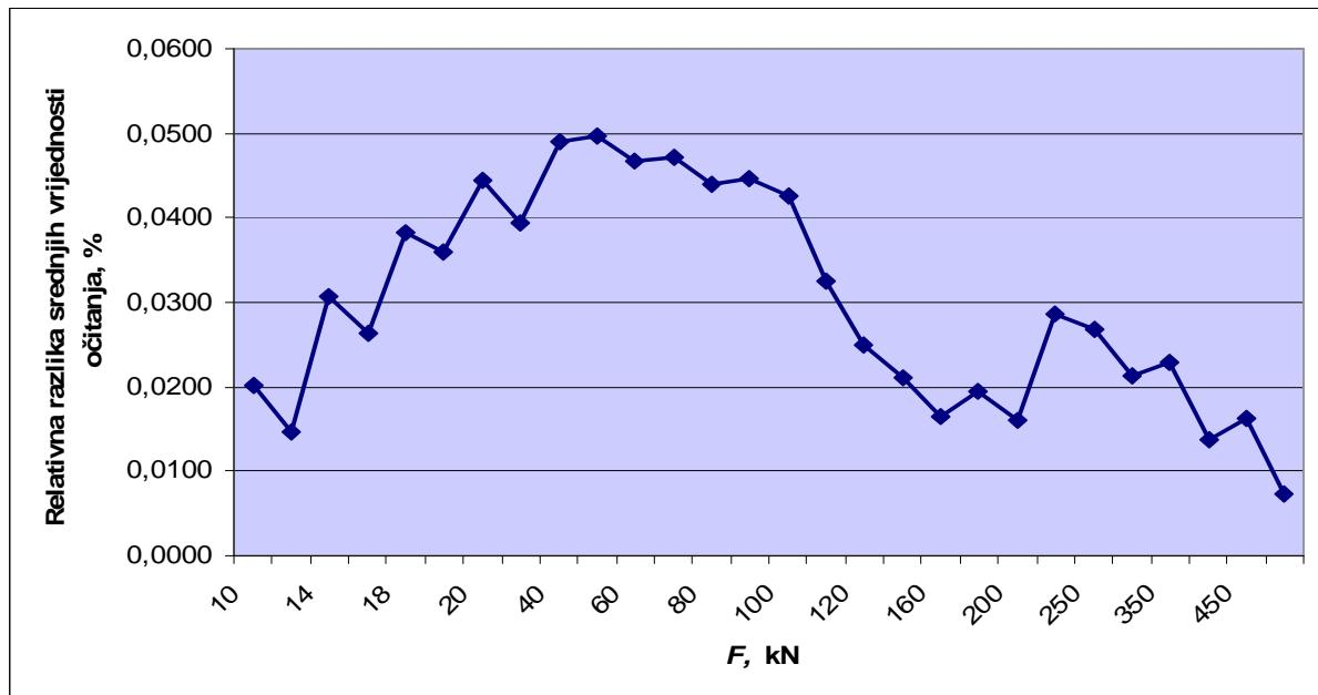
Slika 16: Relativna razlika srednjih vrijednosti očitanja PTB – a i LIMS – a za mjerno područje od 10 kN do 500 kN
