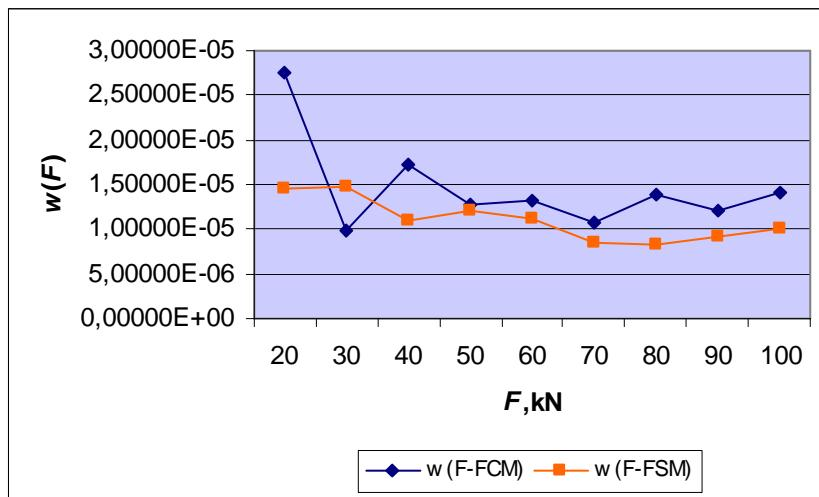
Slika 23: Usporedni prikaz relativne nesigurnosti ponovljivosti mjerena s rotacijom za mjerno područje od 20 do 100 kN
