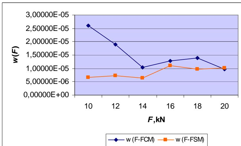
Slika 22: Usporedni prikaz relativne nesigurnosti ponovljivosti mjerena s rotacijom za mjerno područje od 10 do 20 kN
