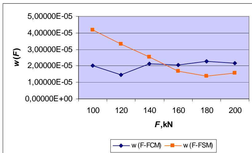
Slika 24: Usporedni prikaz relativne nesigurnosti ponovljivosti mjerena s rotacijom za mjerno područje od 100 do 200 kN
