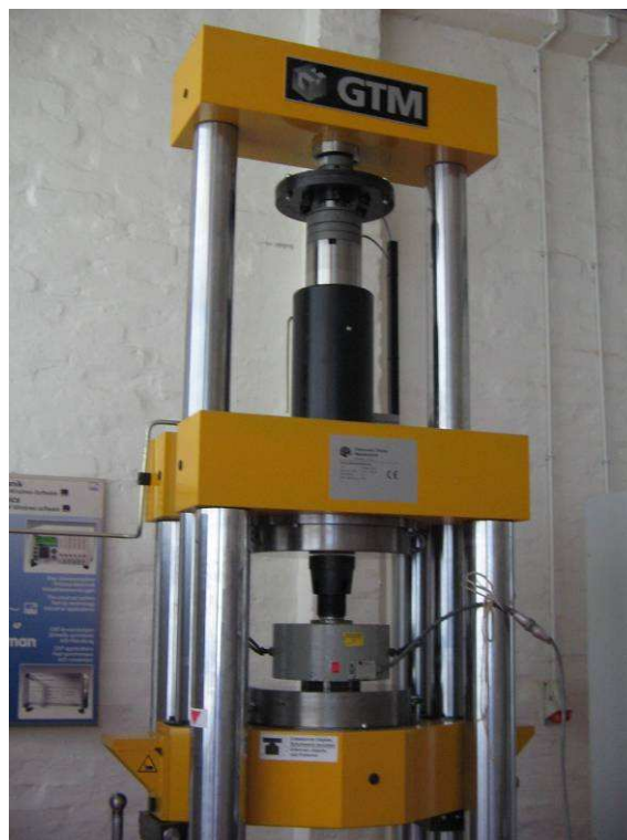
Slika 14: Umjeravanje referentnog etalona LIMS – a s posredničkim etalomom Z4 500 kN
