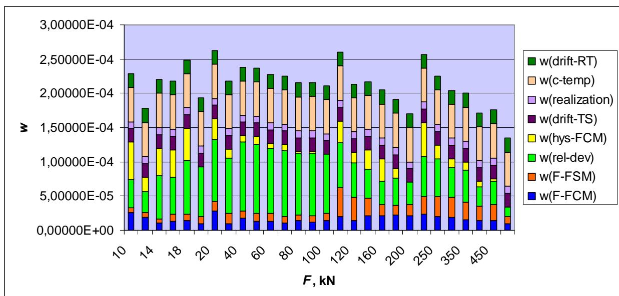
Slika 32: Značaj pojedinih mjerneih nesigurnosti u kombiniranoj relativnoj nesigurnosti referentnog etalona LIMS - a
