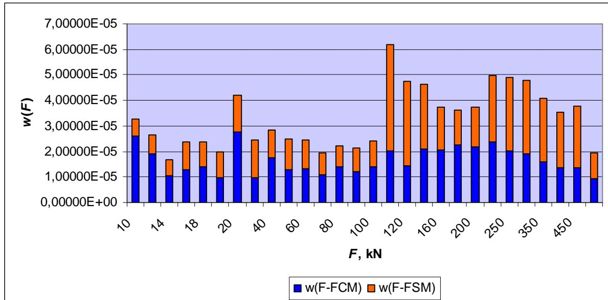
Slika 26: Prikaz udjela relativne nesigurnosti ponovljivosti mjerena referentnog etalona LIMS – a i nacionalnog etalona PTB – a
