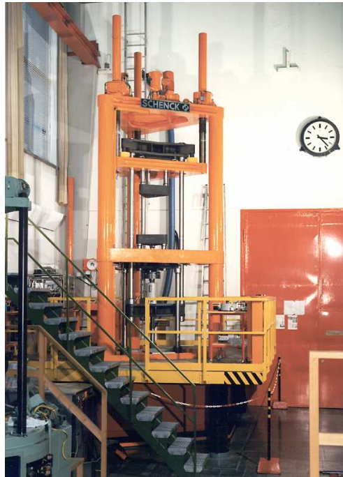
Slika 4: Primarni nacionalni etalon sile u PTB – u nazivne sile 1 MN [7]
