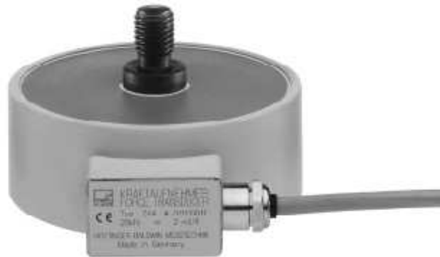
Slika 9: Posrednički etalon sile tipa Z4A nazivne sile 20 kN proizvođača HBM [9]
