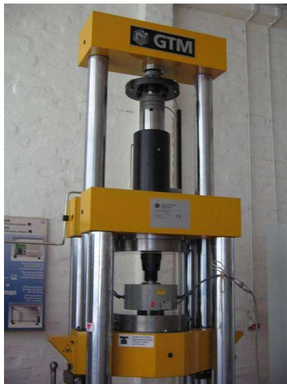
*Slika 14: Umjeravanje referentnog etalona LIMS – a s posredničkim etalonom Z4 500 kN*
