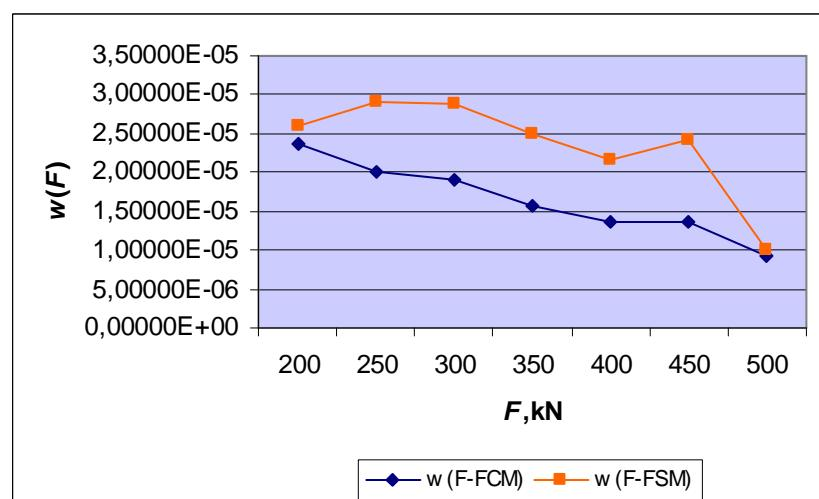
Slika 25: Usporedni prikaz relativne nesigurnosti ponovljivosti mjerena s rotacijom za mjerno područje od 200 do 500 kN
