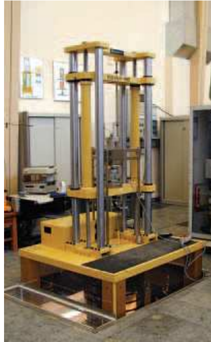
Slika 5: Referentni etalon sile s direktnim opterećenjem utezima nazivne sile 100 kN proizvođača GTM smješten u PTB – u [8]
