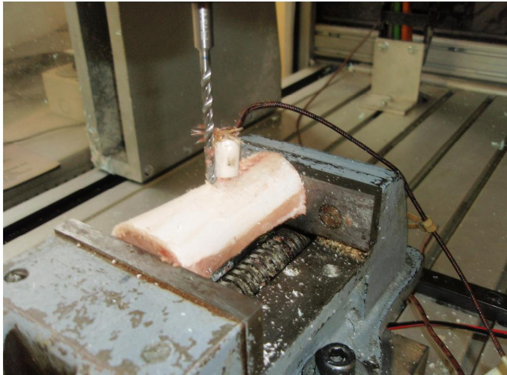
Slika 64. Prikaz termopara za mjerjenje temperature u kosti prilikom eksperimenta
