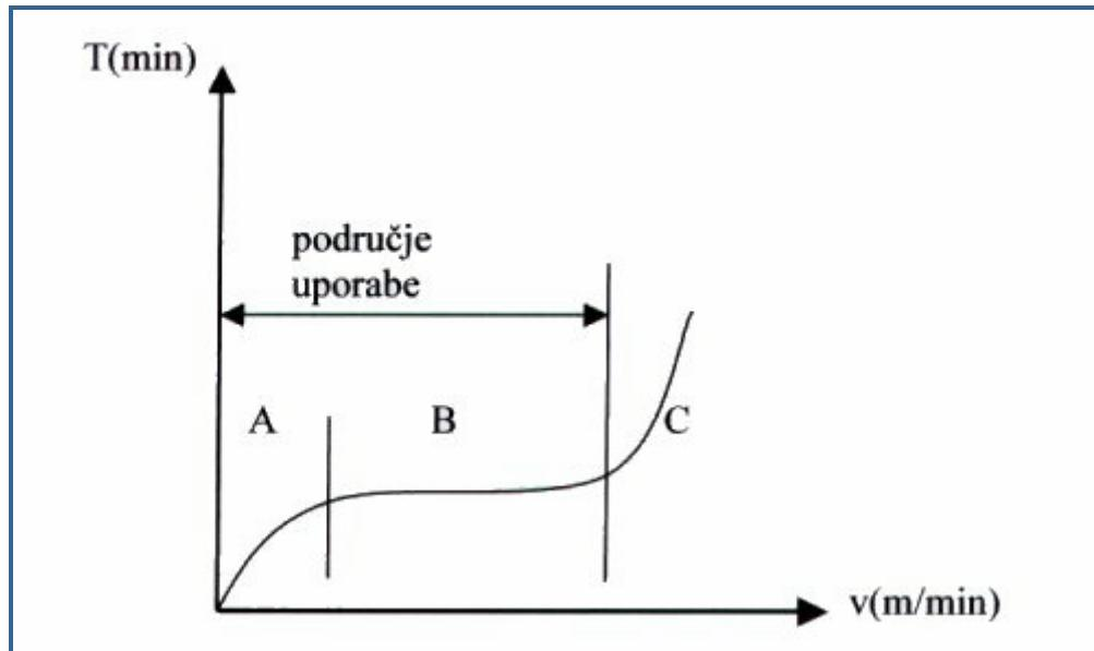
A - početak trošenja alata
