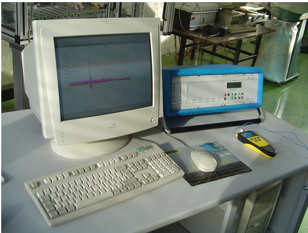
Slika 42. Uređaj za mjerenje sile Kistler [28]
