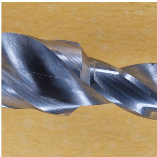
Slika 85. Oštrica drugog stupnja dvostupnjevanog spiralnog svrdla promjera 3,4-4,5 mm prije mjerenja
