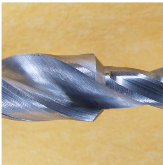
Slika 82. Oštrica drugog stupnja dvostupnjevanog spiralnog svrdla promjera 2,5-3,4 mm prije mjerena
