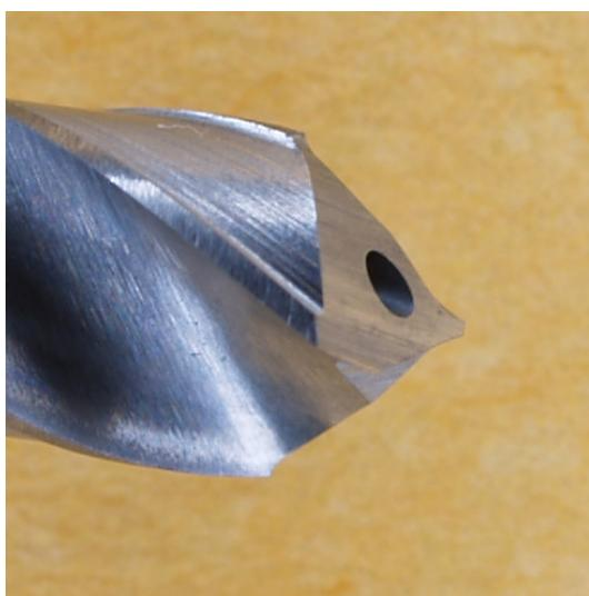
Slika 75. Oštrica klasičnog spiralnog svrdla promjera 3,4 mm prije mjerena
