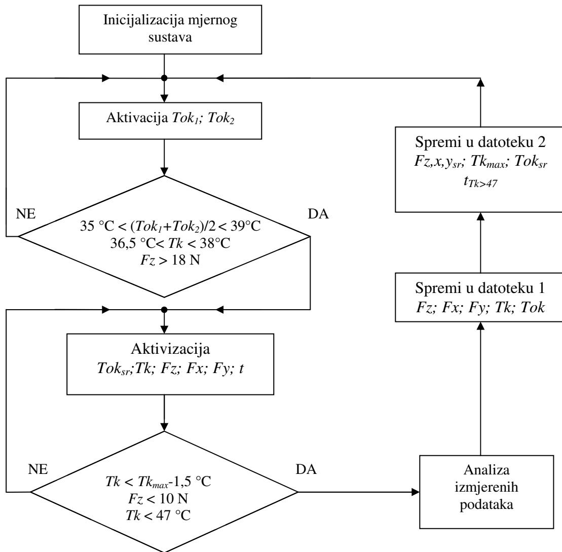
Slika 58. Pojednostavljen dijagram toka programske podrške mjernog postava
