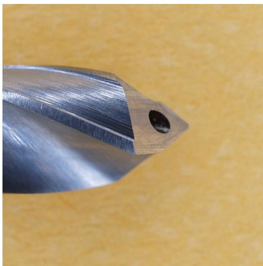
Slika 77. Oštrica klasičnog spiralnog svrdla promjera 4,5 mm prije mjerena
