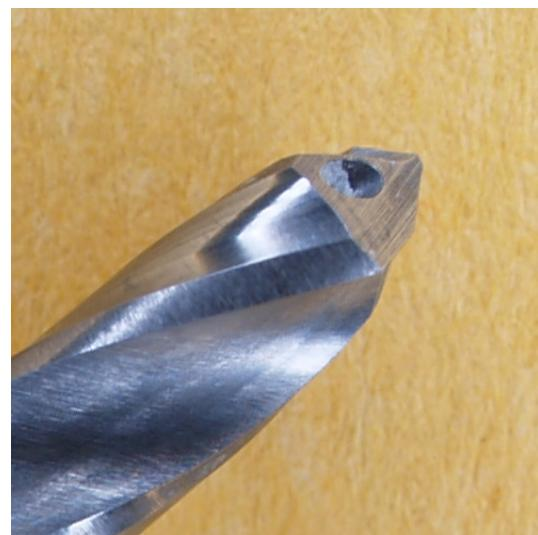
Slika 80. Oštrica prvog stupnja dvostupnjevanog spiralnog svrdla promjera 2,5-3,4 mm nakon 360 mjerena
