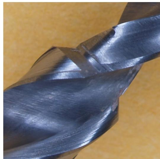
Slika 86. Oštrica drugog stupnja dvostupnjevanog spiralnog svrdla promjera 3,4-4,5 mm nakon 360 mjerena
