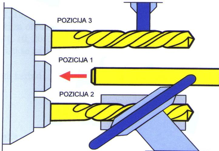
Slika 8. Izrada svrdla brušenjem [4]
