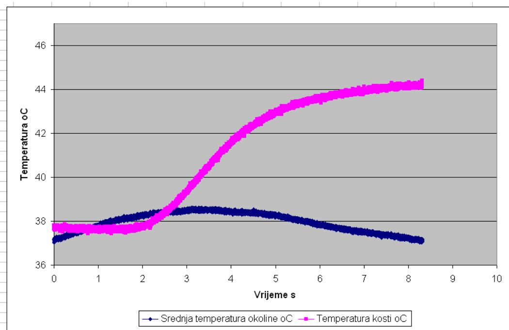
Slika 88. Prikaz temperature u ovisnosti o vremenu za klasično spiralno svrdlo promjera 3,4 mm pri parametrima obrade iznosa:  $v_c = 42,72 \text{ m/min}$ ,
