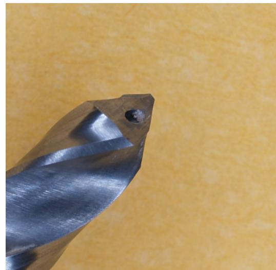
Slika 84. Oštrica prvog stupnja dvostupnjevanog spiralnog svrdla promjera 3,4-4,5 mm nakon 360 mjerena
