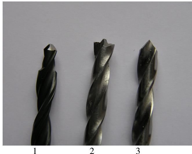
Slika 39. Svrđla kojima su izvedeni pokusi: 1-dvostupnjevano, 2-svrđlo za bušenje drva, 3-klasično kirurško svrđlo s vršnjim kutem  $80^\circ$  [27]
