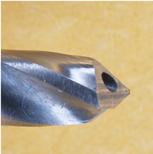
Slika 79. Oštrica prvog stupnja dvostupnjevanog spiralnog svrdla promjera 2,5-3,4 mm prije mjerenja
