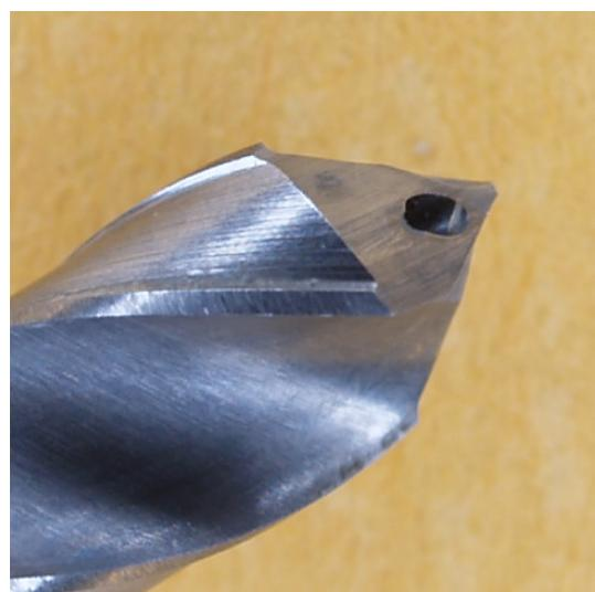
Slika 76. Slika klasičnog spiralnog svrdla promjera 3,4 mm nakon 360 mjerena
