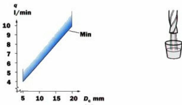
Slika 22. Ovisnost protoka SHIP-a o promjeru svrdla [4]
