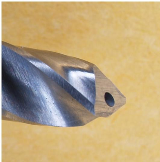
Slika 83. Oštrica prvog stupnja dvostupnjevanog spiralnog svrdla promjera 3,4-4,5 mm prije mjerena
