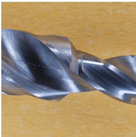
Slika 85. Oštrica drugog stupnja dvostupnjevanog spiralnog svrdla promjera 3,4-4,5 mm prije mjerena
