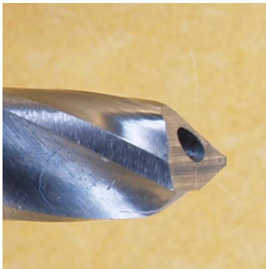
Slika 79. Oštrica prvog stupnja dvostupnjevanog spiralnog svrdla promjera 2,5-3,4 mm prije mjerena
