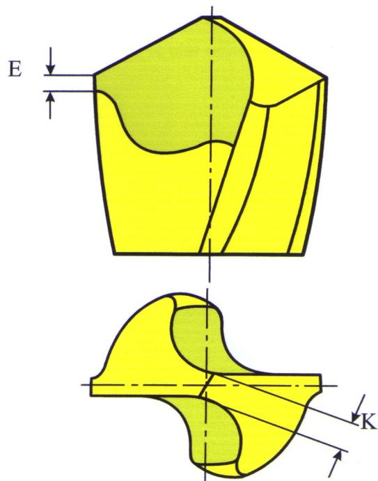
Slika 10. Podjela svrdla prema geometriji oštrice [4]
