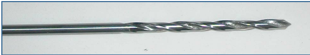
Slika 25. Standardna svrdla u kirurgiji [12]
