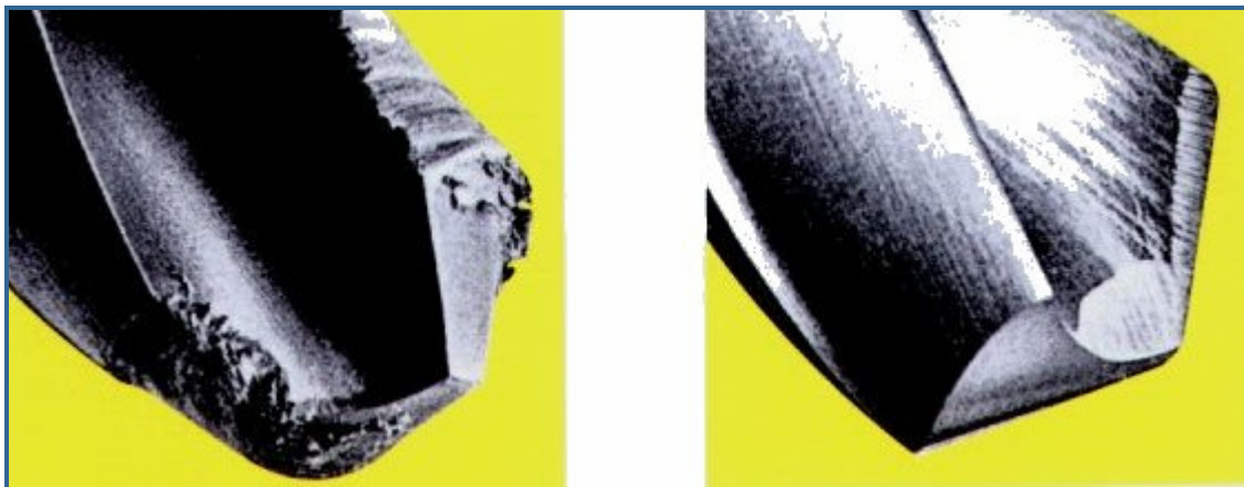
Slika 20. Oblici istrošenja svrdla [8]
