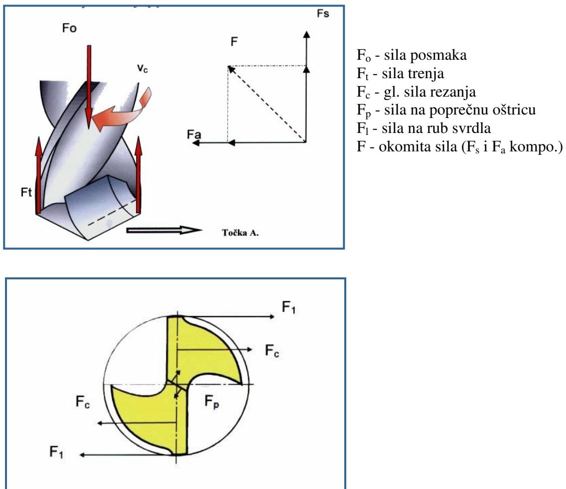
Slika 24. Sile rezanja kod bušenja [11]
