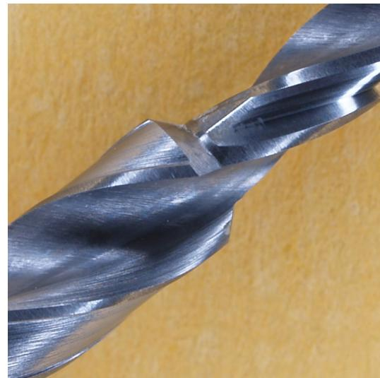
Slika 82. Oštrica drugog stupnja dvostupnjevanog spiralnog svrdla promjera 2,5-3,4 mm nakon 360 mjerena
