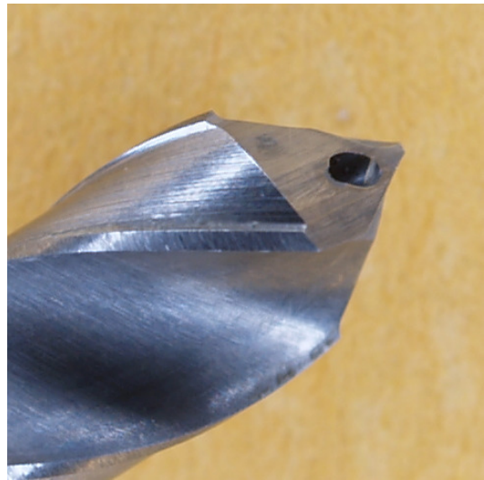
Slika 76. Slika klasičnog spiralnog svrdla promjera 3,4 mm nakon 360 mjerenja
