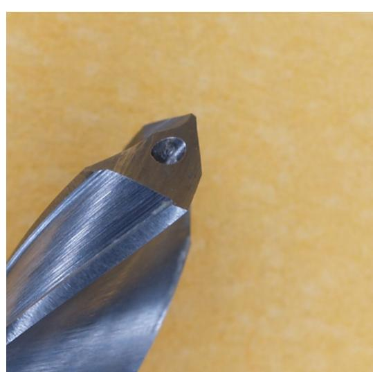
Slika 78. Slika klasičnog spiralnog svrdla promjera 4,5 mm nakon 360 mjerena
