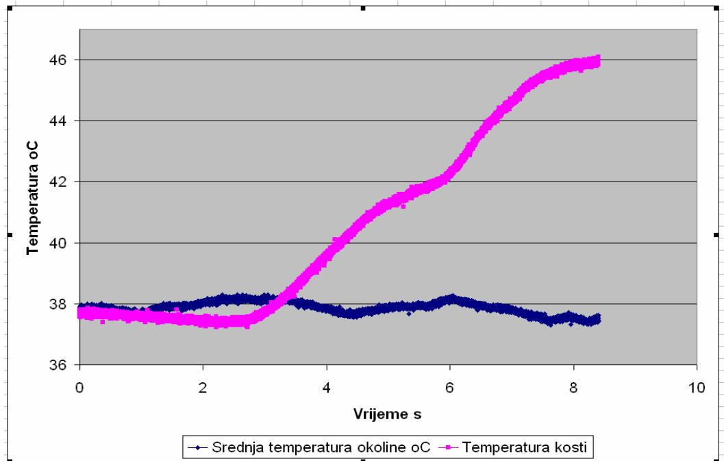
Slika 89. Prikaz temperature u ovisnosti o vremenu za dvostupnjevano spiralno svrdlo promjera 2,5-3,4 mm pri parametrima obrade iznosa:  $v_c = 42,72 \text{ m/min}$ ,
