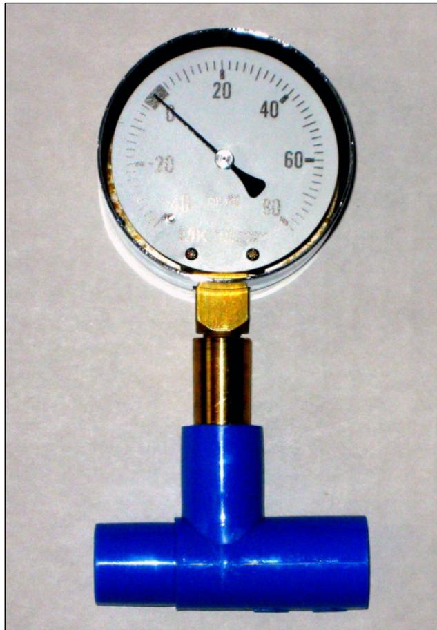
*Slika 3.11 – Analogni manometar*
