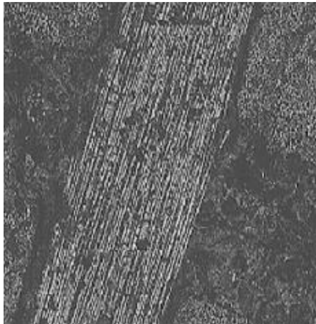
Slika 3 - Prikaz kompozita s ugljičnom matricom i ugljičnim ojačalom [1]
