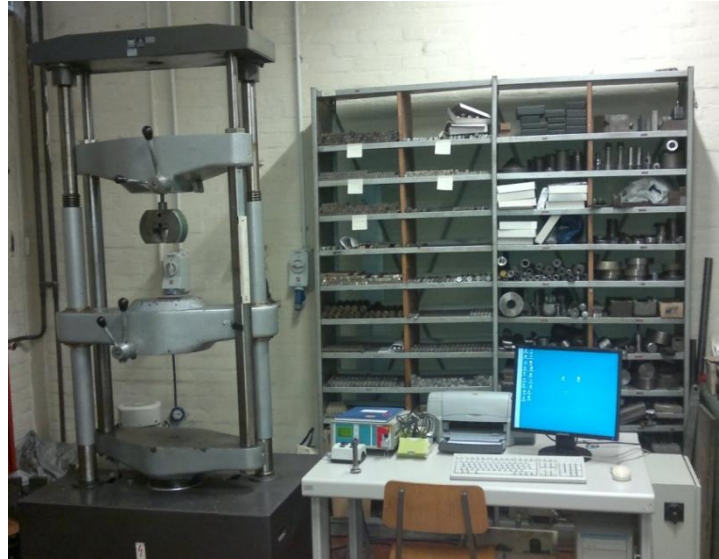
Slika 34 - Uređaj za statičko-vlačno ispitivanje (WPM - EU 40)
