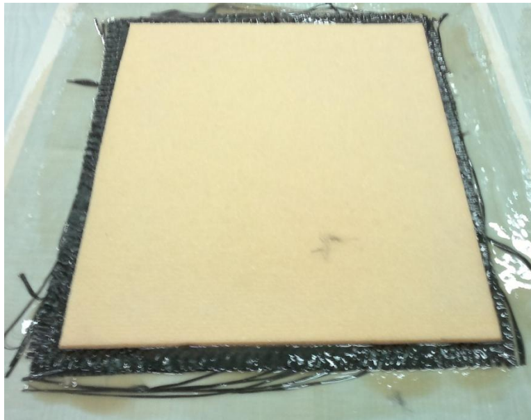
Slika 14 – Izrada sendvič konstrukcije
