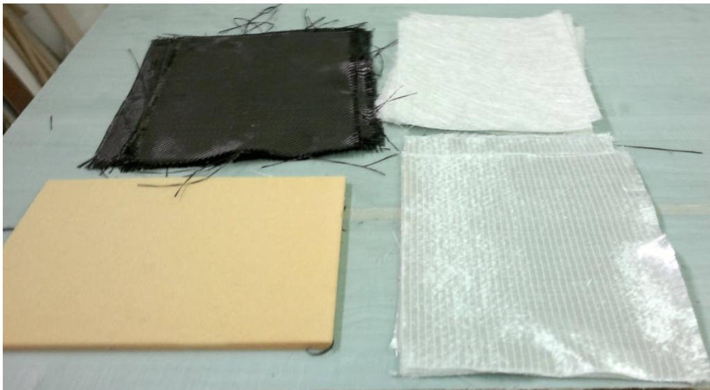
Slika 12 – Materijal potreban za izradu uzoraka
