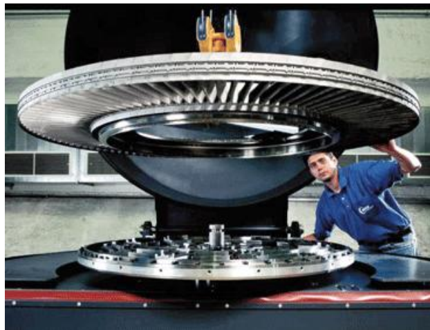
Slika 4.18. Jedan stupanj visokotlačne turbine
