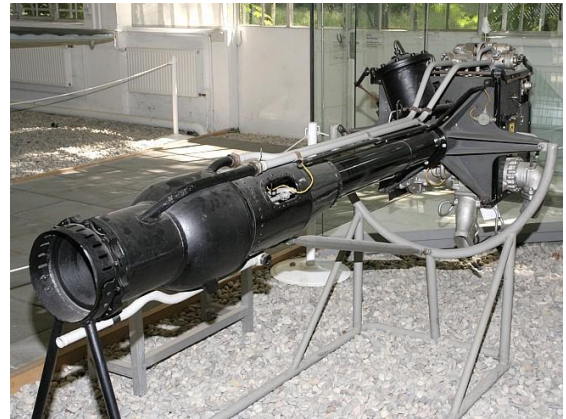
Slika 1.9. Messerschmitt Me 163 Komet i njegov motor na raketni pogon HWK 109-509A [5]
