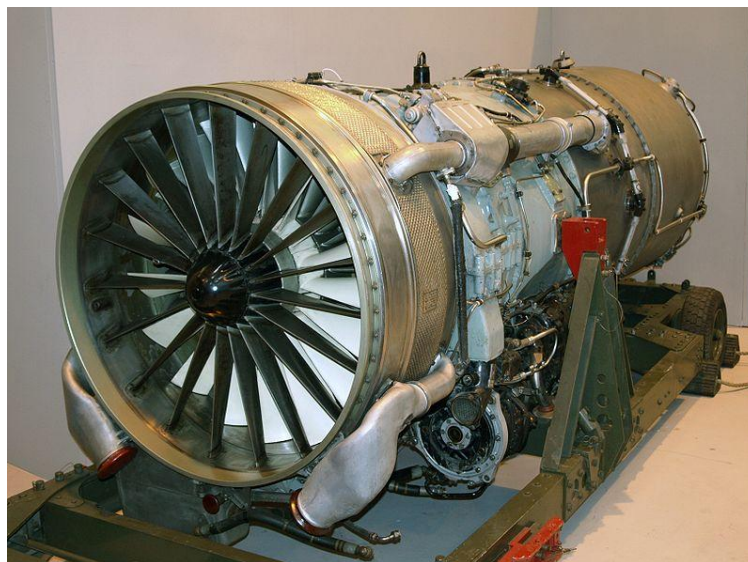
Slika 1.11. Prvi turbo-ventilatorski motor, Rolls-Royce Conway, bio je dugačak 3.409 metra uz promjer od 0.96 metara [5]
