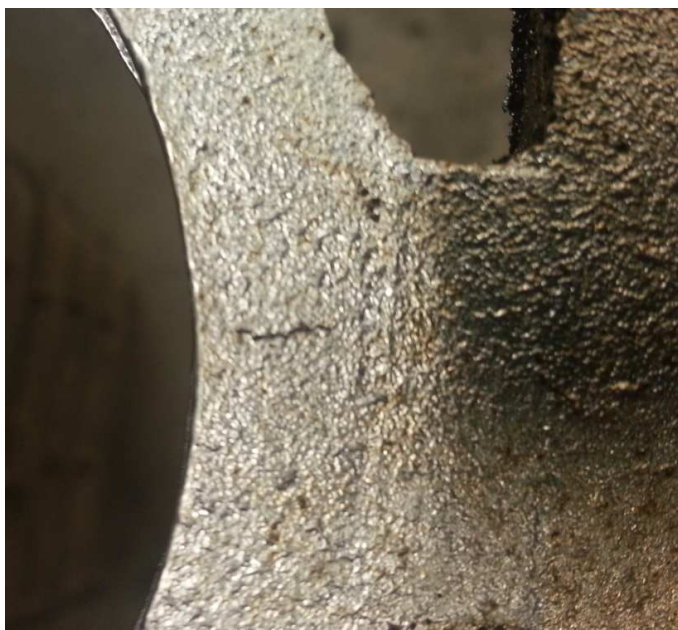
Slika 39. Topla pukotina na odljevku broj 4 širine prstena R=11 , legura AlMg1
