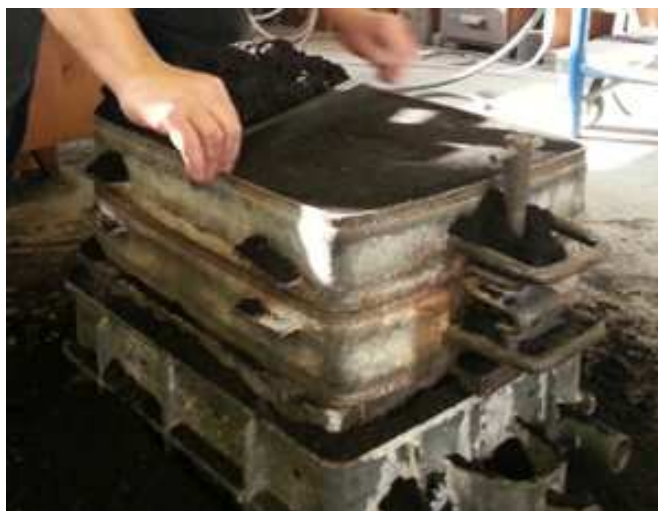
Slika 27. Odstranjivanje viška kalupne mješavine
