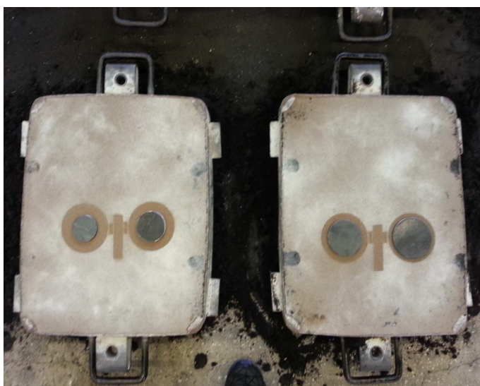
Slika 28. Prikazuje pozicionirane jezgre
