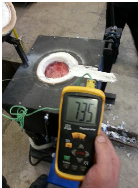
Slika 35. Prikaz mjerenja temperature legure u peći
