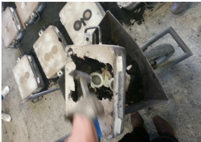
Slika 37. Prikaz istresanja odljevka iz kalupa
