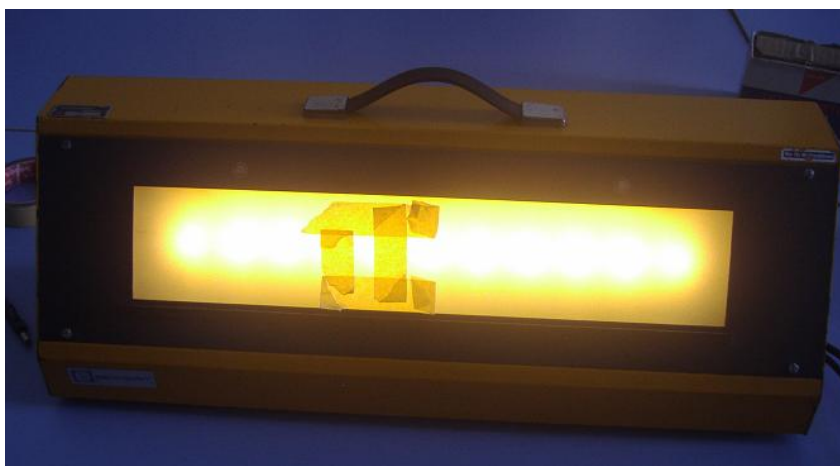
Slika 8. Označavanje područja mjerenja zacrnljenja na površini iluminatora
