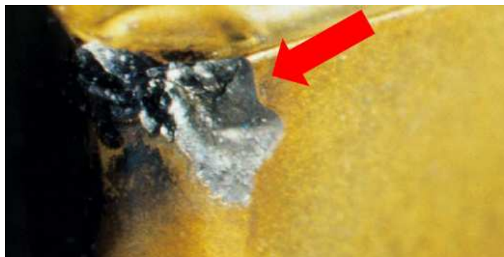
Slika 13. Lom rezne oštrice [5]
