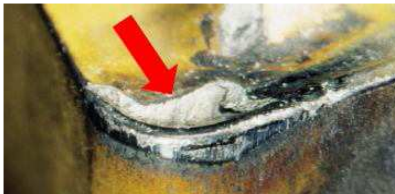
Slika 9. Krater na reznoj pločici [5]
