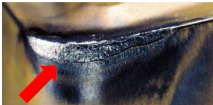
Slika 8. Trošenje na stražnjoj površini alata [5]
