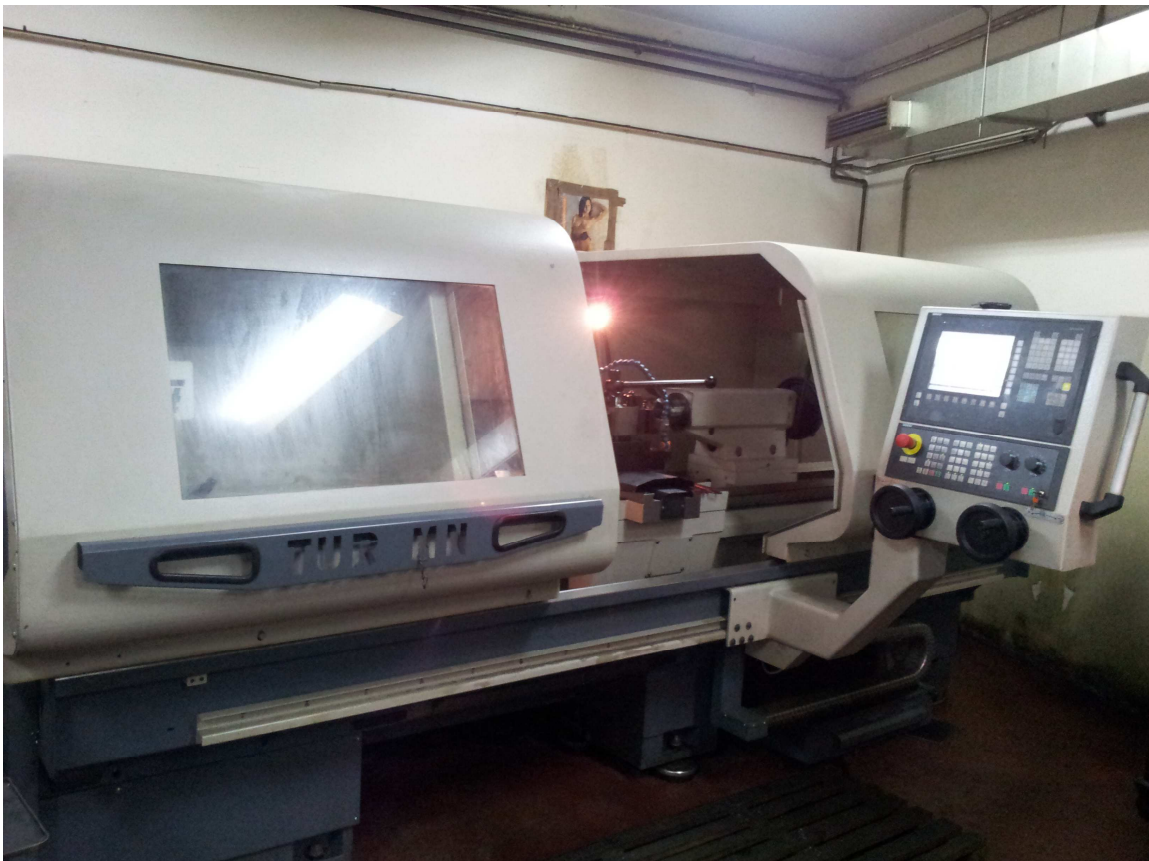
Slika 32. Tokarski obradni centar HACO TUR 580 MN
