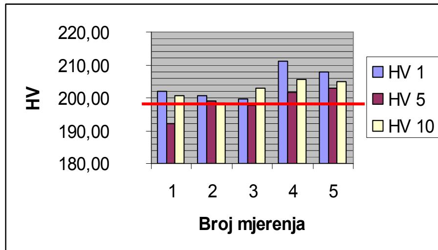
Slika 16: Grafički prikaz rezultata mjerjenja tvrdoće referentne pločice 1 na tvrdomjeru 2
