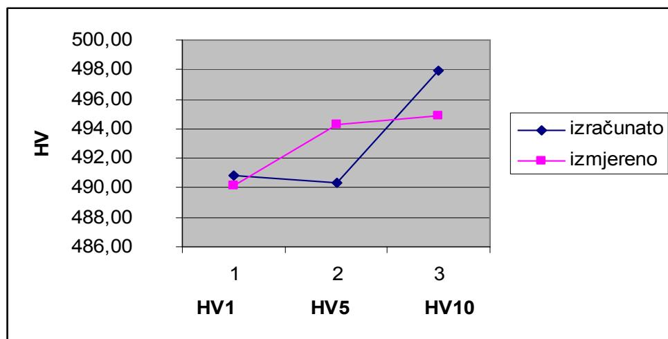
Slika 23: Grafički prikaz razlika izmjerenih i izračunatih vrijednosti tvrdoća referentne pločice 2 na tvrdomjeru 2
