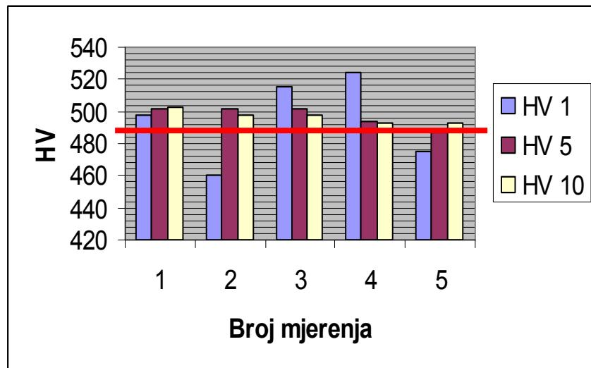
Slika 14: Grafički prikaz rezultata mjerena tvrdoće referentne pločice 2 na tvrdomjeru 1
