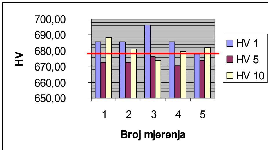
Slika 18: Grafički prikaz rezultata mjerena tvrdoće referentne pločice 3 na tvrdomjeru 2
