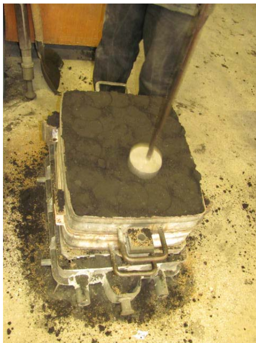
Slika 26. Sabijanje kalupne mješavine donjaka
