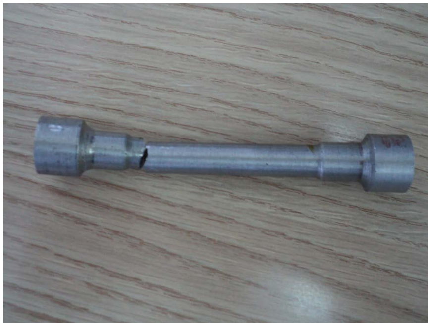
Slika 60. Mjesto loma druge ispitne epruvete od AlSi12CuNiMg legure
