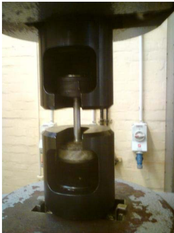
Slika 59. Pozicija epruvete na kidalici
