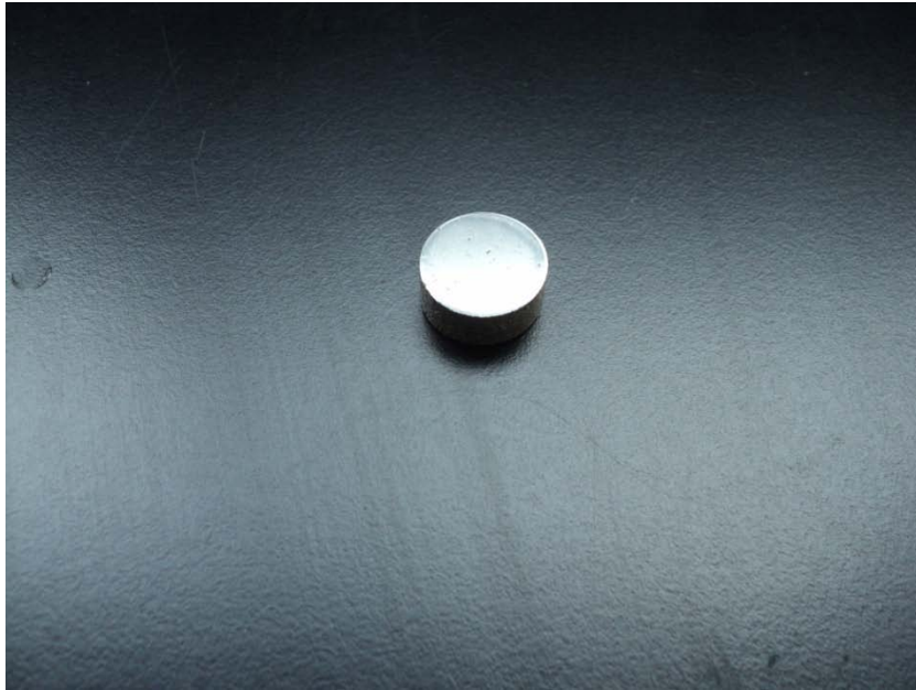
Slika 45. Uzorak za ispitivanje mikrostrukture ( \Phi 20 \times 10 mm)
