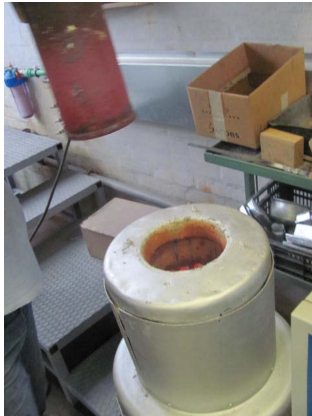
Slika 38. Umetanje lonca u elektrootpornu peč
