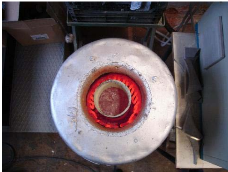
Slika 34. Taljevina AlSi12 legure u peći
