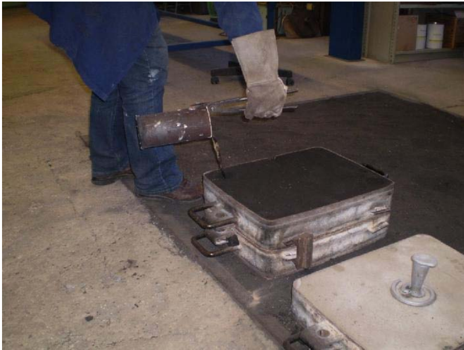
Slika 37. Ulijevanje taljevine u kalup
