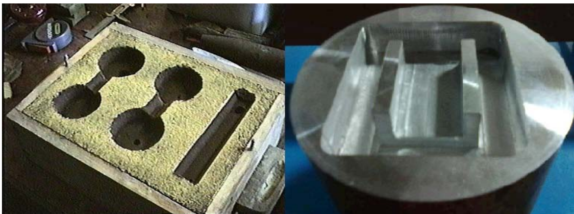
Slika 4. Donjak jednokratnog kalupa (lijevo) i donjak stalnog kalupa (desno) [5,6]
