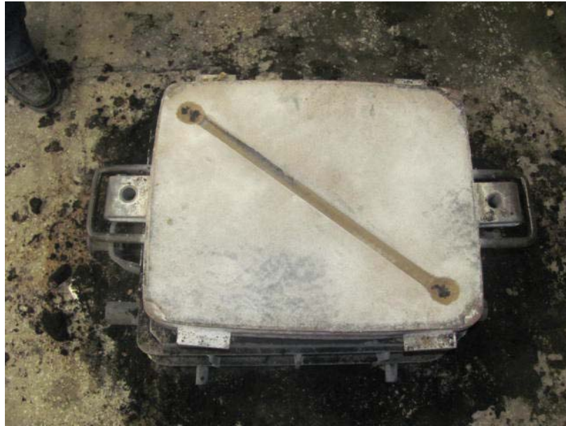
Slika 29. Donjak nakon oblikovanja spusta
