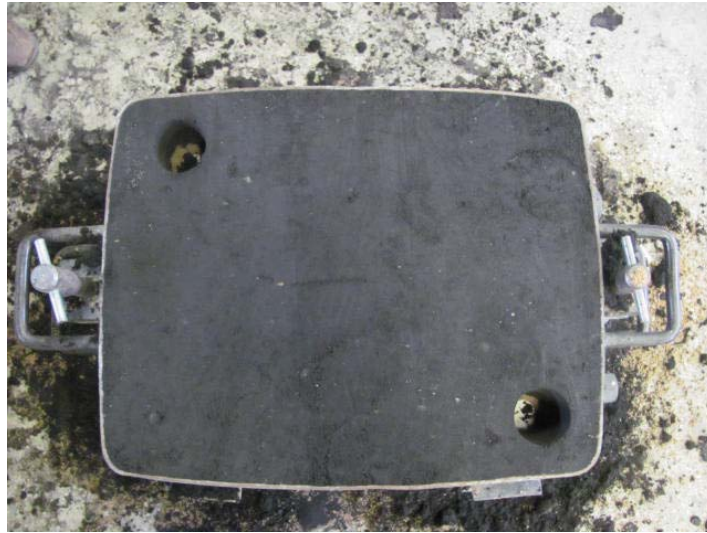
Slika 31. Jednokratni pješčani kalup
