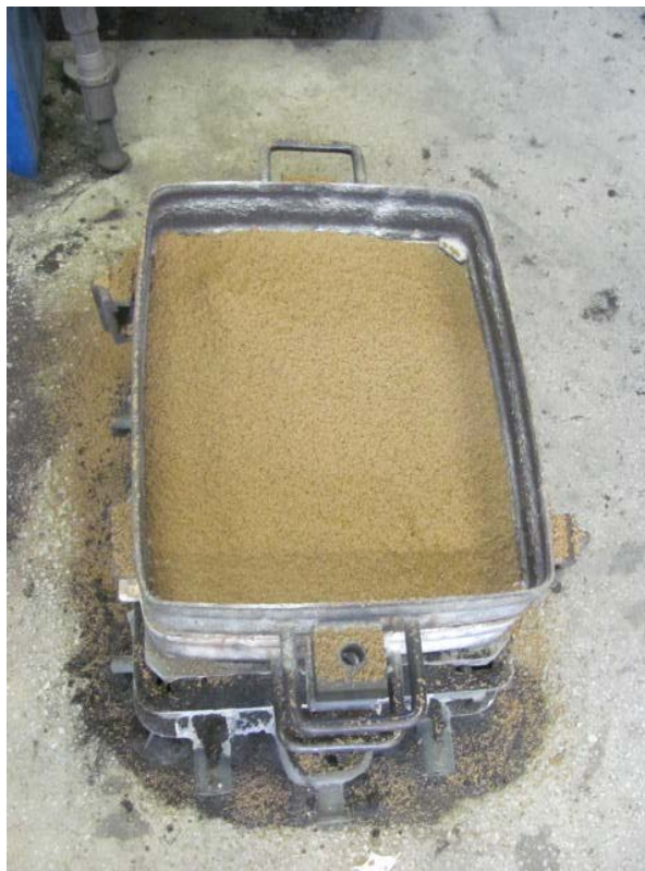
Slika 24. Nasipavanje modelnog pijeska
