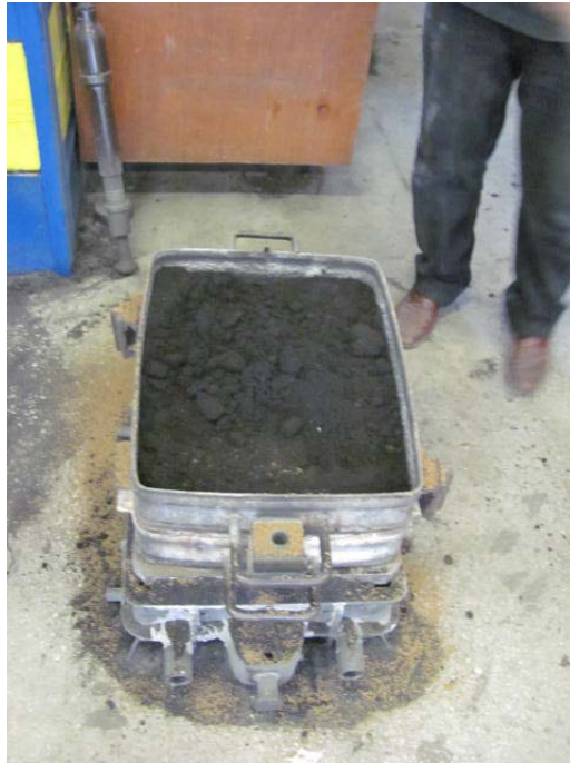
Slika 25. Nasipavanje već korištenog pijeska
