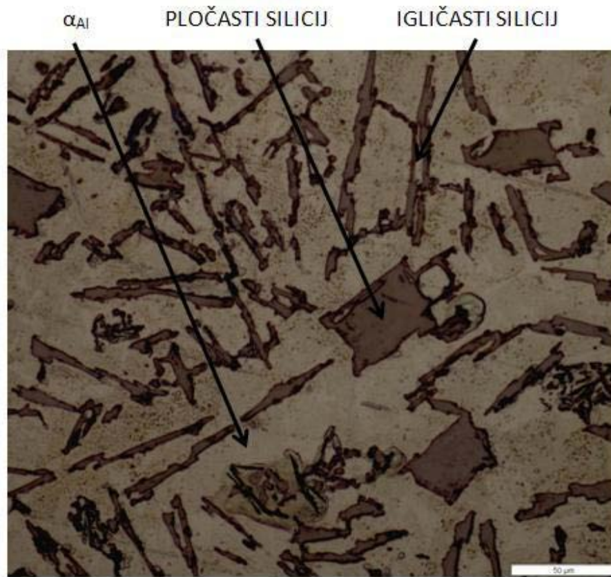
Slika 63. Mikrostruktura AlSi12 legure (povećanje 500x)
