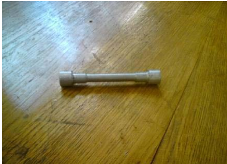
Slika 56. Epruveta za vlačna ispitivanja na kidalici
