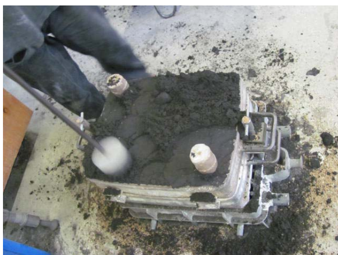
Slika 28. Sabijanje kalupne mješavine gornjaka
