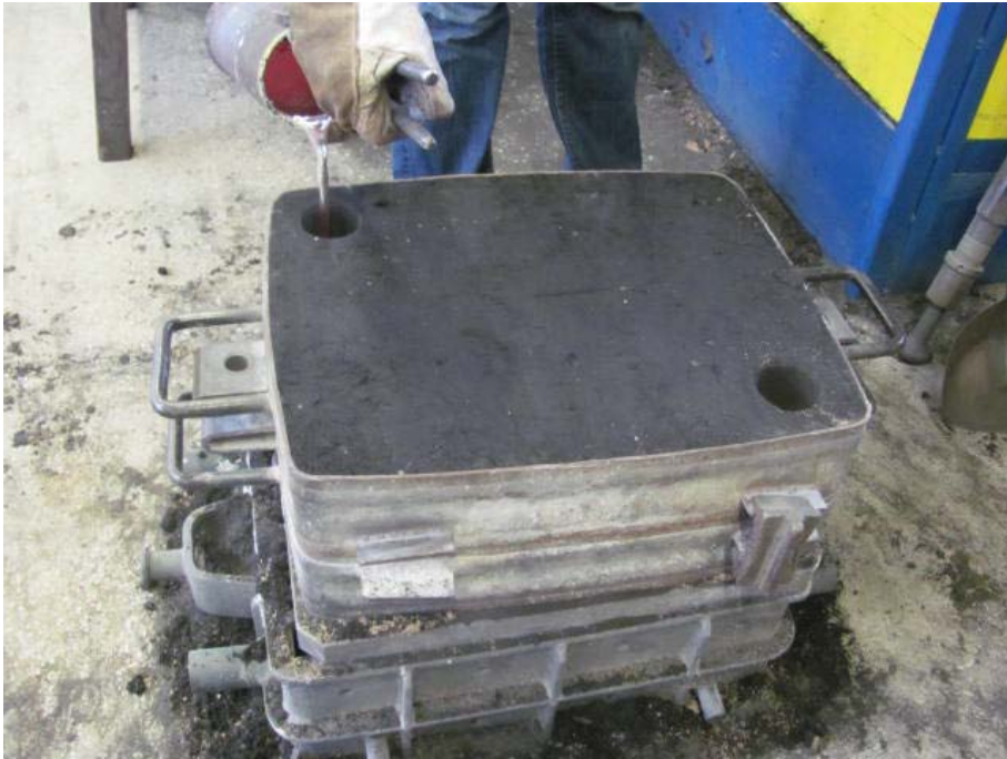
Slika 40. Ulijevanje rastaljene AlCuMgSi legure u kalup
