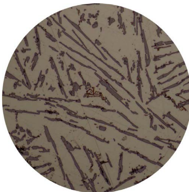
Slika 55. Mikrostruktura neobrađene AlSi12 legure otplinjene Nitralom C19 (povećanje 500x)
