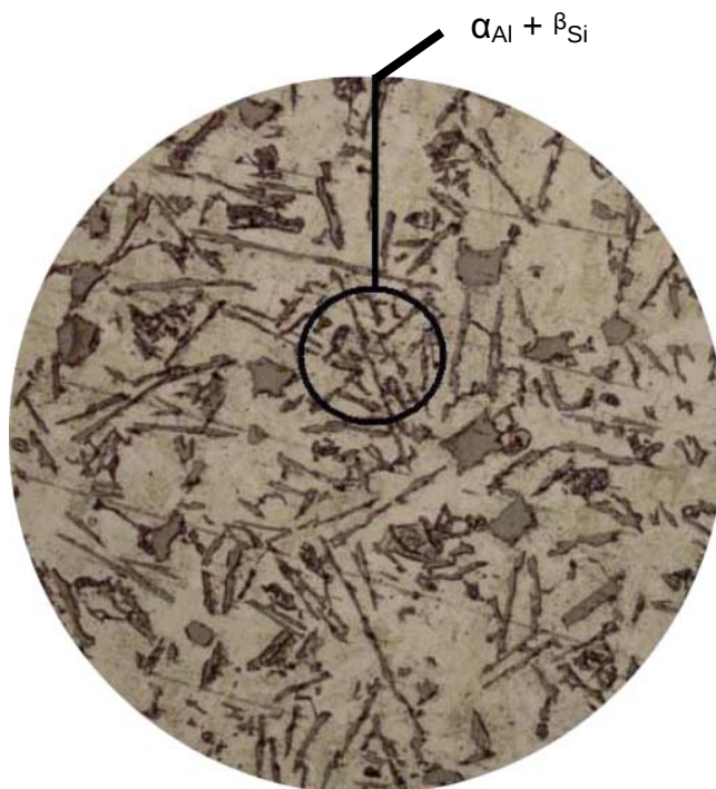
Slika 50. Mikrostruktura neobrađene AlSi12 legure (povećanje 200x)
