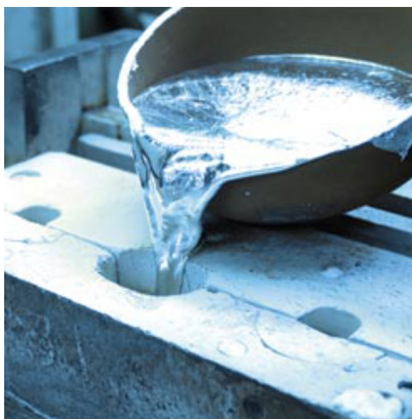
Slika 5. Ulivanje taljevine u stalni kalup [7]
