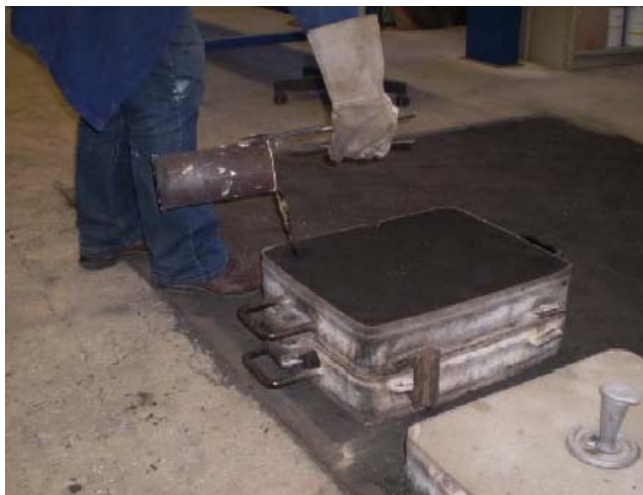
Slika 29. Ulijevanje taljevine u pješčani kalup
