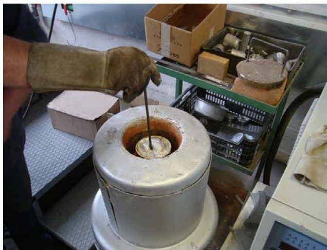
Slika 33. Potapanje tablete u taljevini
