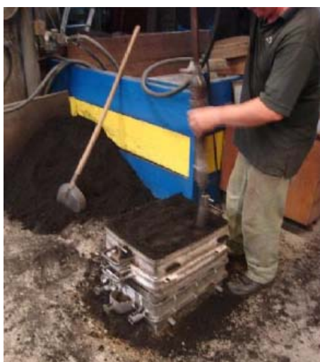
Slika 20. Sabijanje kalupne mješavine
