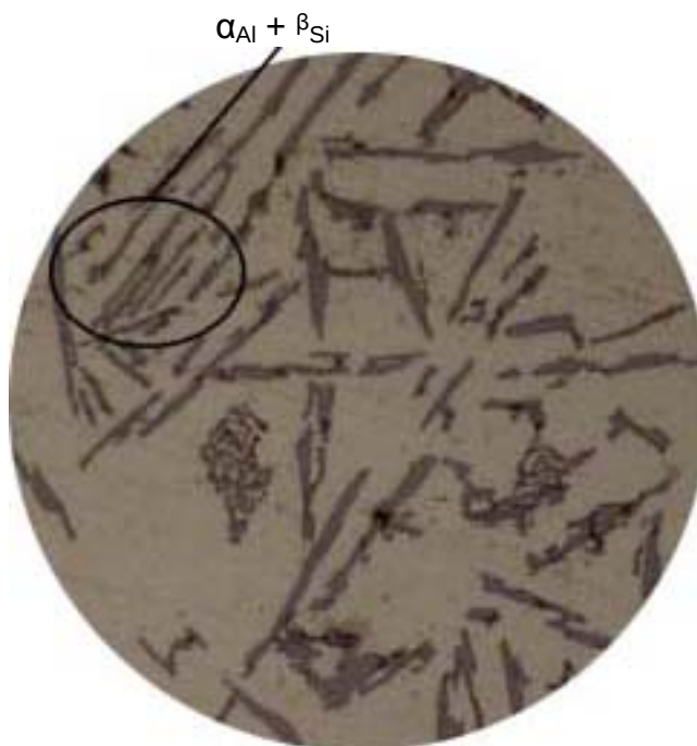
Slika 53. AlSi12 legura cijepljena AlTi10 predlegurom (povećanje 500x)
