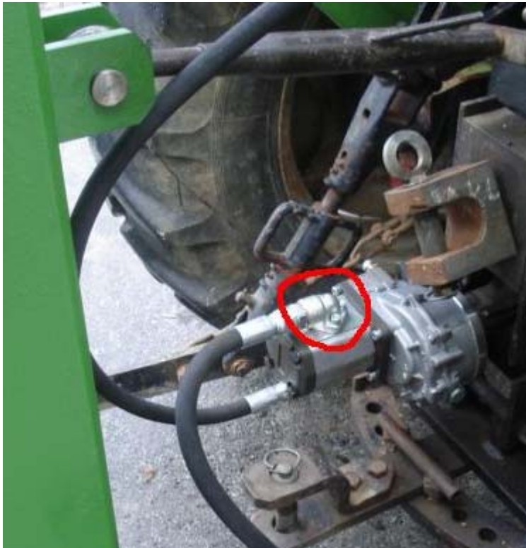
Slika 12. Pumpa montirana direktno na kardansko vratilo traktora
