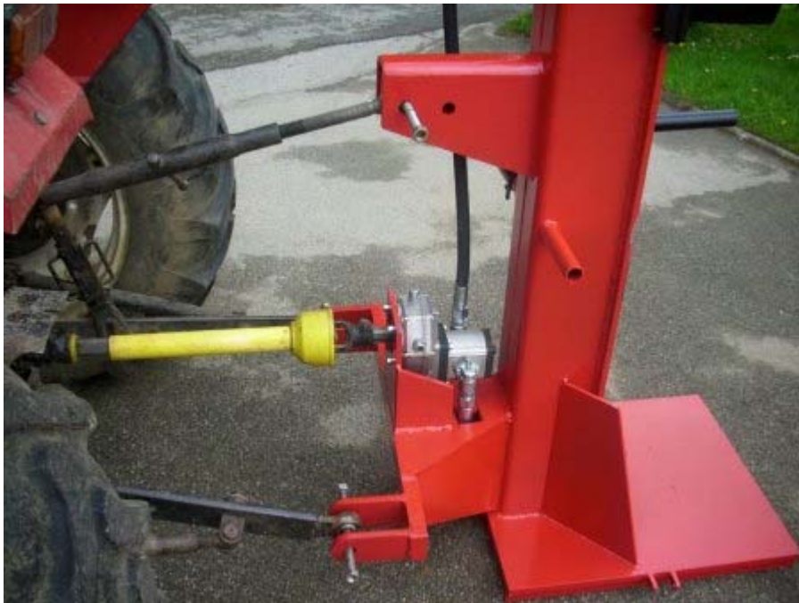
Slika 13. Pumpa montirana fiksno na cjepač
