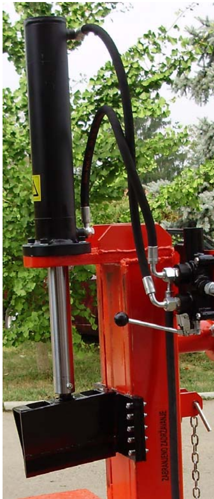
Slika 21. Prihvat cilindra prirubnicom na dnu.
