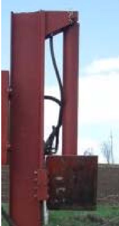
Slika 20. Prihvat cilindra svornjakom na vrhu.
