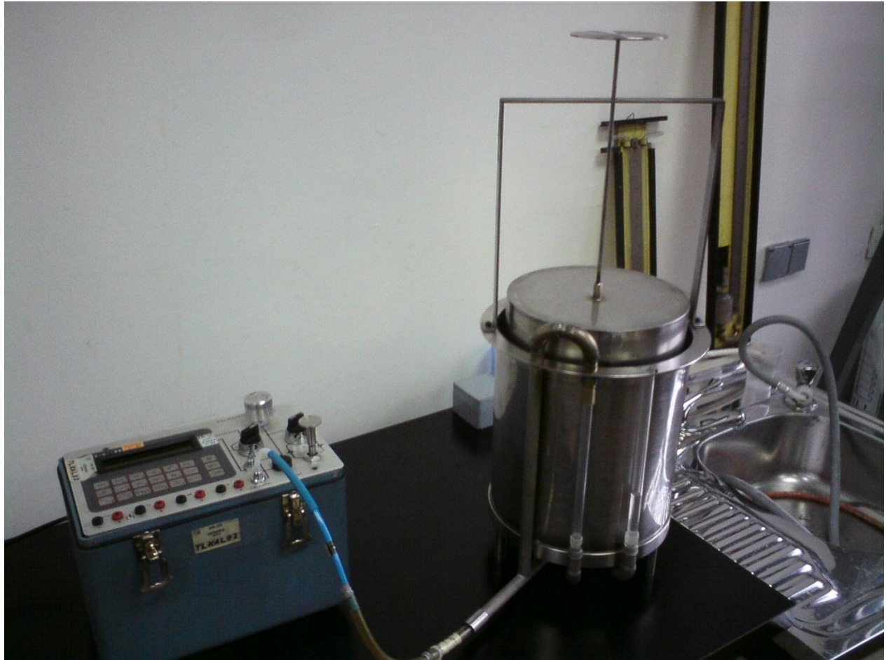
Slika 10.2. Određivanje minimalne točke mjernog područja zvonastog manometra
