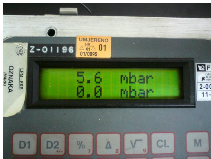
Slika 10.3. Pretlak u zvonastom manometru uslijed njegove težine
