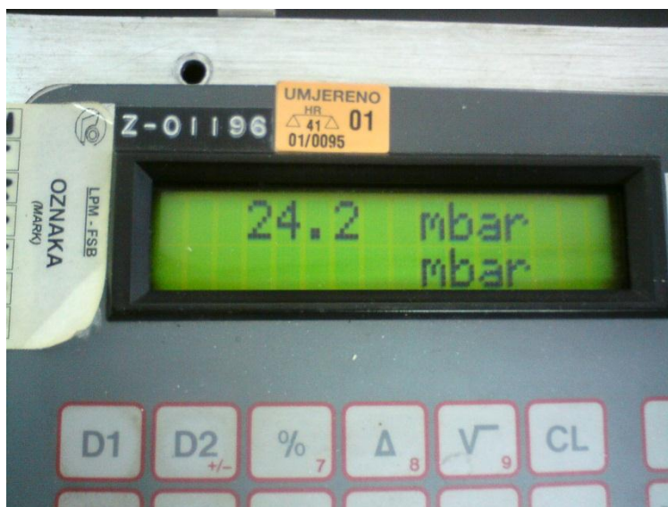
Slika 10.5. Maksimalni postignut pretlak u zvonastom manometru
