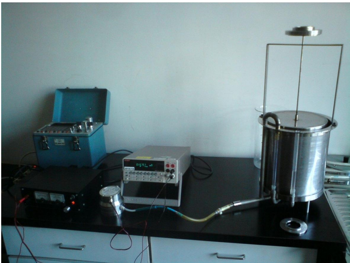
Slika 10.9. Ispitivanje stabilnosti radnih točka zvonastog manometra
