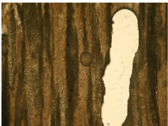
Slika 40. Mikrostruktura laminata nakon djelovanja vode, snimak 11
