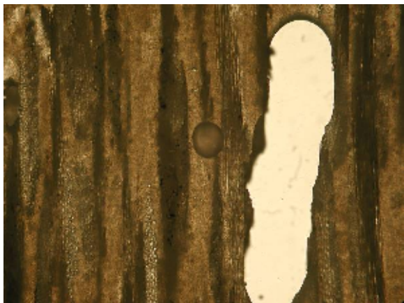
Slika 40. Mikrostruktura laminata nakon djelovanja vode, snimak 11
