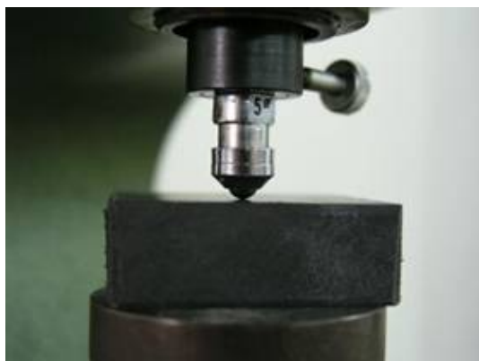
Slika 8. Tvrdomjer s kuglicom za plastomere i duromere [5]
