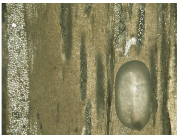
Slika 41. Mikrostruktura laminata nakon djelovanja vode, snimak 12
