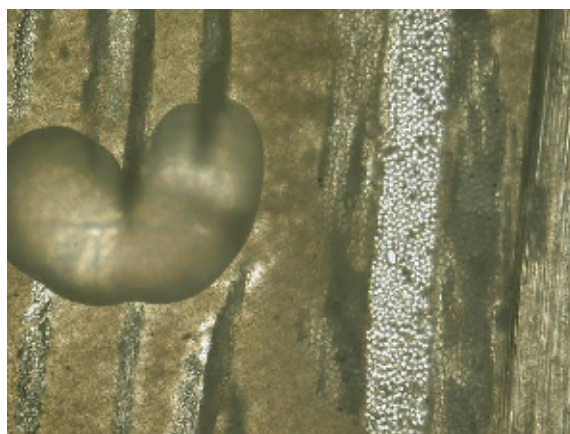
Slika 33. Mikrostruktura laminata nakon djelovanja vode, snimak 4
