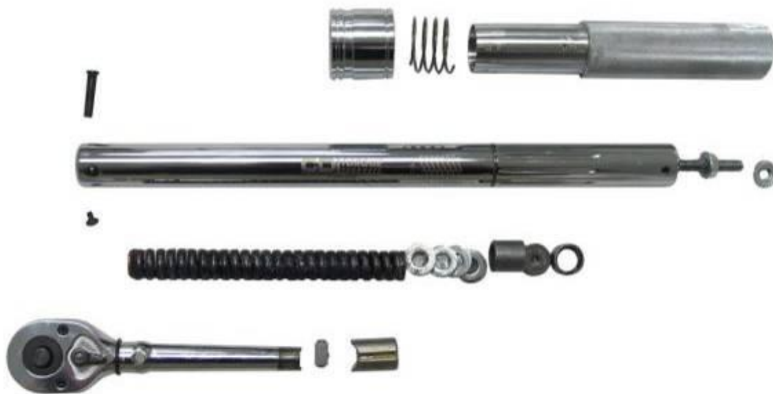
Slika 2: Rastavljeni mehanički momentni ključ s fiksnim podešenjem (tip sa zvučnom indikacijom) [4]
