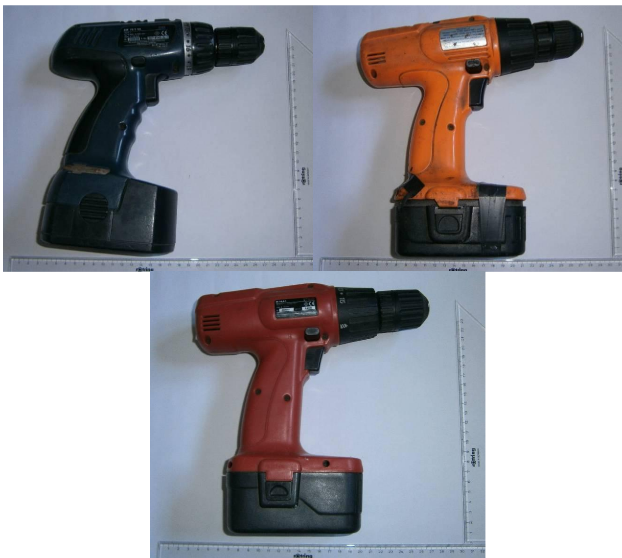
Slika 37: Bušilice korištene za određivanje dimenzija prihvata bušilice [5]
