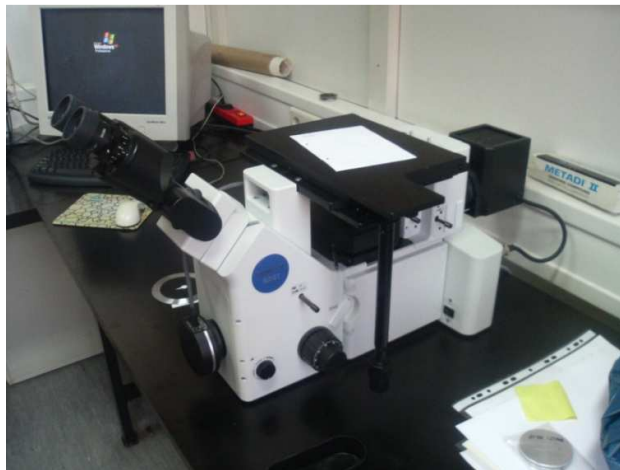
Slika 18: Svjetlosni mikroskop OLYMPUS GX51
