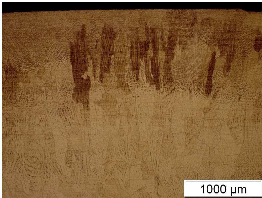
Slika 39: Mikrostruktura metala zavara u tjemenu uzorka V
