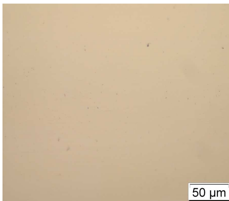
Slika 22: Površina uzorka V u području metala zavara, u poliranom stanju
