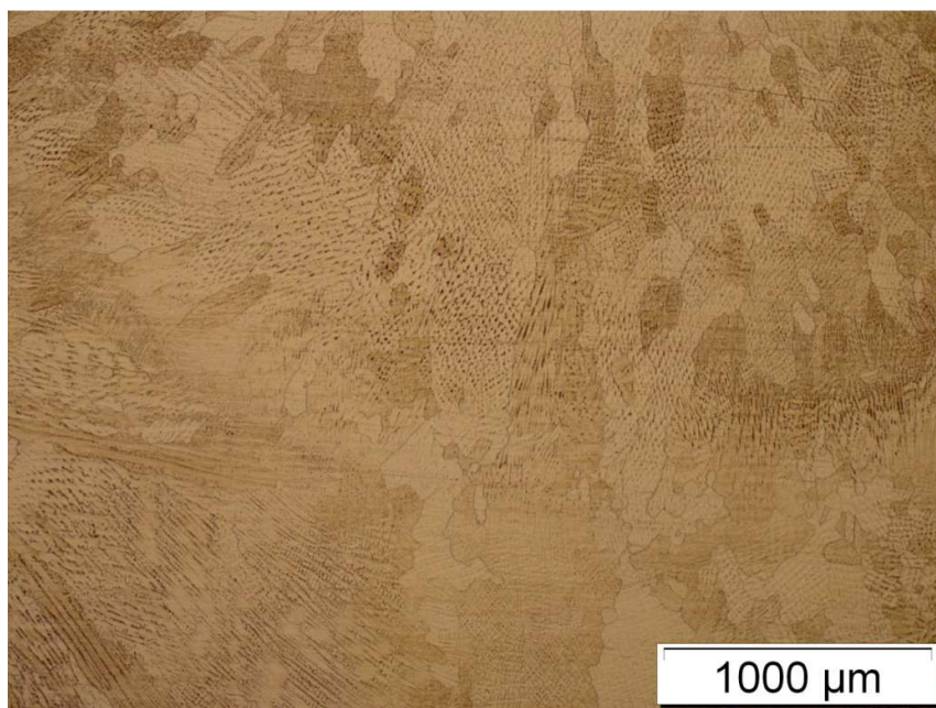
Slika 30: Mikrostruktura metala zavara u sredini uzorka M
