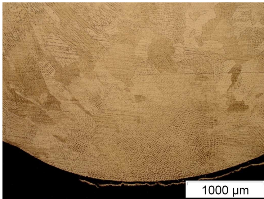
Slika 31: Mikrostruktura metala zavara u korijenu uzorka M
