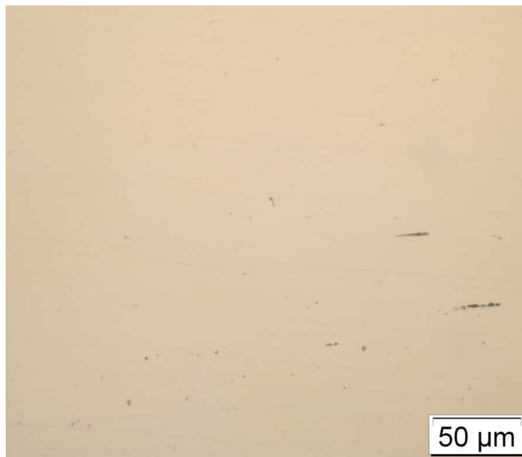
Slika 19: Osnovni materijal uzorka M, u poliranom stanju
