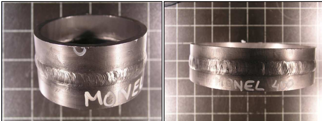
Slika 7: Uža cijev Monela 400 (lijevo), i šira cijev (desno)
