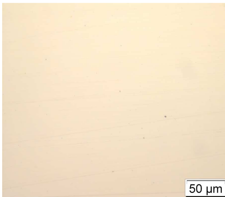
Slika 20: Površina uzorka M u području metala zavara, u poliranom stanju
