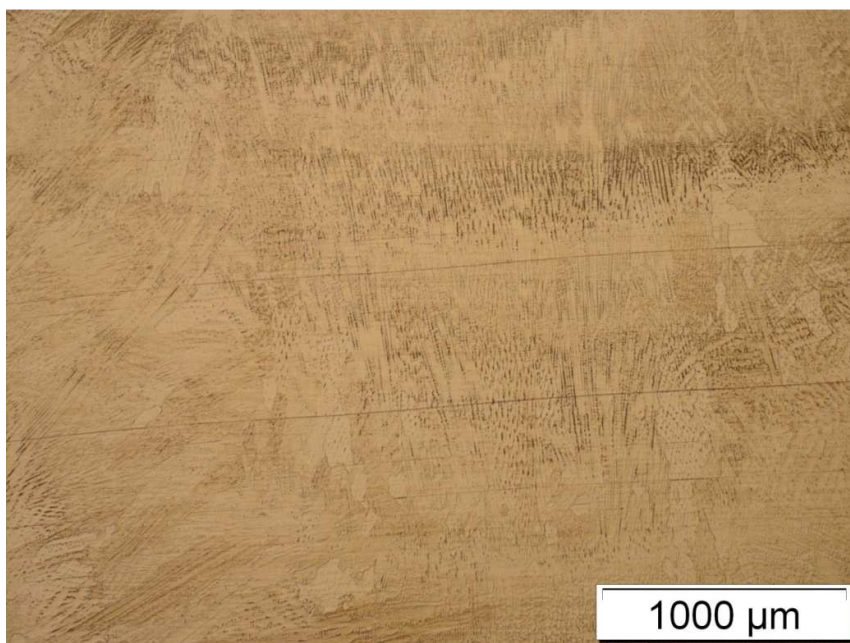
Slika 40: Mikrostruktura metala zavara u sredini uzorka V
