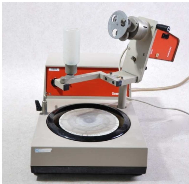
Slika 17: Uređaj za brušenje i poliranje (Struers DAP-V)
