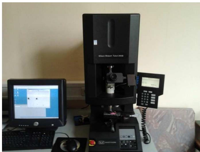
Slika 47: Mikrotvrdomjer WILSON-WOLPERT TUKON 2100 B proizvođača INSTRON
