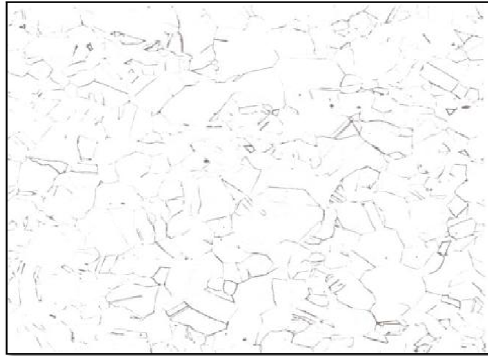
Slika 6: Tipična mikrostruktura hladno vučene šipke legure Monel 400, [19]
