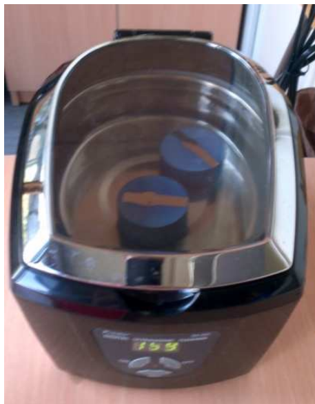
Slika 16: Uzorci u ultrazvučnoj čistilici Pro'sKit SS-802
