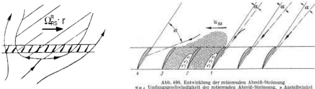
Abb. 498. Entwicklung der rotierenden Abreiß-Strömung
