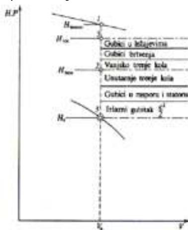
Redoviti gubici su oni zbog trenja na vanjskim površinama diska, u labirintnim brtvenicama i u glavnim ležajevima i oni se u općem slučaju mogu dodati na one nastale uslijed problema sa strujanjem unutar samog stroja .
