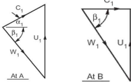
Shepherd (1956) razmatra generalniji pristup usisa kompresora koji uključuje efekt nastalog slobodnog predvrtloga tj. pre-rotacije. On je određen sljedećim izrazima iz torkuta brzina prema sljedećoj slici 2.6. Predvrtlog se dobiva podešavanjem usmjeravajućih lopatica  $C_\theta$  protustrujno 2.6 a).
