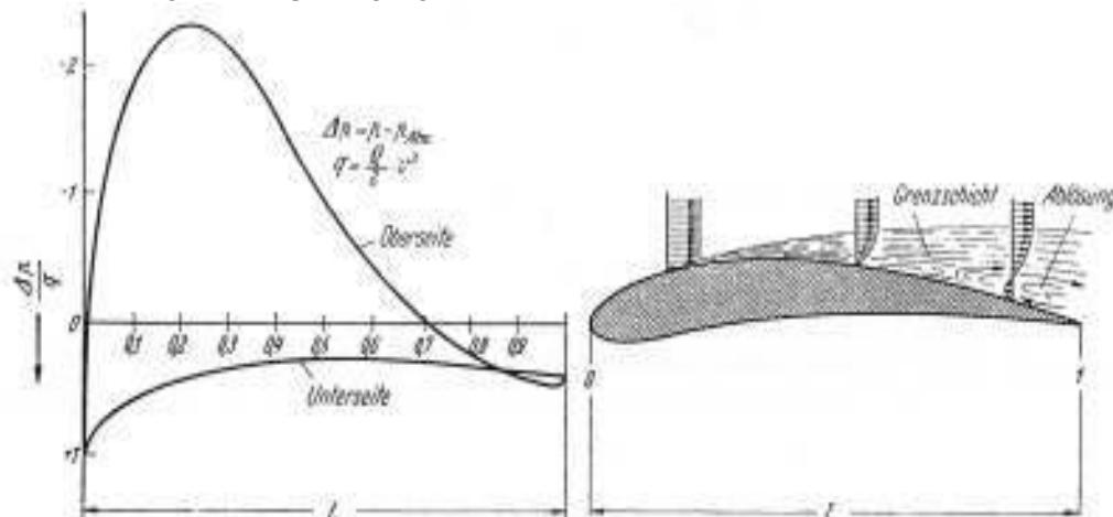
Abb. 125. Tipische Form der Druckverteilung auf der Kontur eines Tragflügelprofils und Strömungsverlauf auf der Profiloberfläche bei Abhebung
