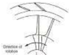
stupanj centrifugalnog turbokompresora 2.1
