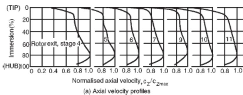
3.5 Poprečne (meridijalne) bezdimenzijske brzine profilirane na 12-stupanjskom kompresoru Smith(1970)
