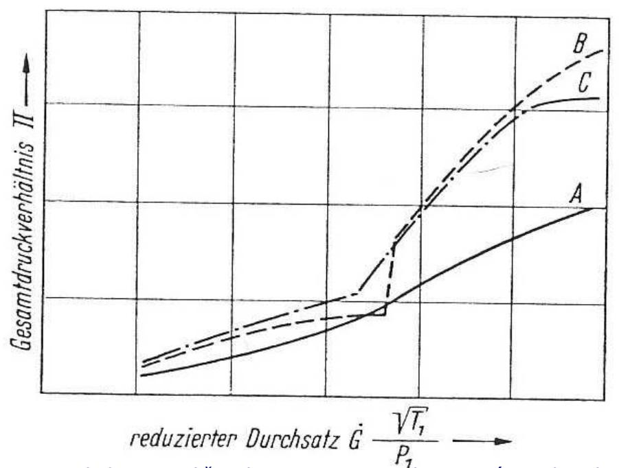
4.10 Granica prekida za različite kompresore A-niskoopterećeni aksijalni sa malim projektnim brojem okretaja :B visokoopterećeni aksijalni kompresor sa nepovoljno dizajniranim prvim stupnjevima ; C- visokoopterećeni aksijalni kompresor sa povoljno dizajniranim prvim stupnjevima.
