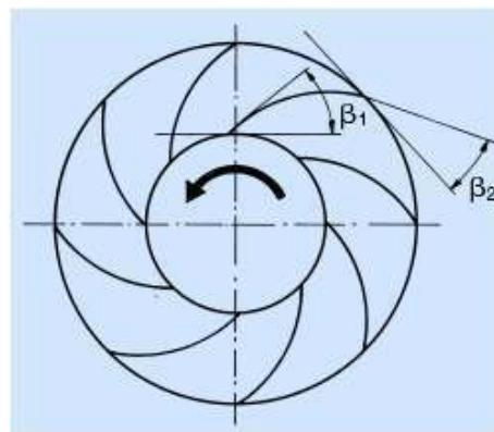
trokuti brzina na ulazu i izlazu iz rotora (dolje) 2.3
