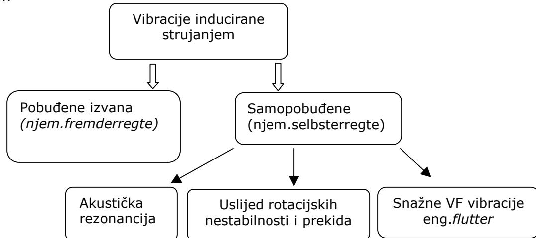
U osnovi razlikuje se prema inicijalizaciji titranja kod strujanjem induciranih vibriracija lopatica vanjska pobuda ili pobuda uslijed strujanja u samom turbostroju . Kod mehanizama postanka (harmonijskih uslijed brojeva okretaja) za vanjsku pobudu ubraja se svaka vanjska smetnja unesena u sustav kao uzajamno djelovanje između rotora i statora te svaka rotorska ili statorska karakteristična frekvencija promatranog sustava .
