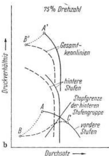
Kod vrlo malih brojeva okretaja prema 4.14 prednji stupnjevi rade neprekidno u području potpunih prekida to znači da radne točke leže na krivulji B-C .
