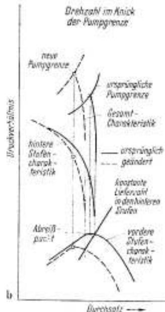
Kod broja okretaja iznad koljena karakteristike granice pumpanja ove mjere imaju malo utjecaja, tako ovdje i zadnji stupnjevi rade upravo na ravnom dijelu njihove karakteristike (slika 4.19) a smanjenje protočne količine ima vrlo mali utjecaj na posljedicu promjene porasta tlaka . Kod projektnih ili visih brojeva okretaja dolazi ponovo do pogoršanja granice pumpanja prema u vidu prethodno izloženog.
