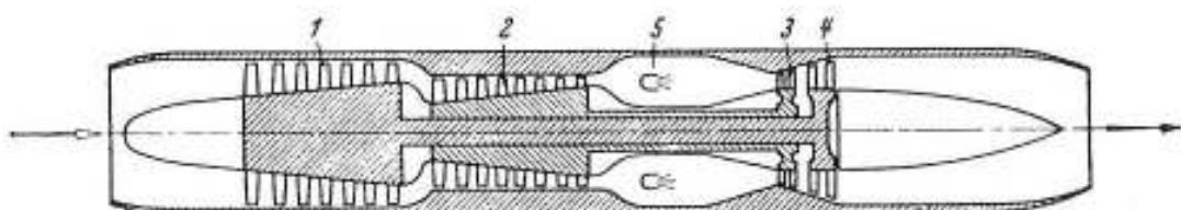
Abb. 515. Schema eines mehrwelligen Turbinen-Luftstrahltriebwerkes
