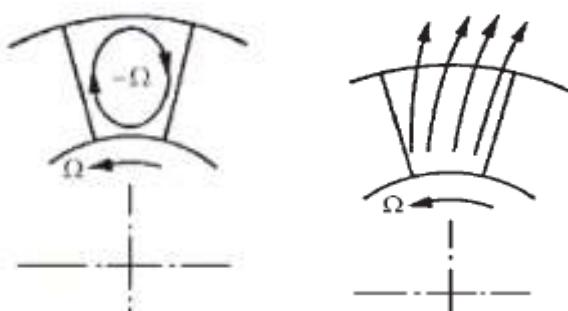
U zatvorenom prostoru između lopatica ove okolnosti uzrokuju relativno strujanje unutar kanala .Impeler ima neku kutnu brzinu  $\Omega$  ,fluid sam poprima  $-\Omega$  pa izlazno strujanje iz impelera može biti narušeno jer je superponirana relativna kutna brzina . Neto efekt ova dva gibanja daje prosječan relativni tok koji izlazi iz impelera pod kutem na lopaticu i to suprotnom od gibanja impelera (*slika 3.2 desno*).
