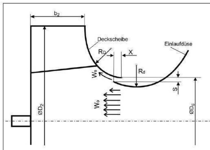
Bild 7: Meridianschnitt des freilaufenden Rades
