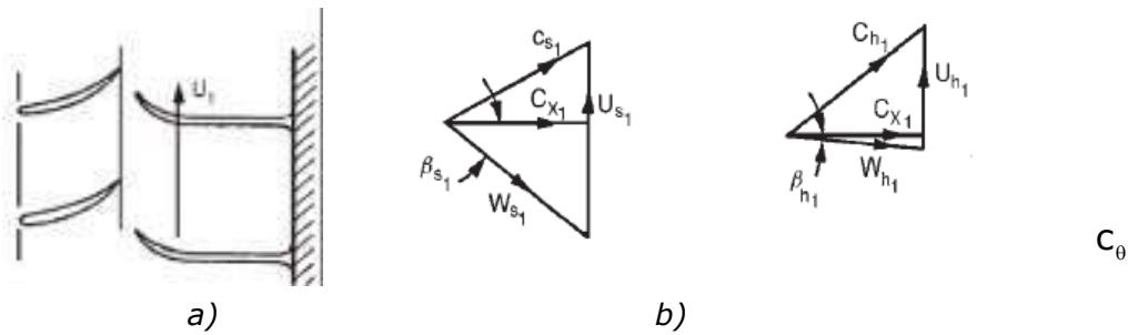
Usmjeravajuće lopatice i lopatice impelera te trokut brzina na ulazu i izlazu iz kompresora (shroud and hub) Slika 2.6
