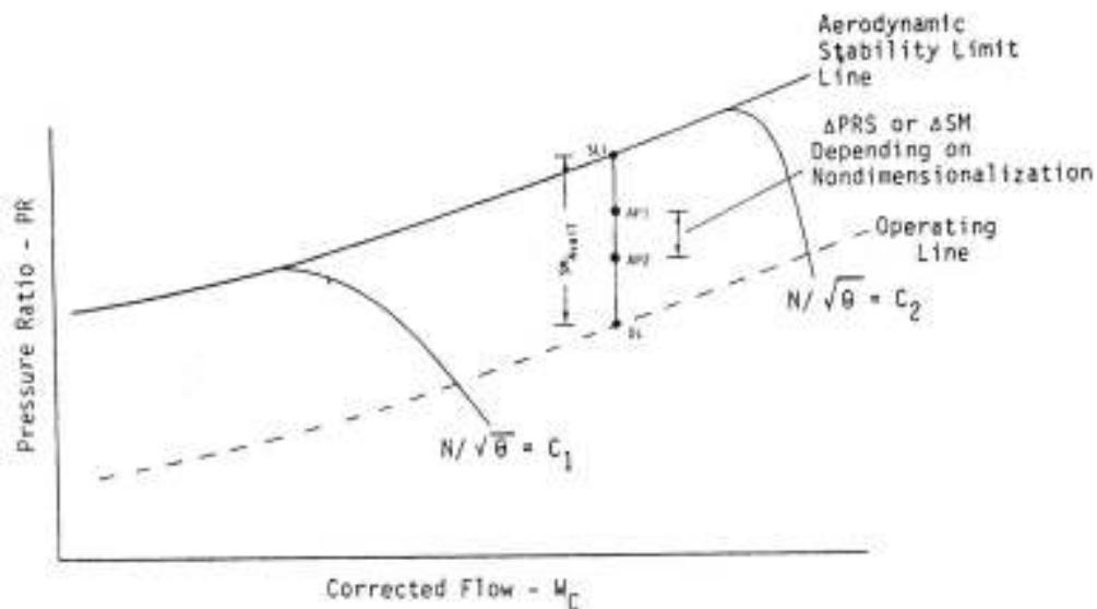
slika 4.1 tipična karta performansi dobivena testiranjem kompresora
