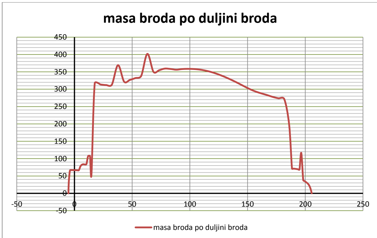
Slika 27 – dijagram rasporeda masa
