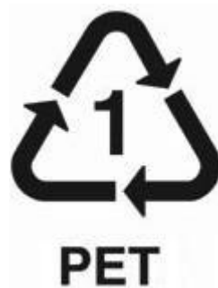
Slika 3.1. Identifikacijski kod PET-a [3]
