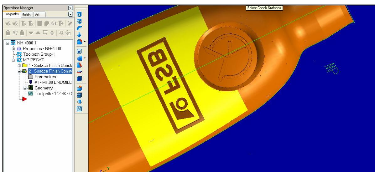
*Slika 5.4.2.2 Odabrana površina od koje se vrši obrada (Check)*
