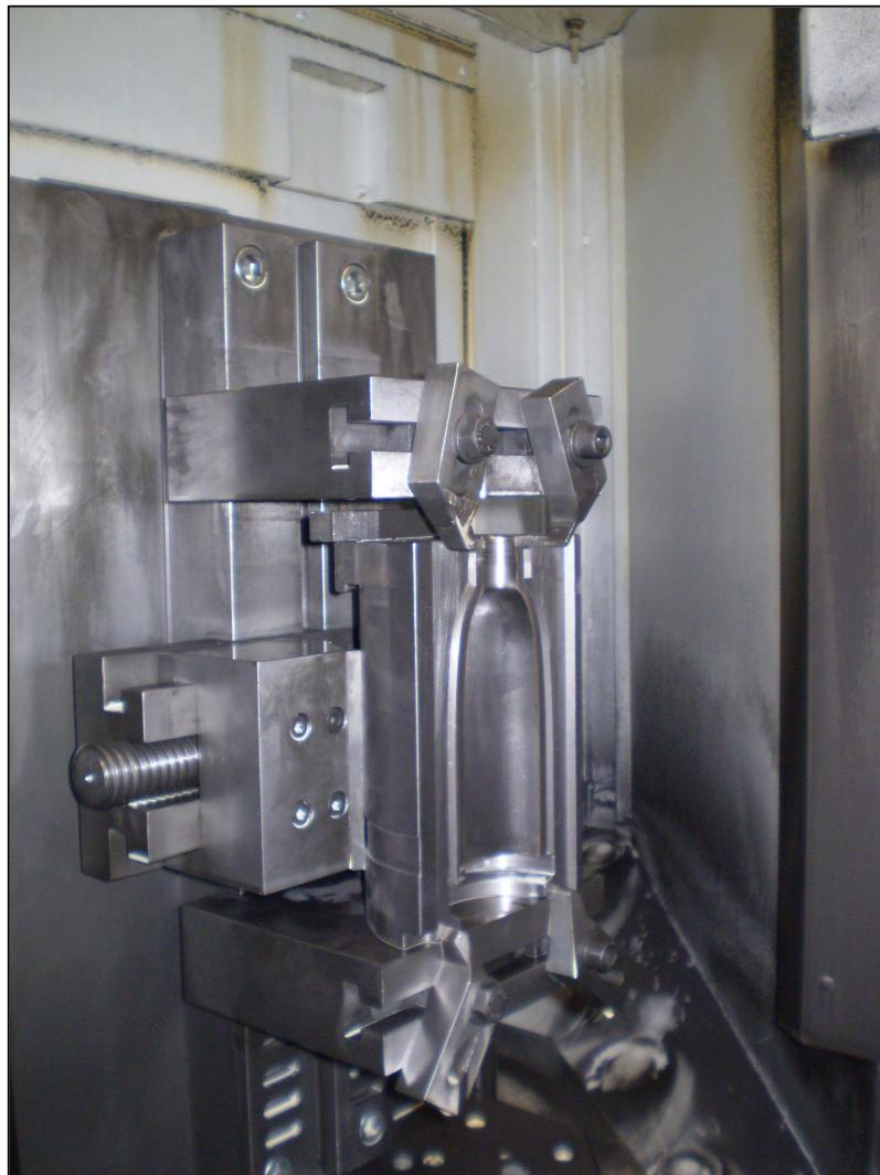
**Slika 5.5.5 Prikaz stezne naprave i načina stezanja polovice kalupa**
