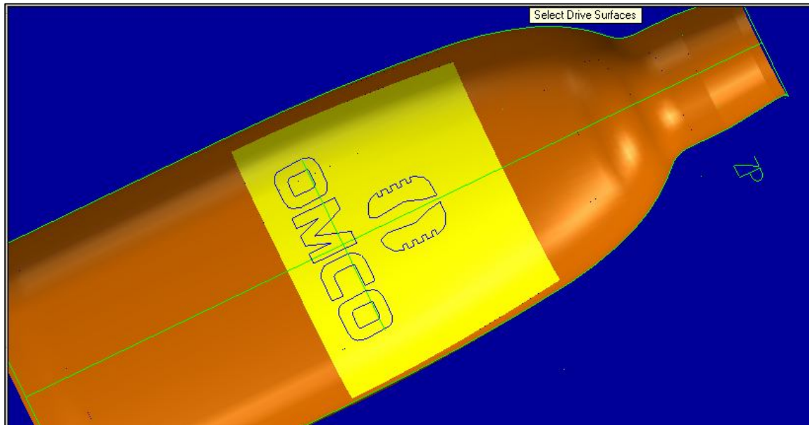
Slika 5.4.5.2 Odabrane površine do kojih se izrađuje gravura
