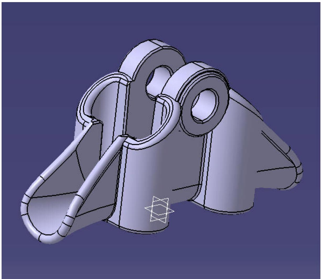
Slika 10 - 3D model, stezaljka 3
