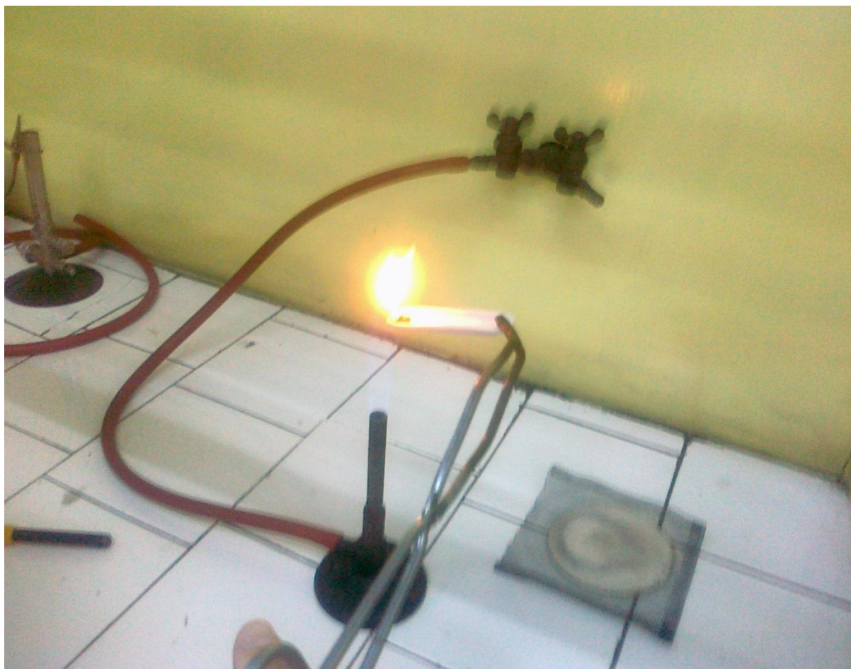
Slika 75. Ispitivanje vrste polimernog materijala gorenjem – uzorak 1
