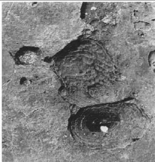
Slika 42. Krateri s rupicama i šupljinama ispod površine na limenom dnu spremnika za odmašćivanje čelika USt 37 (EN oznaka S235) [4]
