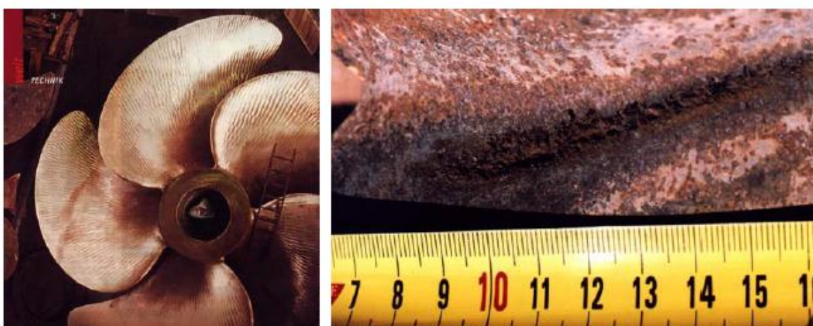
Slika 51. Kavitacijska erozija propelera, [4]
