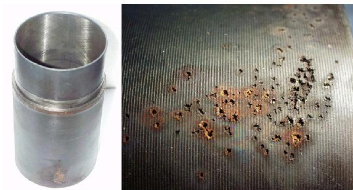
Slika 48. Kavitacijska erozija izazvana strujanjem rashladnog medija na košuljici cilindra brodskog motora [4]
