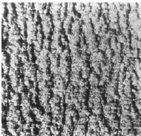
Slika 43. Poprečni grebeni na vodenoj strani cjevovoda, čelik 13CrMo4-4 [4]
