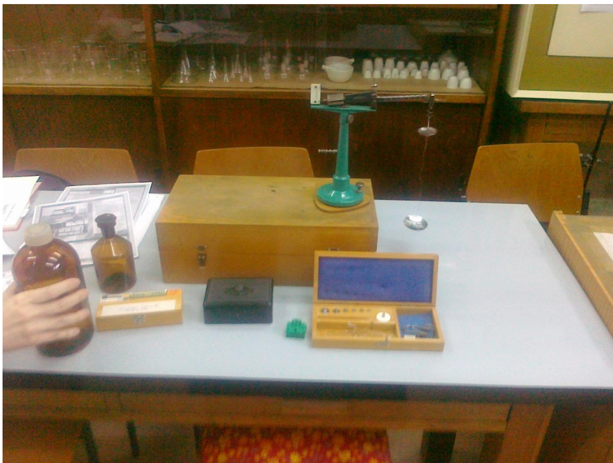
Slika 78. Mohr-Westphal vaga i izopropilni alkohol pomiješan sa vodom
