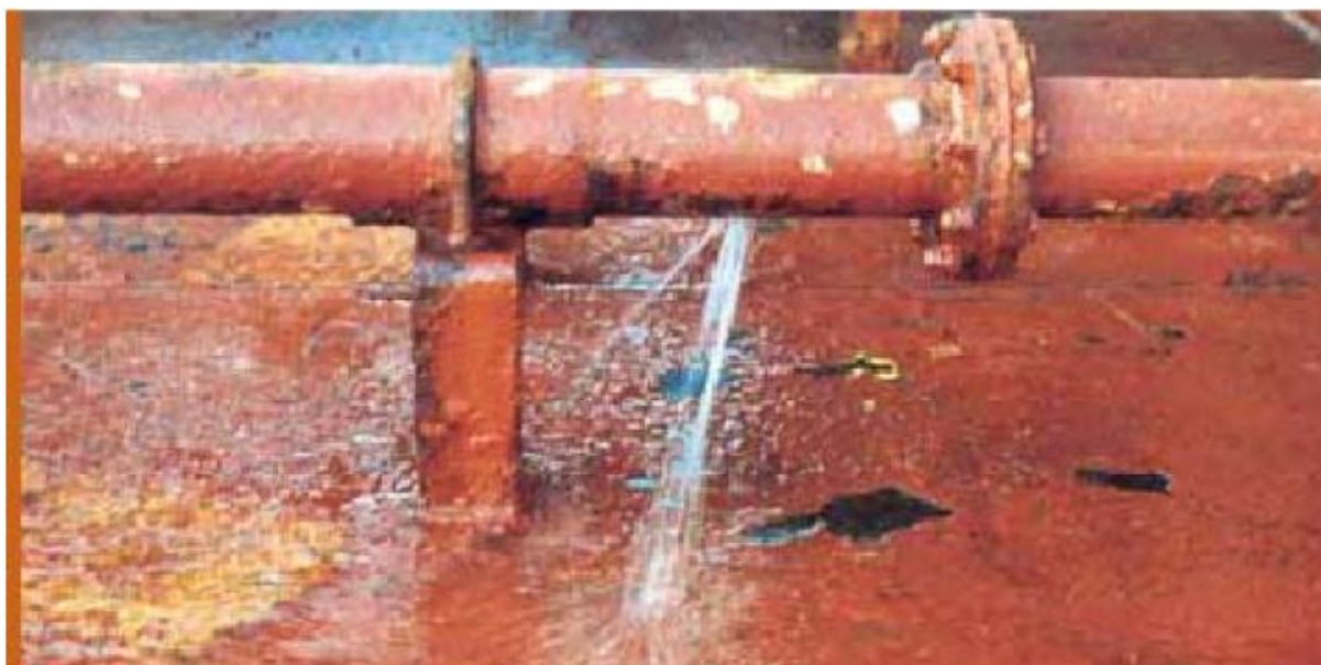
Slika 5. Pucanje pod naprežanjem [5]
