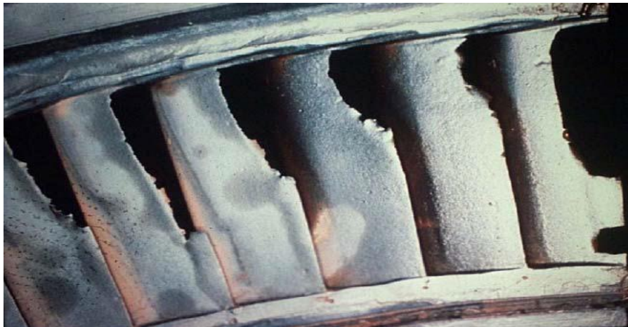
Slika 28. Erozijska krutim česticama (oksidi otkinuti s radnih površina nošeni strujompare) na rotoru parne turbine, [4]
