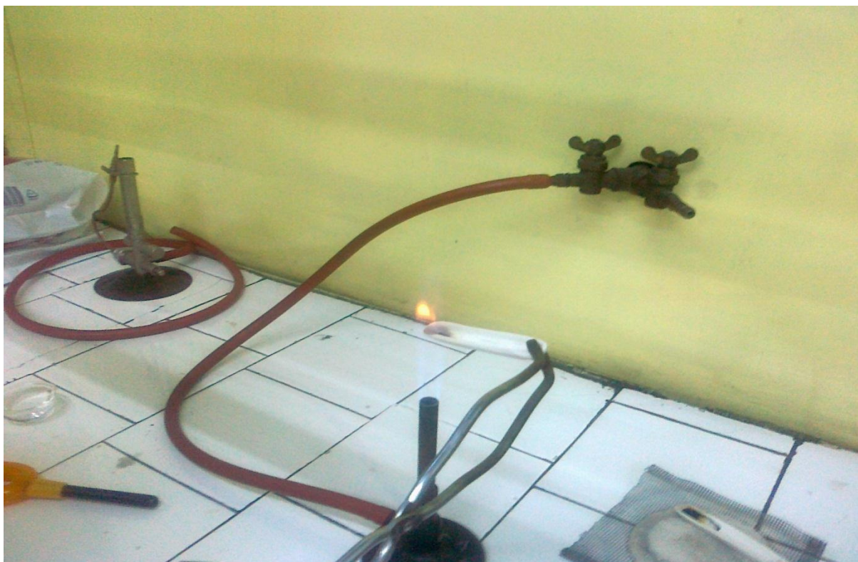
Slika 76. Ispitivanje vrste polimernog materijala gorenjem – uzorak 2
