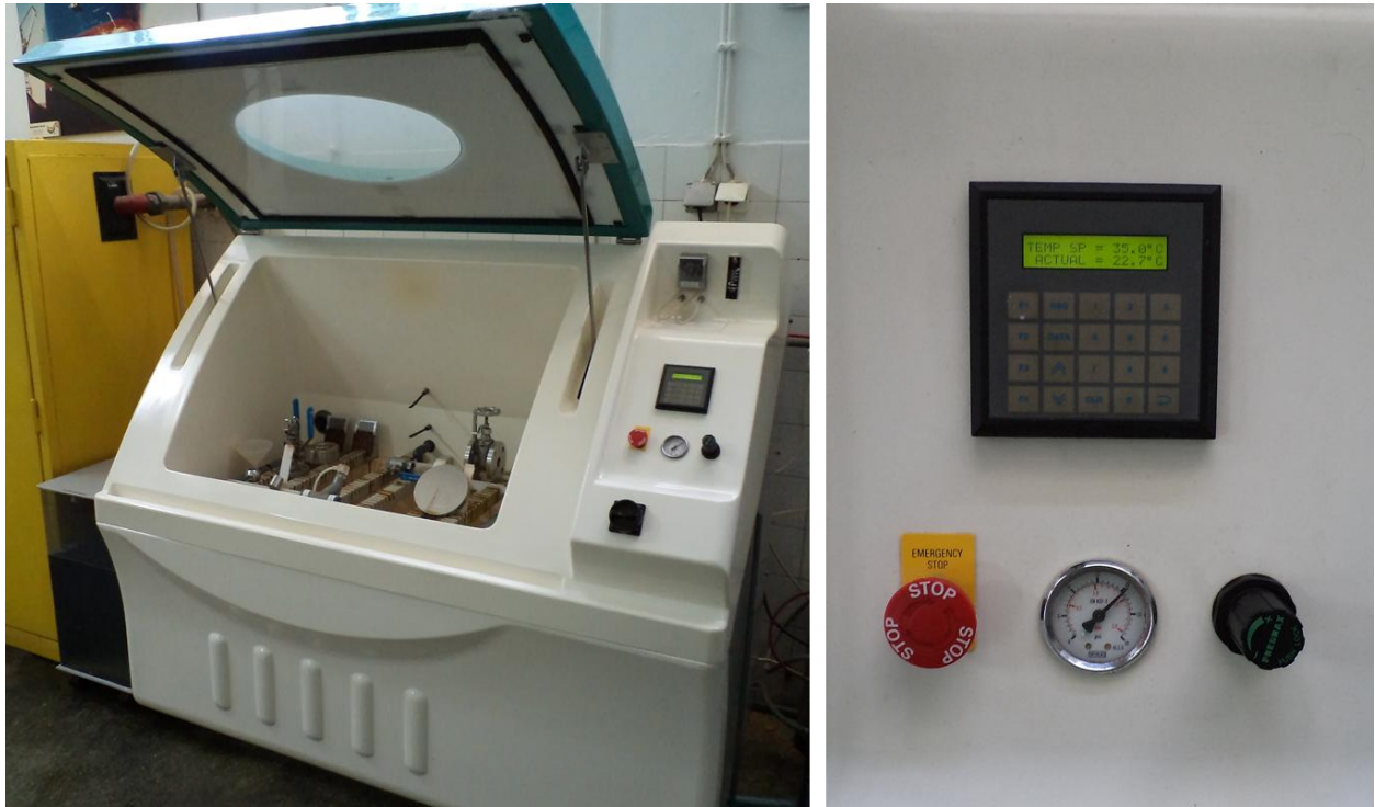
Slika 9.14. Slana komora Ascott-S450 [15]
