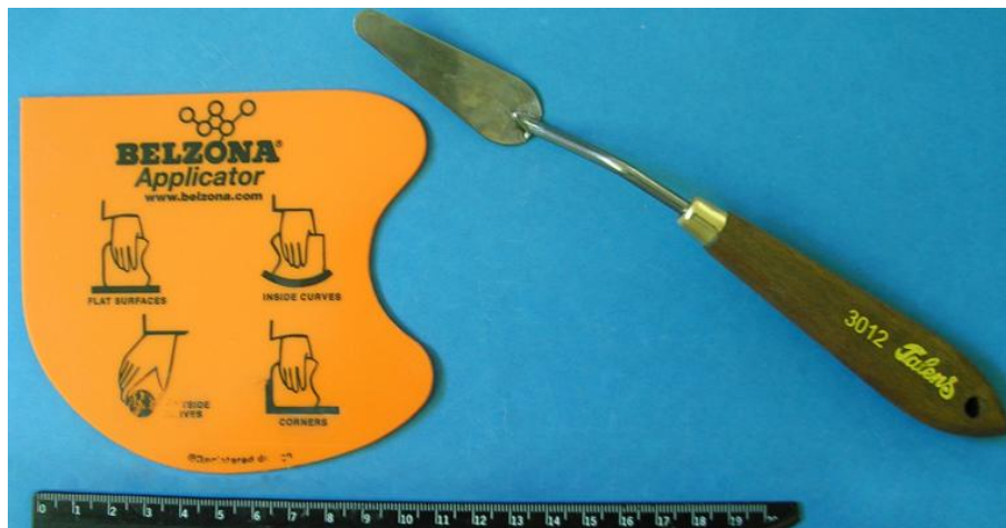
Slika 9.7. Pribor korišten za miješanje i nanošenje prevlaka na uzorke [15]
