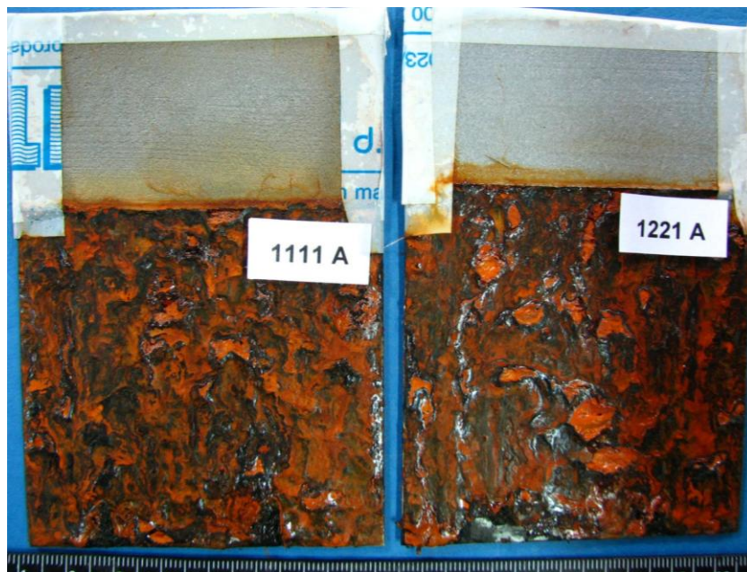
Slika 9.16. Ispitivani uzorci nakon 20 dana u slanoj komori [15]
