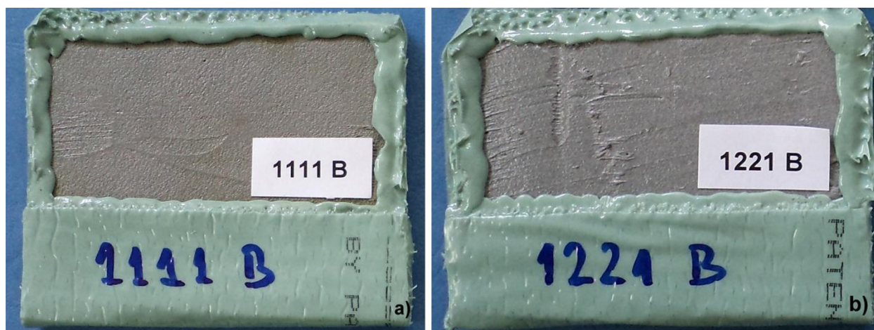
Slika 9.28. Uzorci pripremljeni za ispitivanje u 40% otopini NaOH [15]
