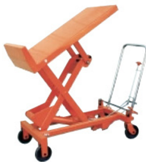
Slika 2.56: Podizna platforma nosivosti 300kg pogonjena nožnom pumpom
