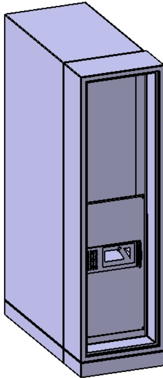
Slika 85. Upravljački ormar 5 osnovnog obradnog centra za glodanje kamena
