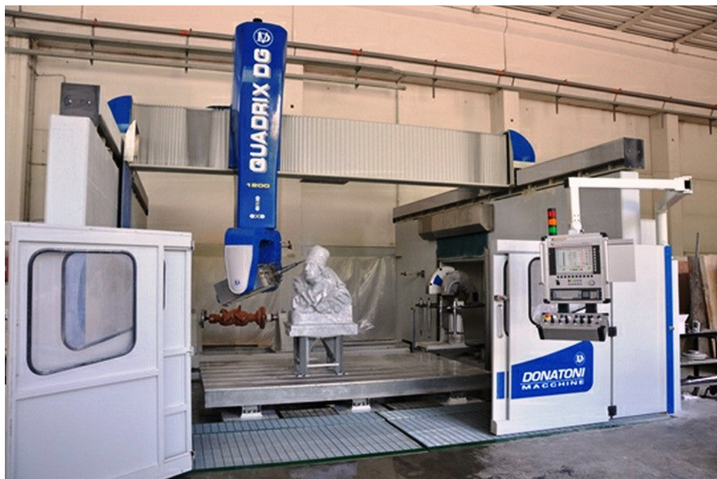
Slika 17. Višeosni obradni centar za glodanje kamena [4]
