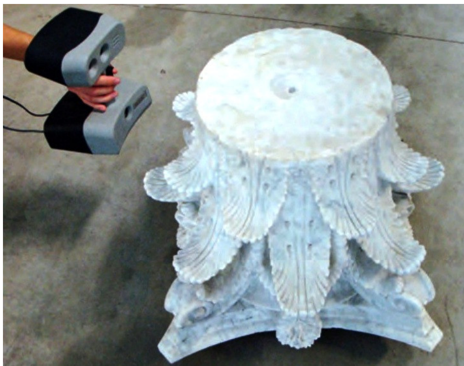
Slika 23. Skeniranje kapitela kamenog stupa [4]
