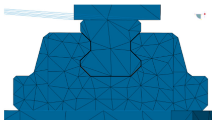
Slika 36. Mreža konačnih elemenata – detalj kotrljajućeg bloka
