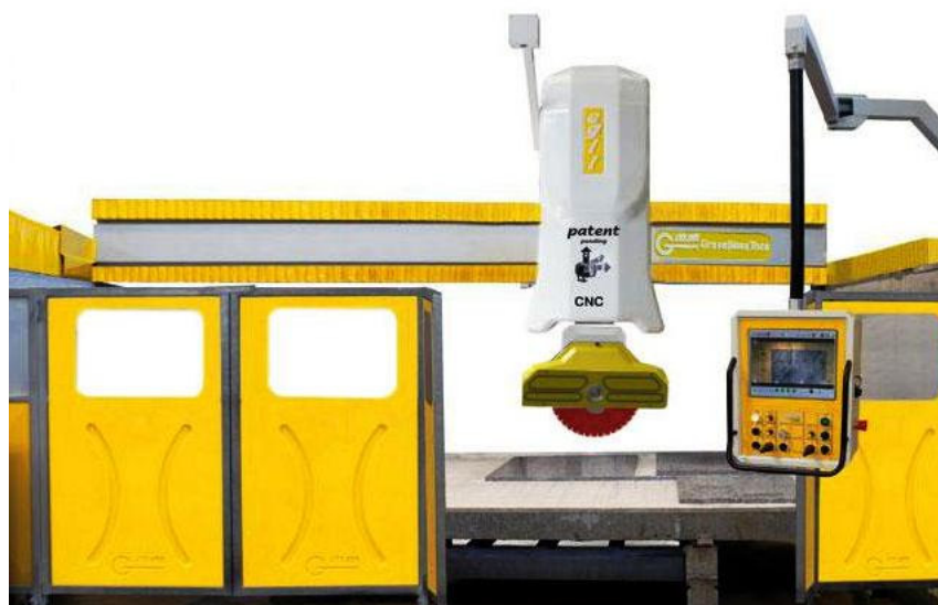
Slika 12. Numerički upravljani portalni stroj za rezanje kamena [4]
