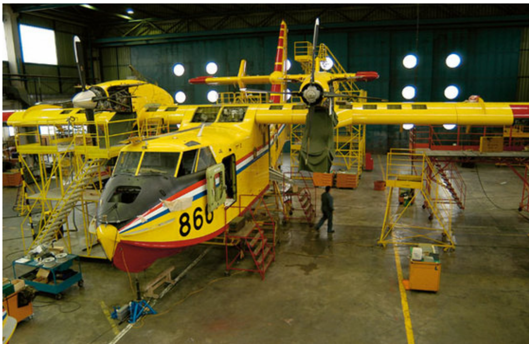
Slika 2. Remont kanadera i pripadajuća oprema
