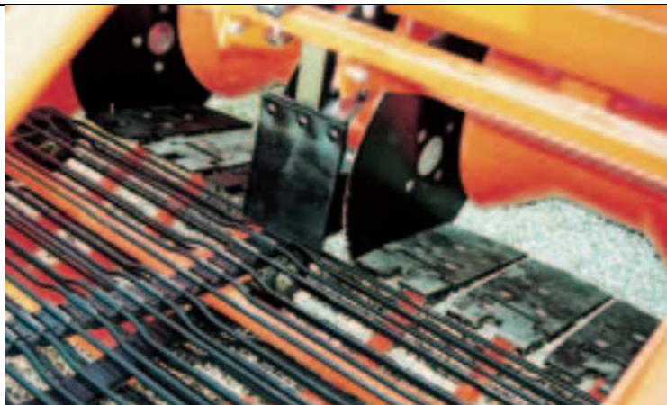
Slika 27 Prikaz prednjeg dijela stroja, dva odjeljka za iskop svaki sa tri noža
