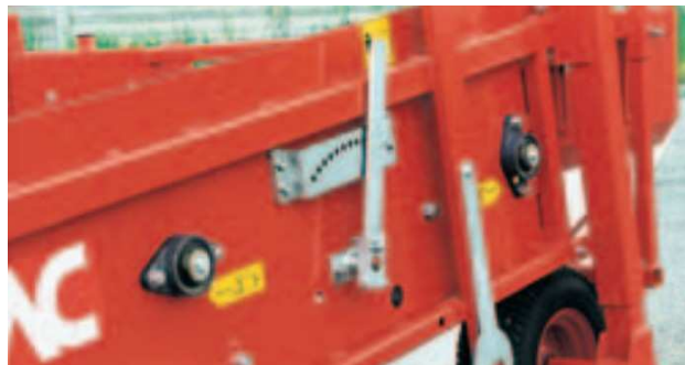
Slika 25 Podešavanje ekscentar osovine
