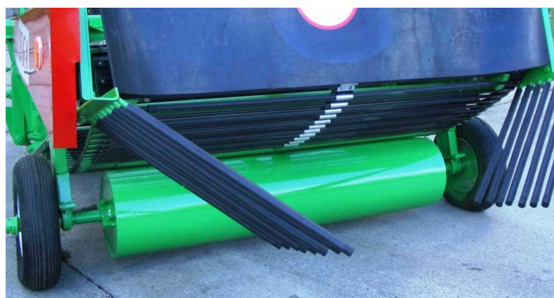
Slika 32 WEGA 1400/1600 gumirane ručice za smanjivanje udarca krumpira u tlo i valjak za zaravnavanje tla
