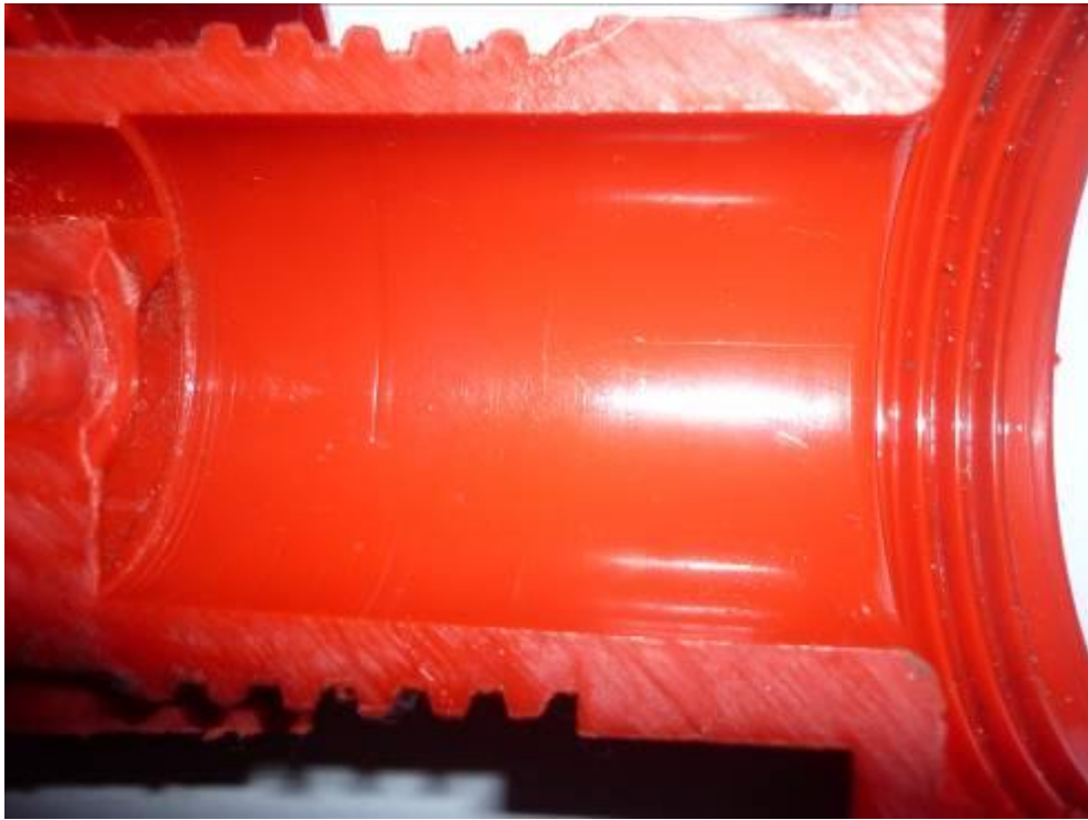
Slika 43. Prikaz trošenja erozijom kapljevine na promatranoj mlaznici od poliamida
