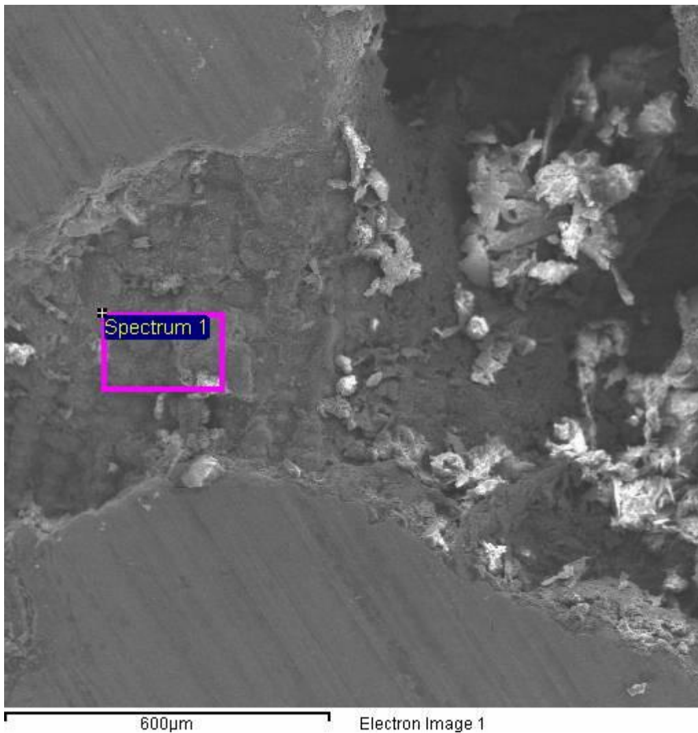
Slika 68. Odabrano područje za određivanje kemijske analize na bakrenom uzorku
