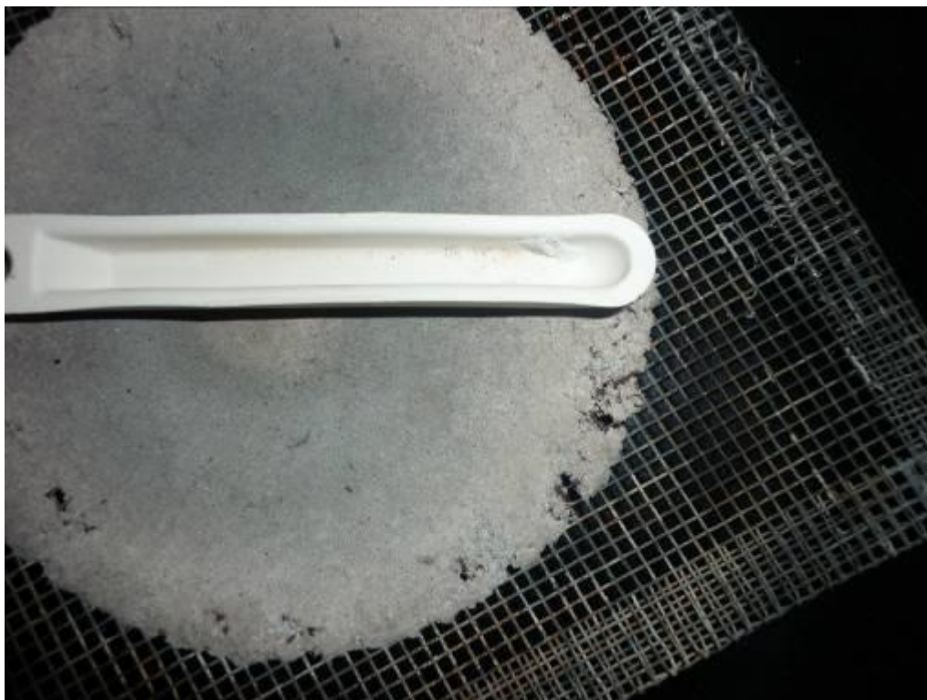
Slika 48. Ostaci ojačala nakon izgaranja
