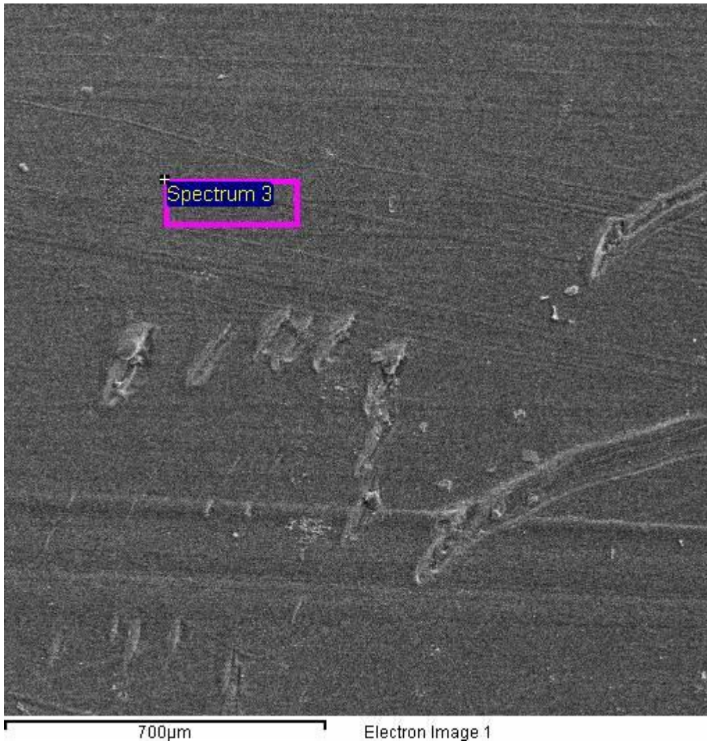
Slika 77. Odabrano područje za određivanje kemijske analize na polikarbonatnom uzorku
