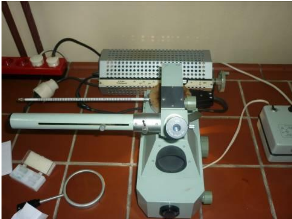
Slika 49. Polarizacijski mikroskop sa grijačima i termometrom
