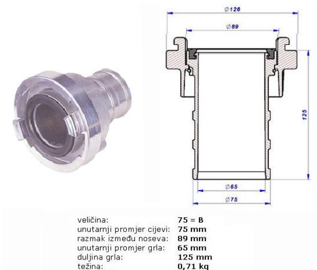
Slika 15. Usisna cijevna spojnica [4]
