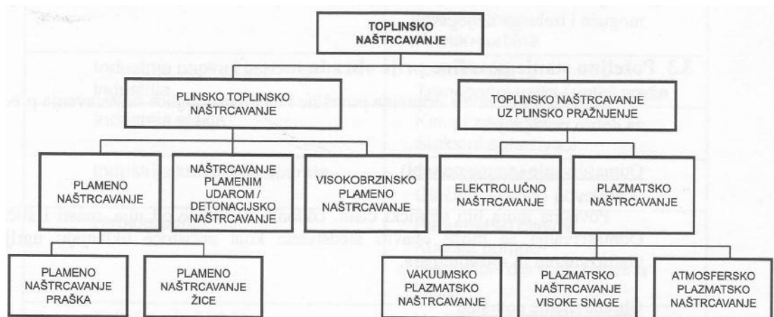
Slika 32. Podjela najvažnijih postupaka naštrcavanja prema vrsti nositelja energije [7]
