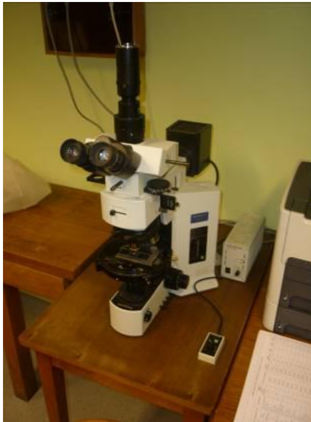
Slika 52. Polarizacijski mikroskop Olympus BX51
