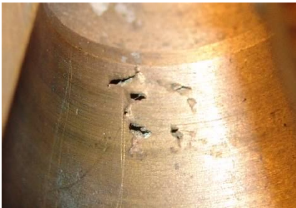
Slika 38. Prikaz erozije udara kapljicama na promatranoj mlaznici od bakrene legure
