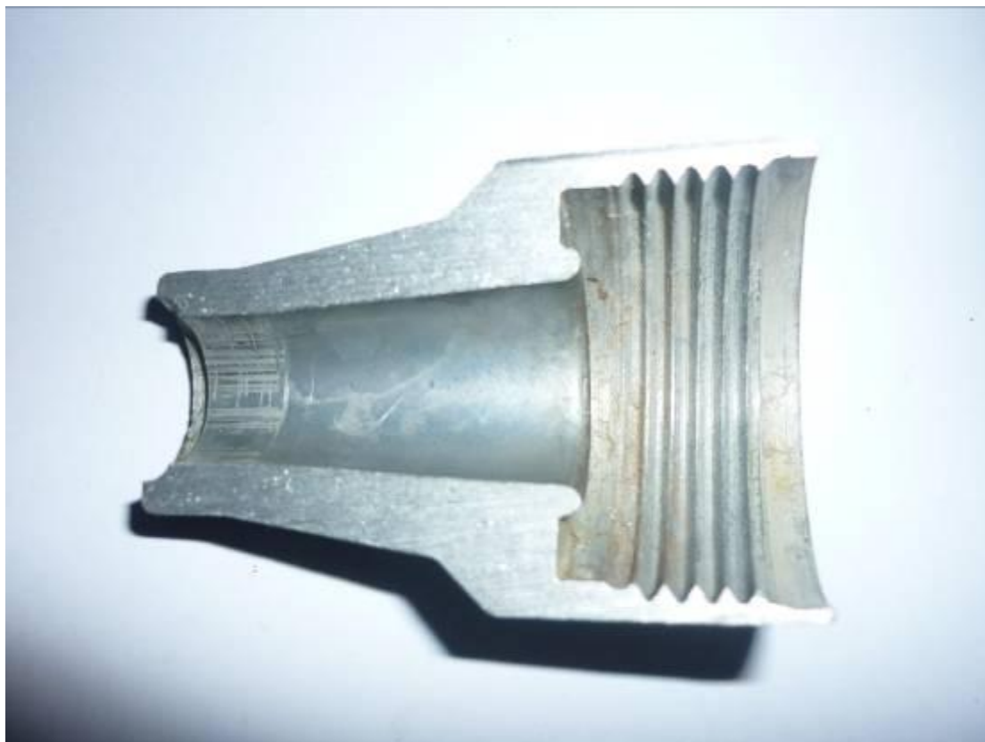
Slika 40. Prikaz erozije kapljevnom na usnacu aluminijske mlaznice
