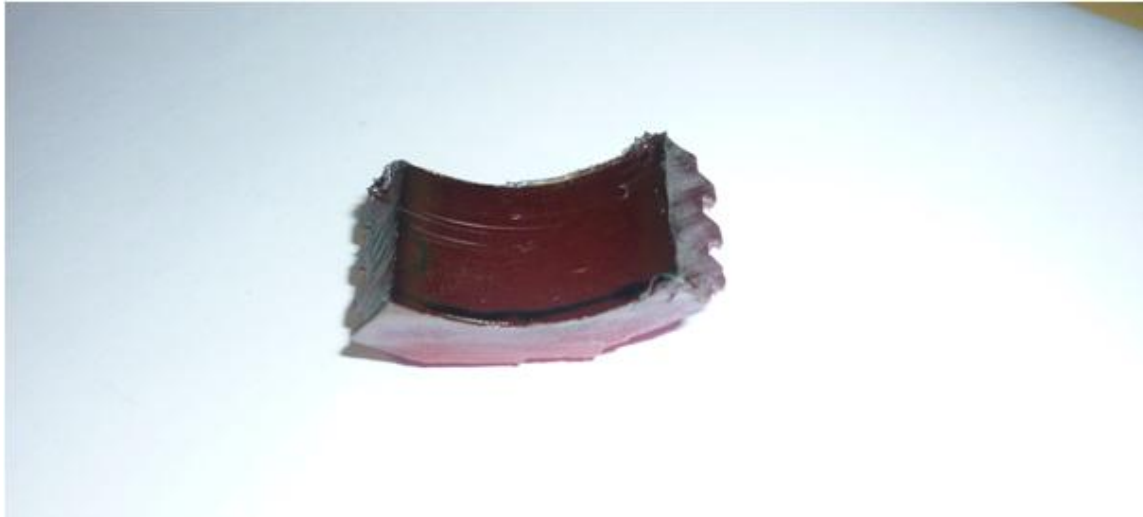
Slika 73. Uzorak od polikarbonata nakon naparivanja
