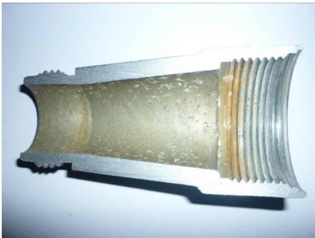
Slika 41. Prikaz erozije kapljevnom na nastavku aluminijske mlaznice
