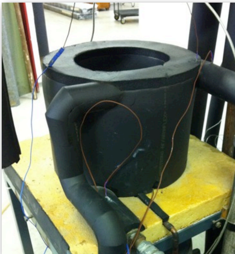
Slika 5. Vodom hlađen kondenzator
