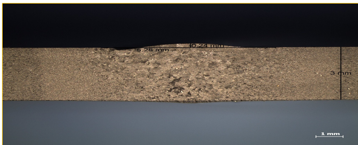
Slika 27. Uvećani prikaz presjeka, prolaz 2, lim "C"
