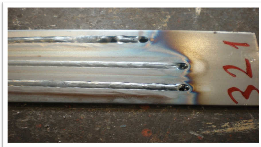
Slika 25. Prikaz ploče "C" sa sva tri prolaza
