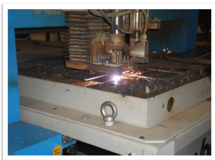
Slika 18. Rezanje ispitnih uzoraka na Vanad-u 2000
