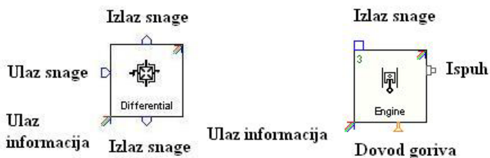
Slika 2.17.. Primjeri veza na komponentama [5]
