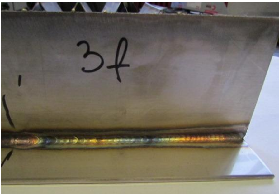
Slika 29. Uzorci zavarivanja T-spoja 3e i 3f, kontinuiranim i impulsnim strujama pod zaštitnom atmosferom argona
