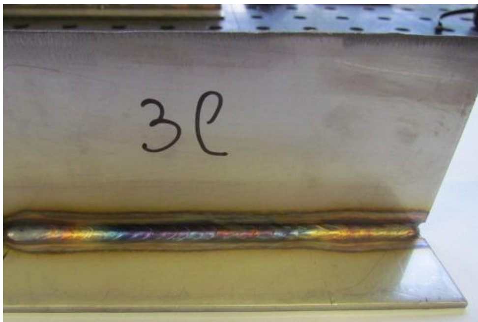
Slika 30. Uzorci zavarivanja T-spoja 3k i 3l, kontinuiranim i impulsnim strujama pod zaštitnom atmosferom mješavine argona i 5% vodika
