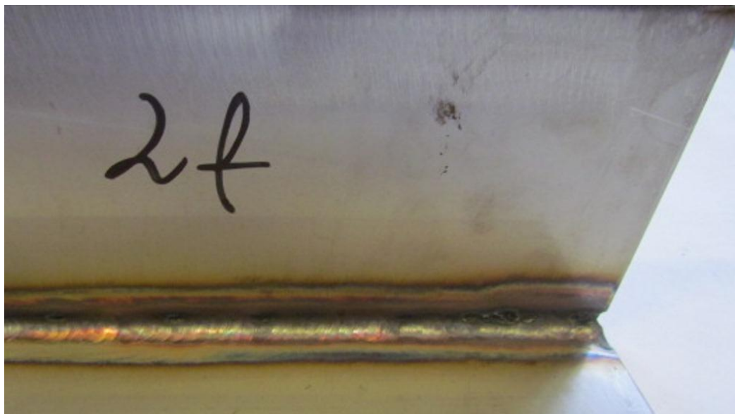
Slika 23. Uzorci zavarivanja T-spoja 2e i 2f, kontinuiranim i impulsnim strujama pod zaštitnom atmosferom argona
