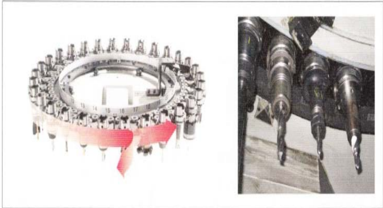
Slika 3.16. Kružno spremište alata [12]
