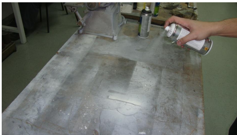
Slika 6.16 Priprema stohastičnog uzorka na epruveti
