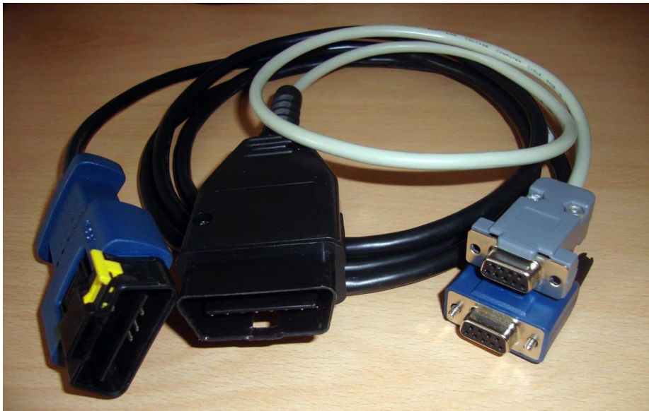
Slika 5.4. EOBD – DB9 kabele korišteni za spajanje uređaja NI USB-8473s i vozila. Razlika je u EOBD konektorima, plavi ima plastiku za osiguranje protiv ispadanja.
