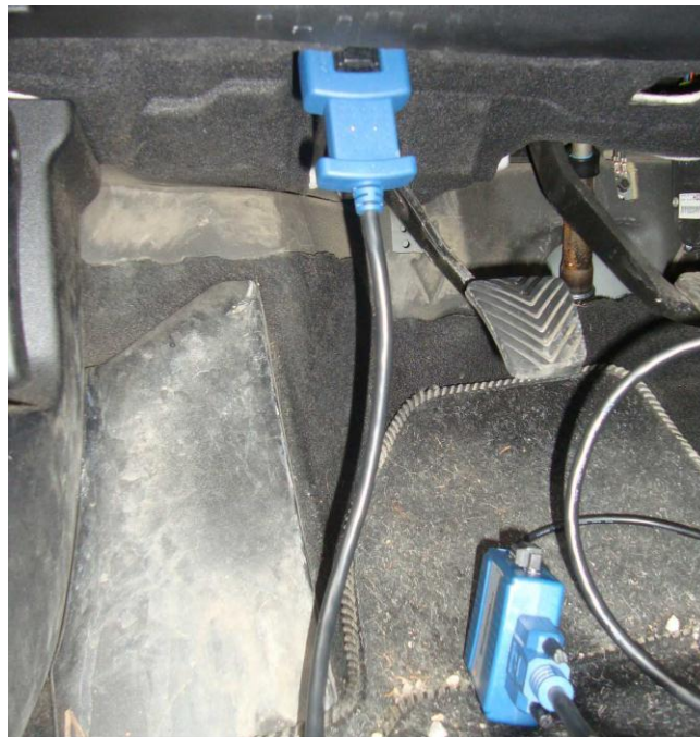
Slika 5.12. Lokacija dijagnostičkog priključka na vozilu Kia Cee'd.
