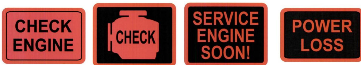
Slika 2.1. Mogući izgledi OBD-I kontrolne žaruljice, MIL [1].
