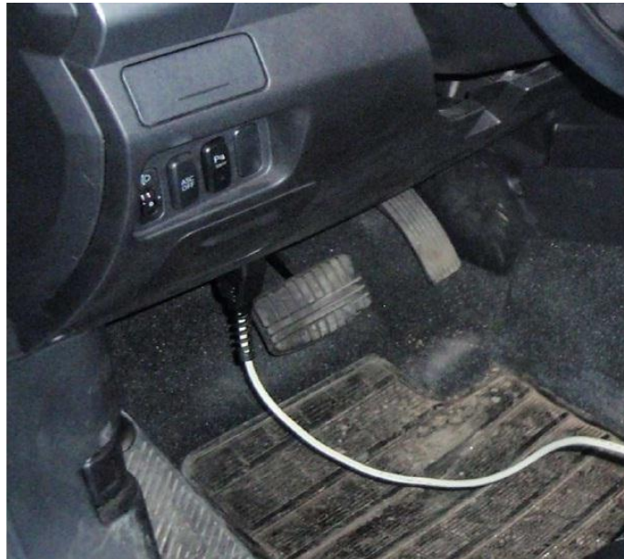
Slika 5.15. Lokacija dijagnostičkog priključka na vozilu Citroen C-Crosser.
