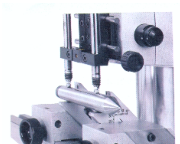
Slika 4.20. Provjera kružnosti konusa šiljka konjića induktivnim uređajem
