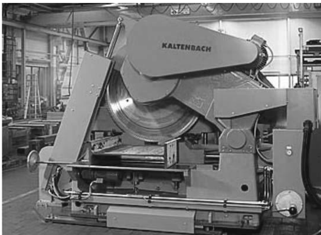
Slika 27. Kružno piljenje zakretanjem [14]
