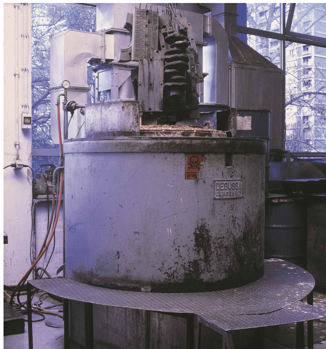
Slika 44. Solna kupka u kojoj je proveden TENIFER postupak nitrokarburiranja
