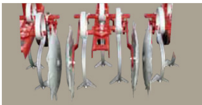
Slika 8. Modeli kultivatora s 3 motičice po redu (VCO-3)
