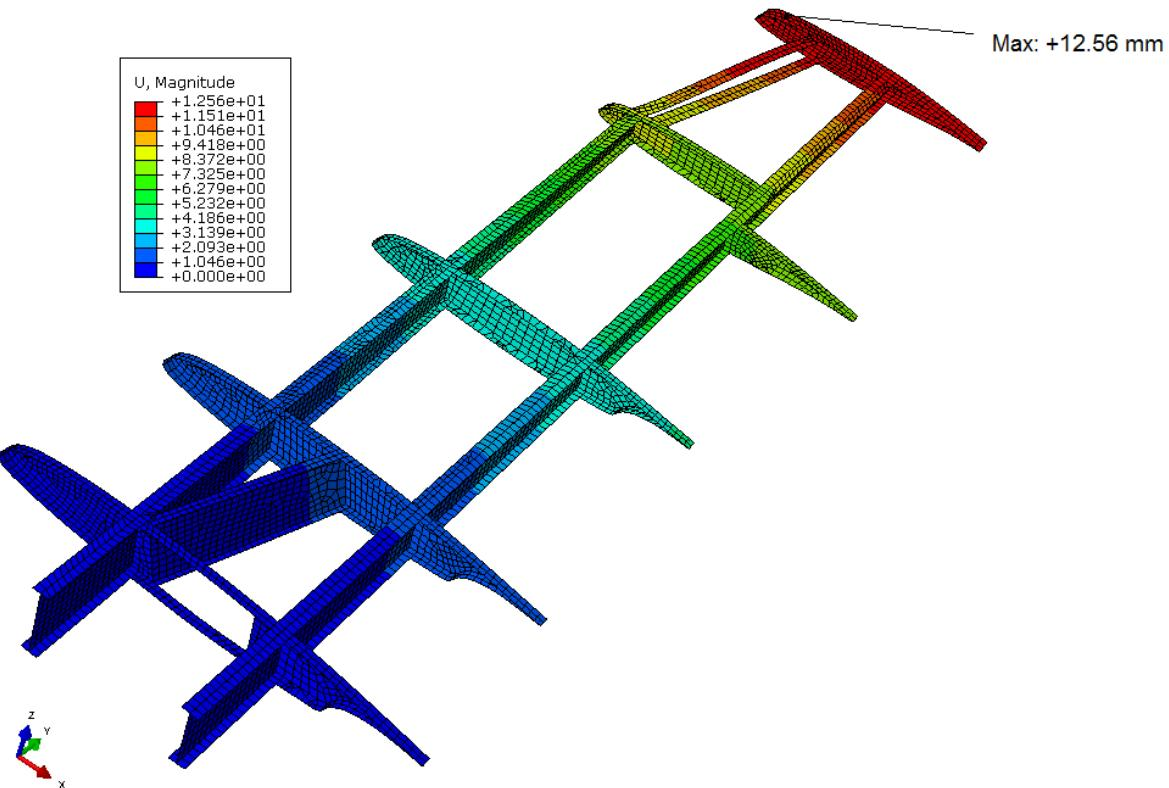
**Slika 7-4 Raspodjela pomaka [mm] na klasičnoj konstrukciji bez oplate**
