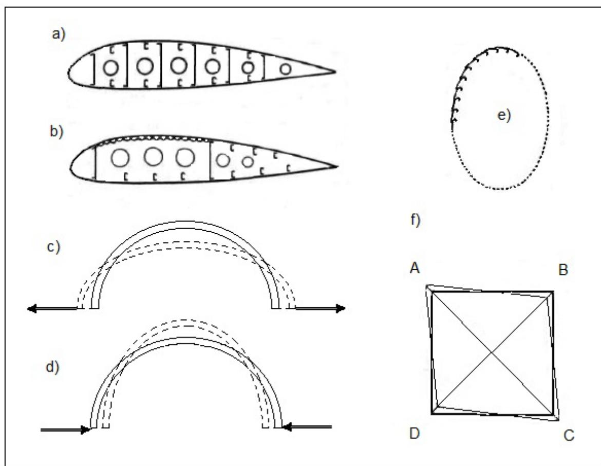
**Slika 2-3 a)** Presjek krila s više ramenjača i uzdužnicima; **b)** Gornjaka ukrućena korugiranim limom; **c)** Ponašanje zakrivljene letvice pod opterećenjem na vlak ; **d)** Ponašanje zakrivljene letvice pod opterećenjem na tlak; **e)** Trup izведен spajanjem panela s integriranim uzdužnicama; **f)** Pravokutni okvir pod djelovanjem torzijskog opterećenja[6];
