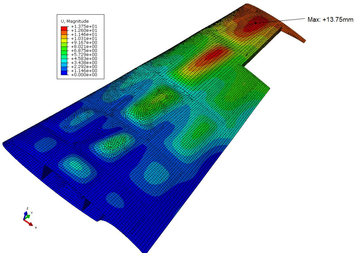
Slika 7-3 Raspodjela pomaka [mm] na klasičnoj konstrukciji
