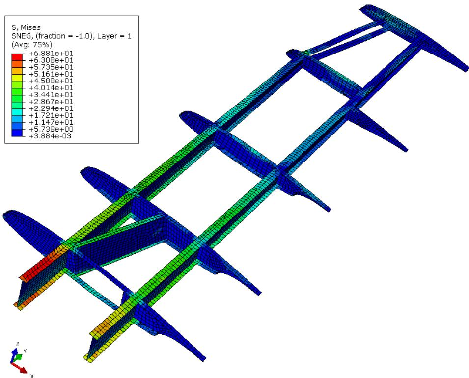
Slika 7-2 Raspodjela ekvivalentnog naprezanja [MPa] i izgled deformiranog modela krila bez oplate (klasična konstrukcija)
