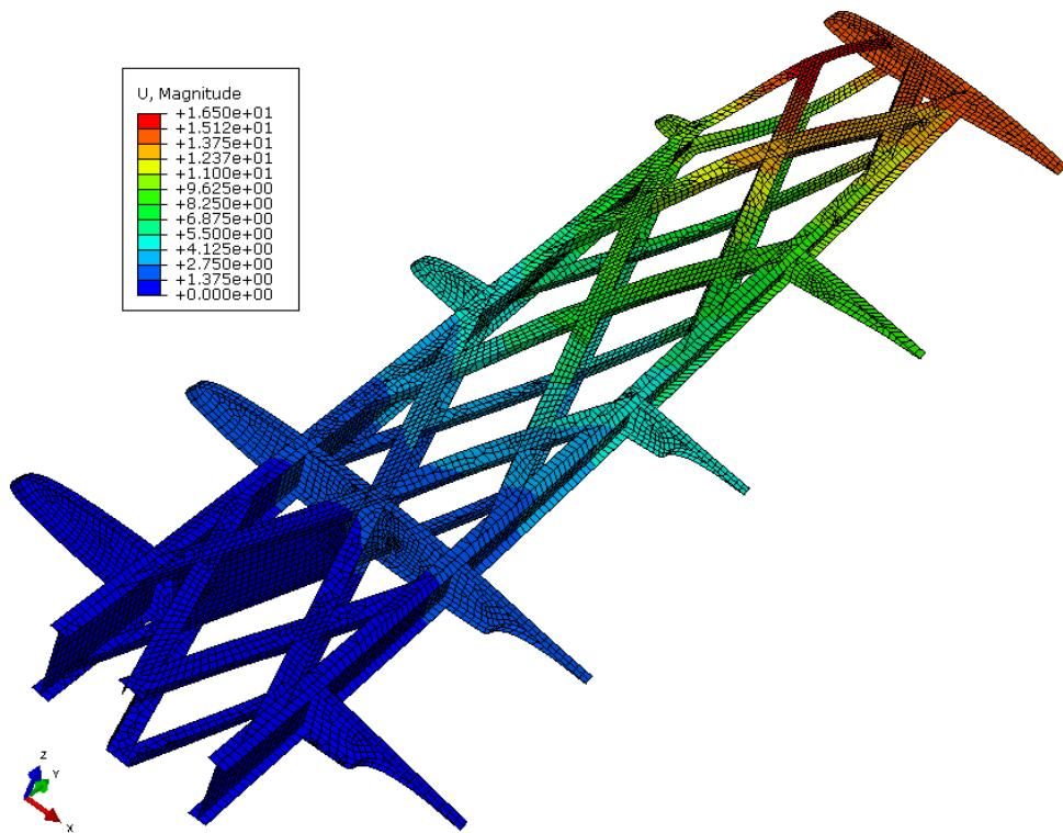
Slika 7-9 Raspodjela pomaka [mm] na geodetskoj konstrukciji bez oplate (vlakna geo. elemenata pod  $30^\circ$ )
