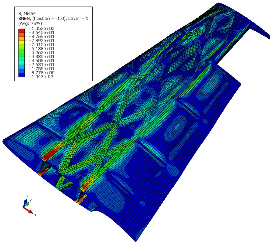
**Slika 7-10 Raspodjela ekvivalentnog naprezanja [MPa] i izgled deformiranog modela krila
