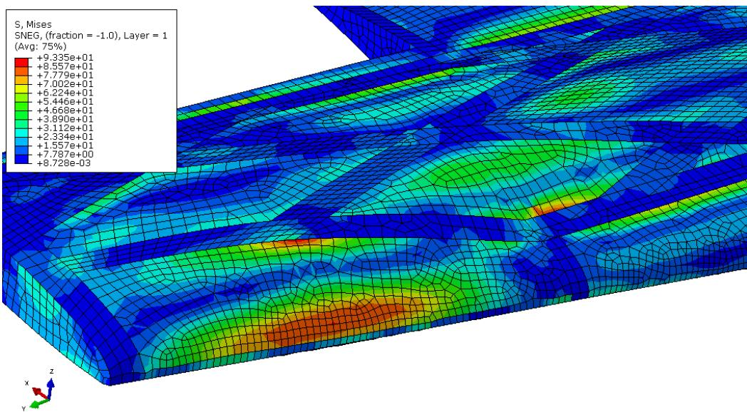
**Slika 7-7 Uvećani prikaz mesta najvećeg ekvivalentnog naprezanja [MPa] kod geodetske konstrukcija krila (vlakna geo. elemenata pod 30°)**
