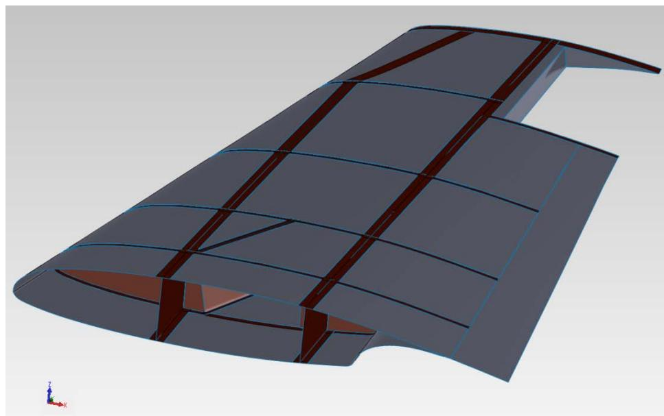
Slika 4-1 Model klasične konstrukcije krila lakoog zrakoplova, modeliran u SOLIDWORKS-u
