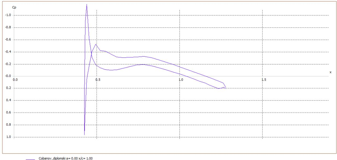
Slika 5-3 Dijagram  $c_p$ -x za vršni presjek krila
