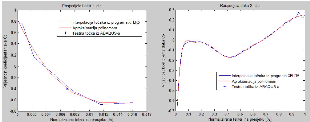
**Slika 5-10 Poklapanje vrijednosti dodijeljenog opterećenja sa izvornom funkcijom dobivenom u MATLAB-u**
