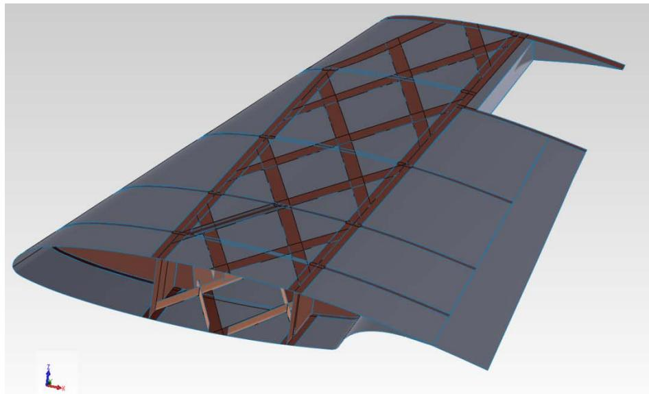
**Slika 4-2 Model krila sa geodetskom konstrukcijom, modeliran u SOLIDWORKS-u**
