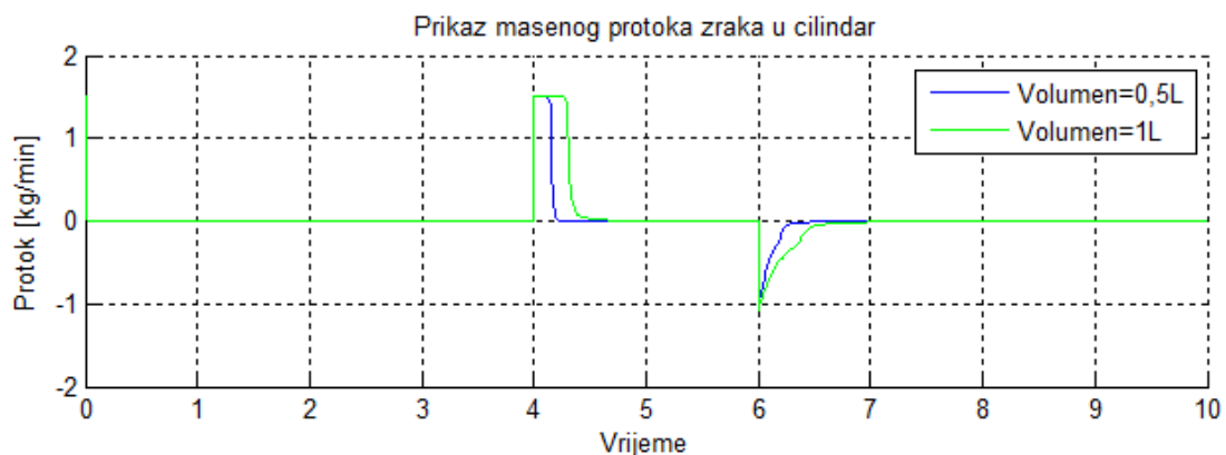
Slika 48 Protok zraka kroz ventil/cilindar
