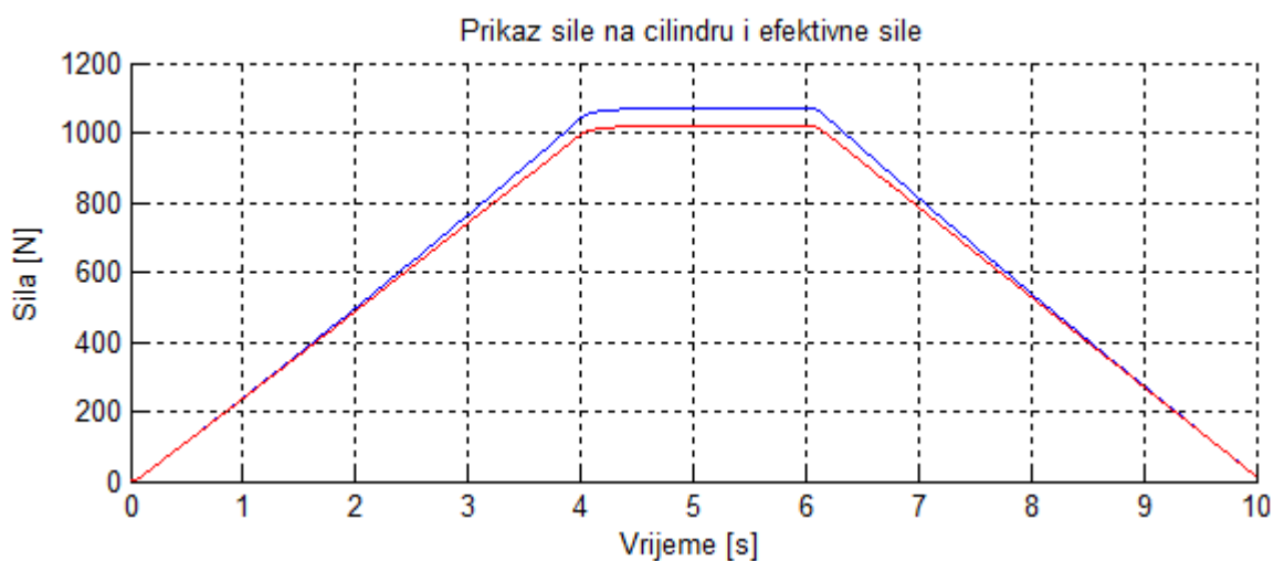
Slika 65 Prikaz sile u cilindru i efektivne sile na polugu
