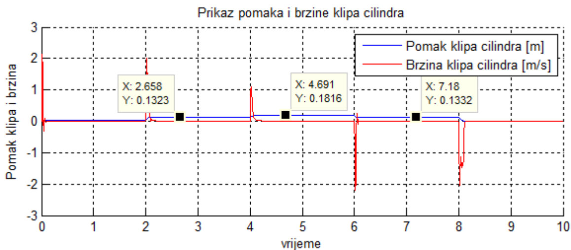
Slika 55 Odziv pomaka i brzine klipa cilindra
