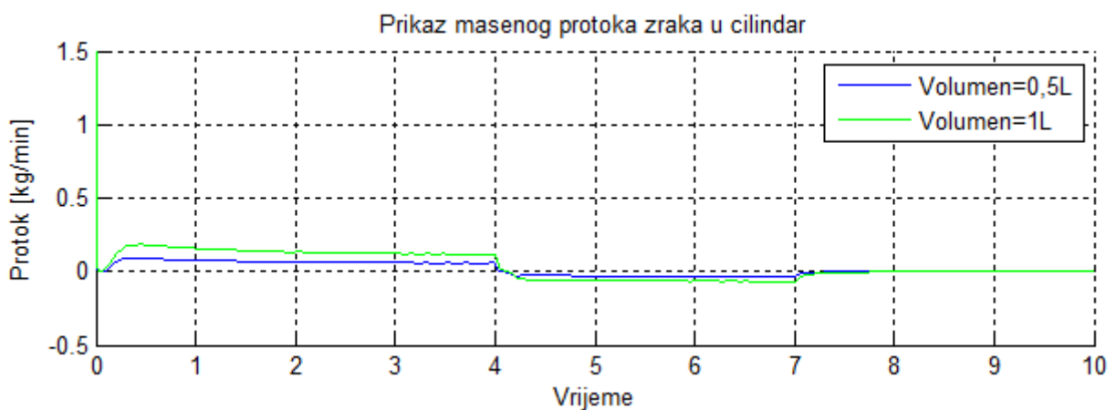
Slika 46 Protok zraka kroz ventil/cilindar
