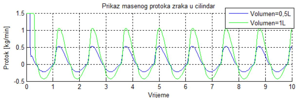
Slika 44 Protok zraka kroz ventil/cilindar
