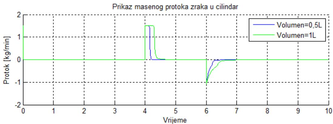
Slika 48 Protok zraka kroz ventil/cilindar
