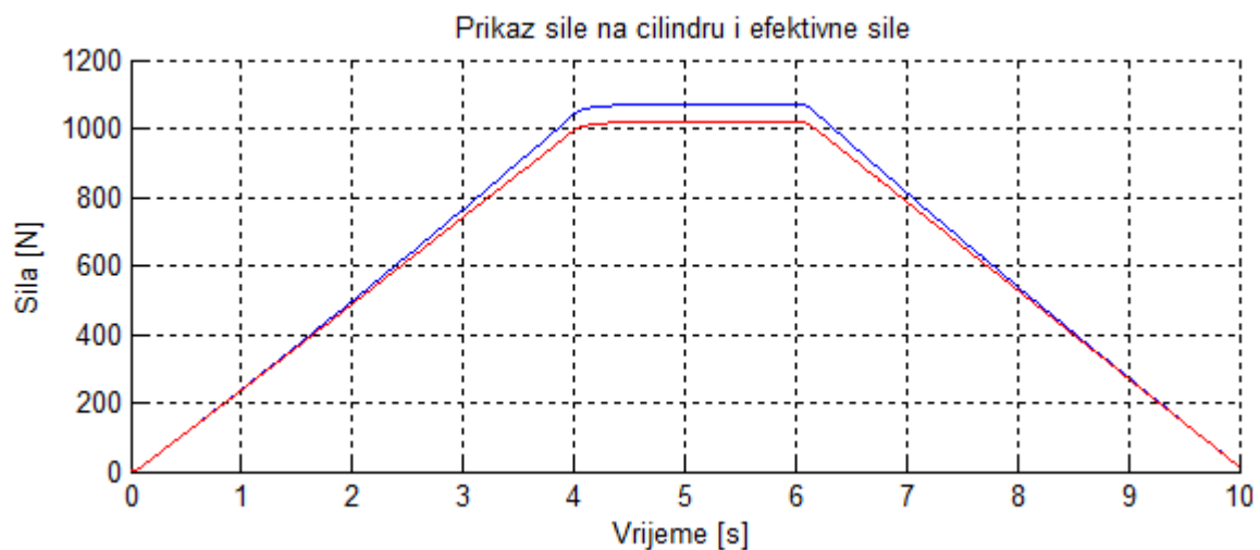
Slika 65 Prikaz sile u cilindru i efektivne sile na polugu
