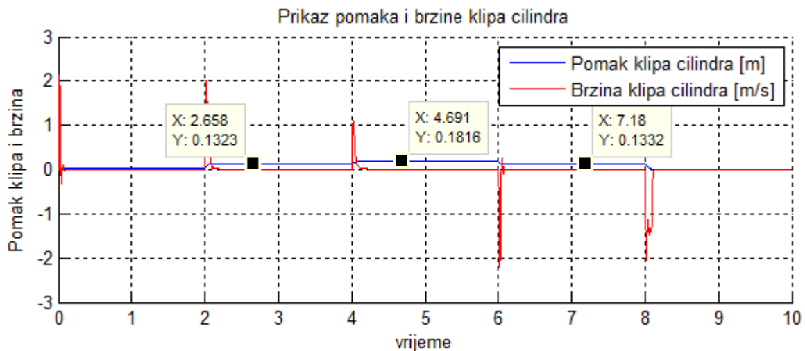
Slika 55 Odziv pomaka i brzine klipa cilindra
