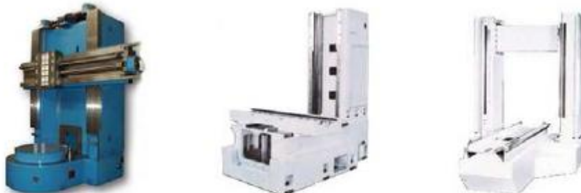
Slika 2. Noseći sustav alatnog stroja [2]
