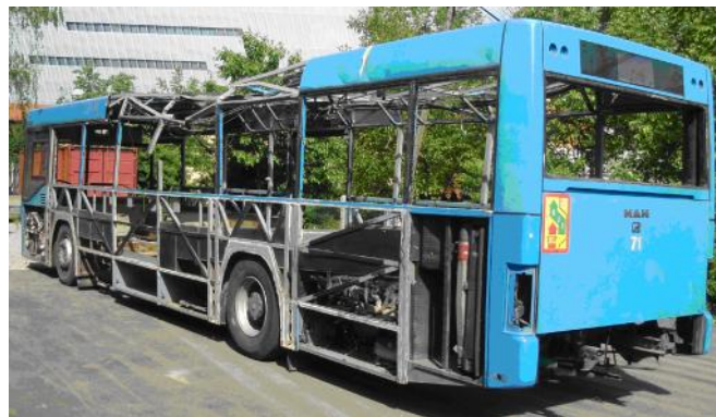
Slika 6.1. Prikaz oštećenja autobusa s lijeve strane
