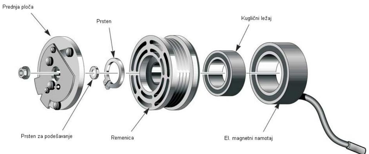
**Slika 6.** Mehanički pogon kompresora
