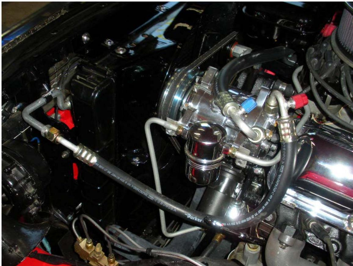
Slika 27. Prikaz spajanja komponenata rashladnog uređaja sa crijevima (preko spojnica)
