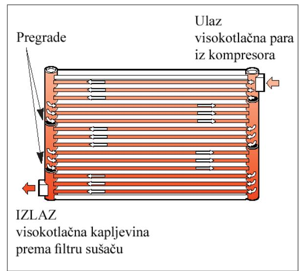
Slika 11. Izvedbe kondenzatora
