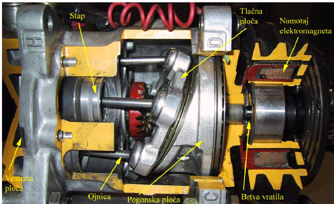
Slika 8. Kompresor sa tlačnom rotacionom pločom (jednostrano montirani stапovi)
