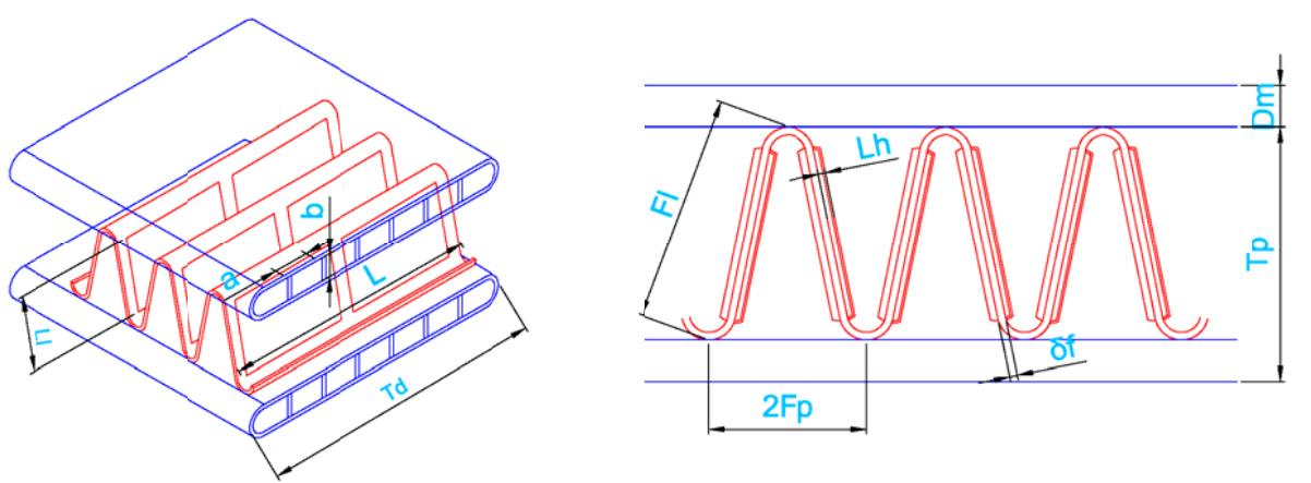
Slika 21. Prikaz detalja konstrukcije kondenzatora
