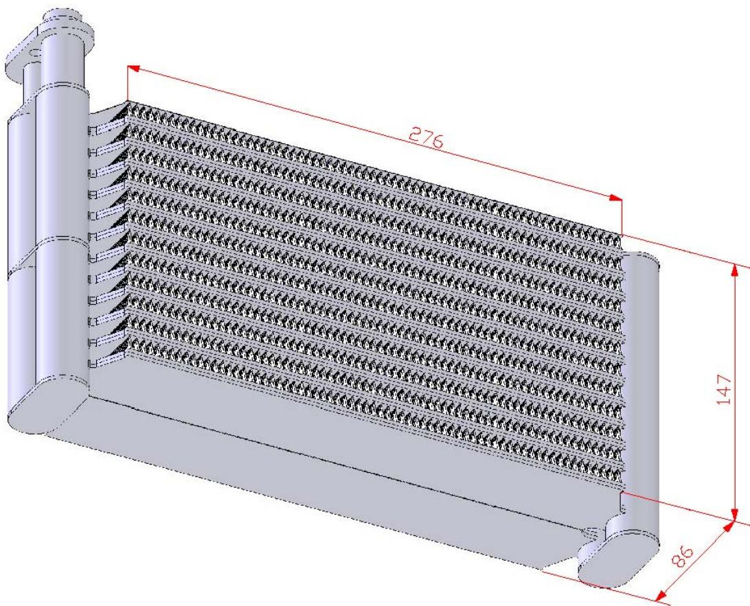
**Slika 25.** Dimenzije proračunatog pločastog isparivača sa lamelama
