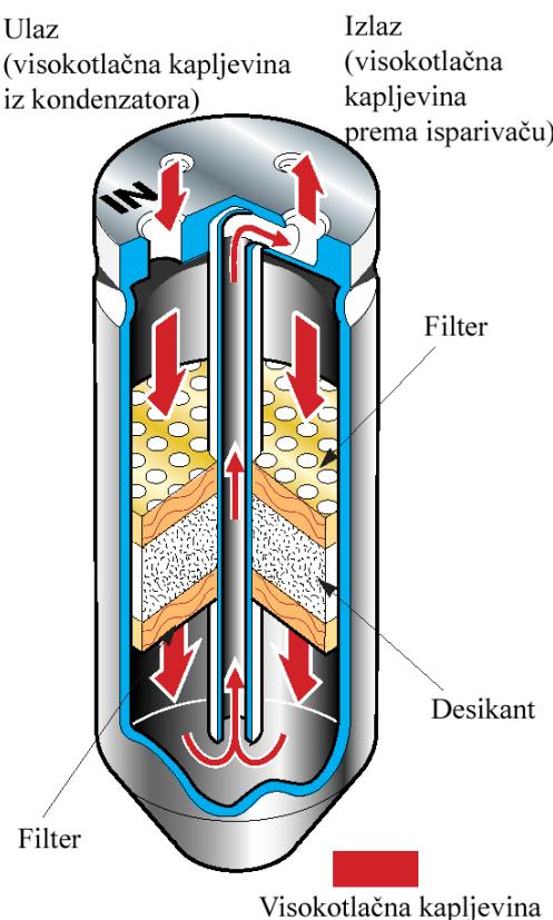
**Slika 13.** Sakupljač radne tvari sa filter sušačem
