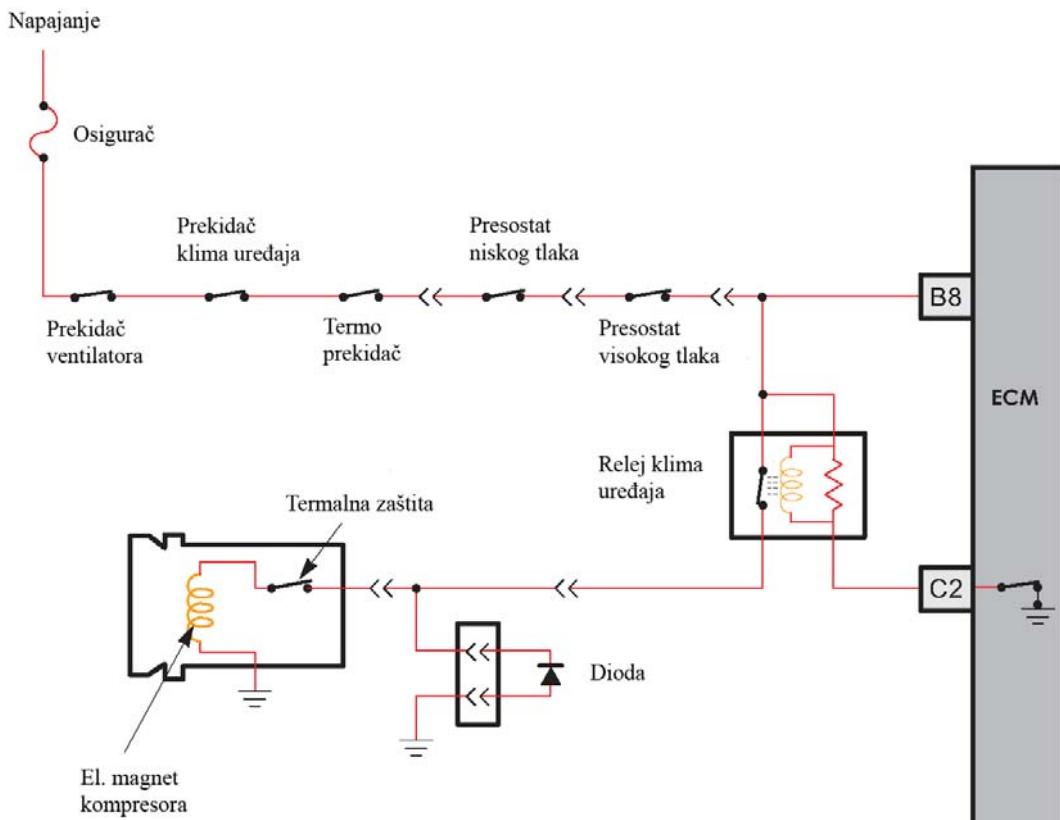
**Slika 3.** Shema strujnog kruga elektromagnetske sklopke kompresora
