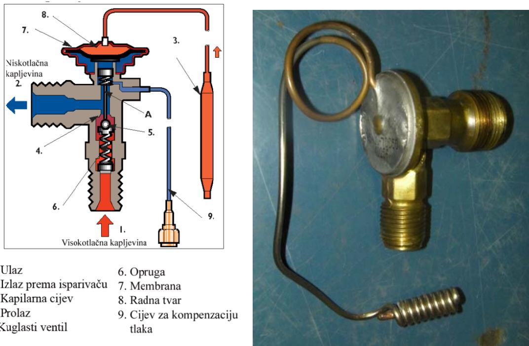
Slika 16. Termoekspanzijski ventil s vanjskim izjednačavanjem tlaka (presjek i fotografija)
