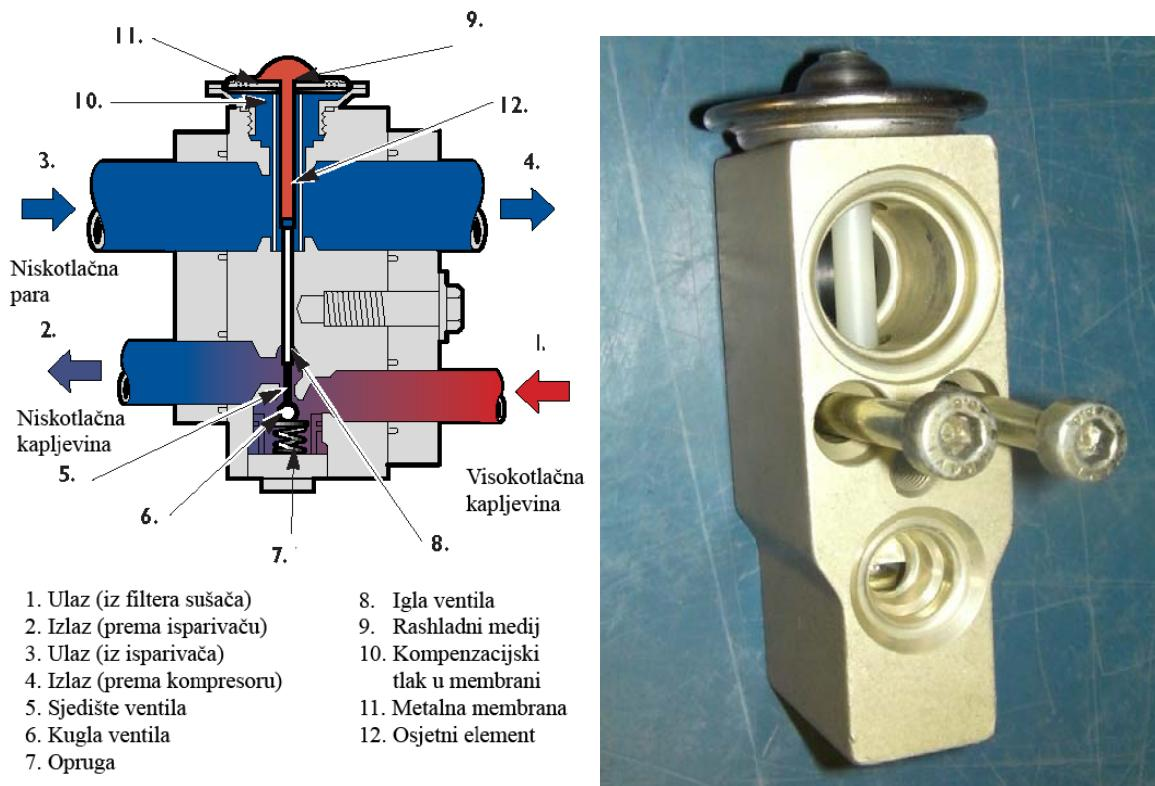
Slika 15. Termoekspanzijski blok ventil (presjek i fotografija)
