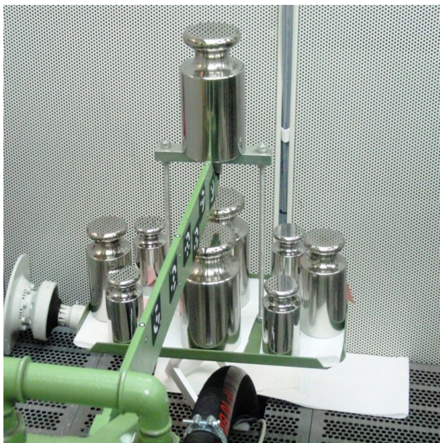
Slika 6.8. Postupak umjeravanja momenta utezima
